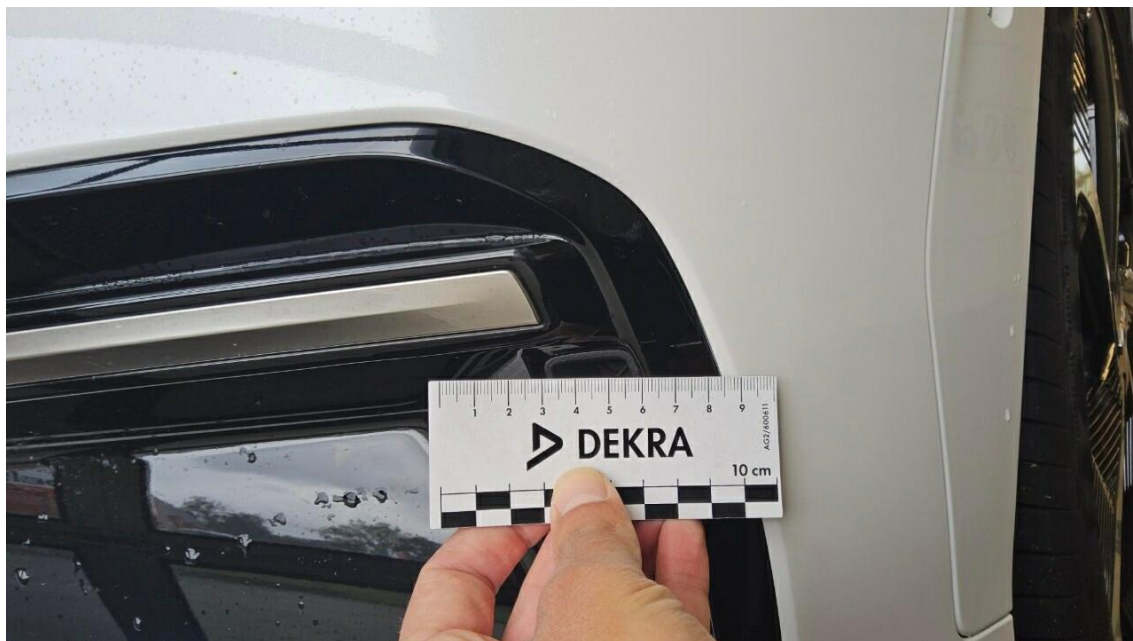
Bild 23 : Stoßfänger vorne Rammschutzleiste links Lackierung, zerkratzt, Gebrauchsspur
