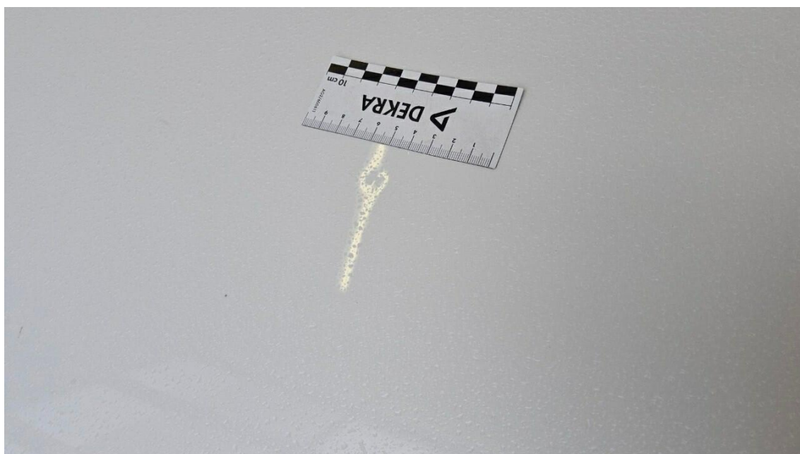
Bild 10 : Motorhaube, eingedellt, drücken
