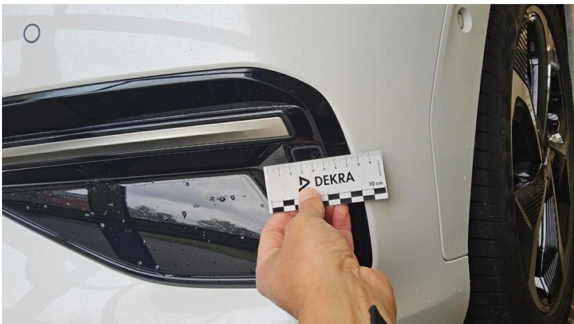
Bild 22 : Stoßfänger vorne Rammschutzleiste links Lackierung, zerkratzt, Gebrauchsspur
