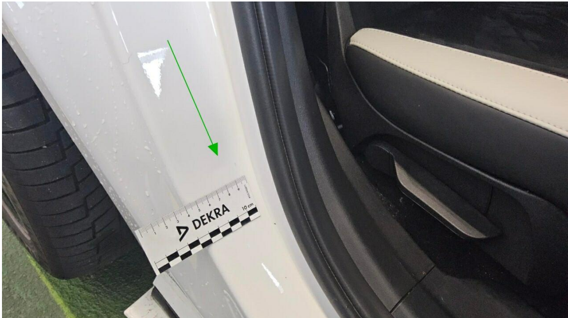
Bild 11 : Tür hinten rechts Einstieg, eingedellt, drücken
