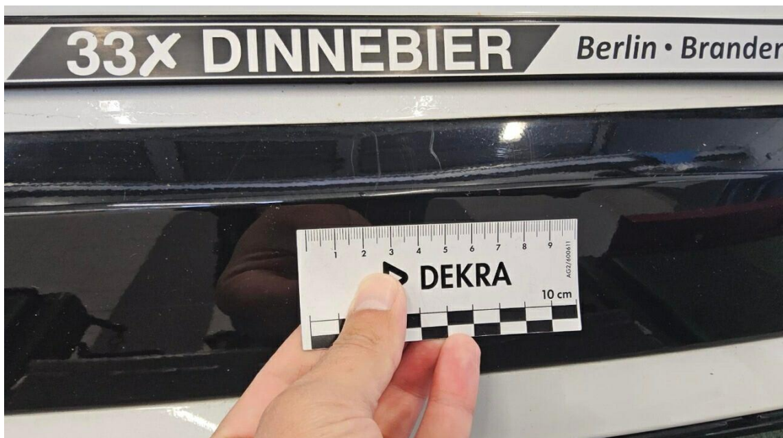
Bild 16 : Heckschürze hinten unten Lackierung, verschrammt, Gebrauchsspur
