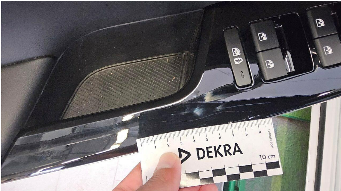
Bild 25 : Interieurleiste Türverkleidung vorne links, verkratzt
