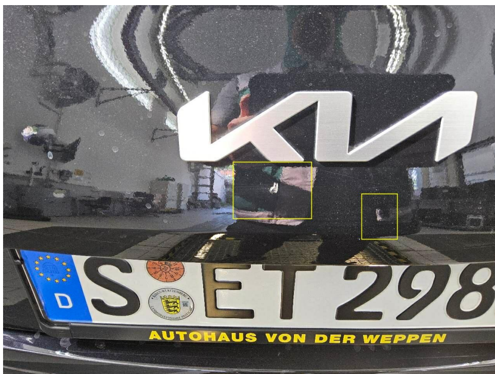
Bild 10 : Heckklappe Blende, zerkratzt
