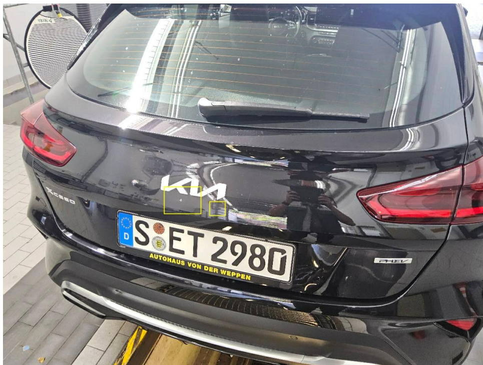
Bild 9 : Heckklappe Blende, zerkratzt
