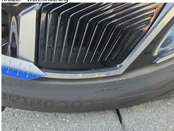
Beschädigung #1: Rad/Reifen: Leichtmetallfelge hinten rechts - Kratzer - Wertminderung
