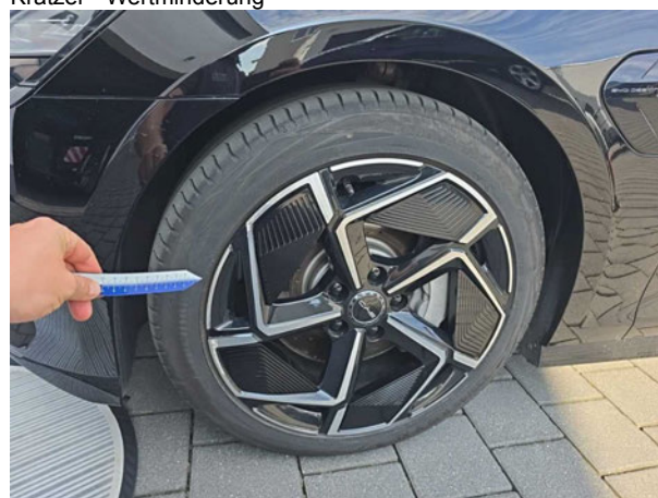
Beschädigung #2: Rad/Reifen: Leichtmetallfelge vorn links - verkratzt / verschürft - erneuern
