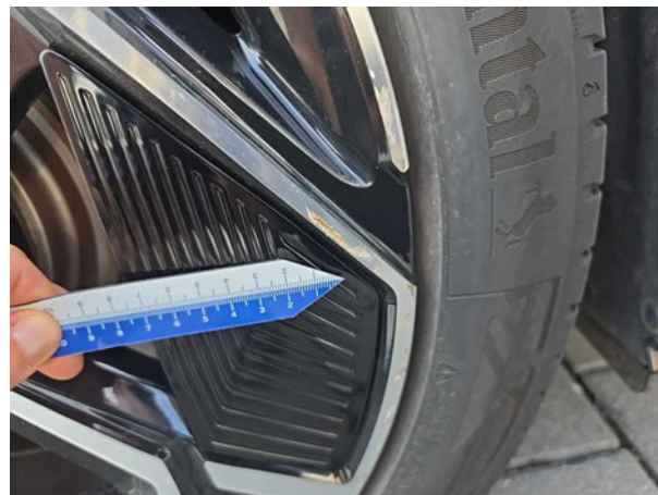
Beschädigung #1: Rad/Reifen: Leichtmetallfelge hinten rechts - Kratzer - Wertminderung
