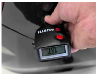
Lackstärke Seitenwand hinten rechts
