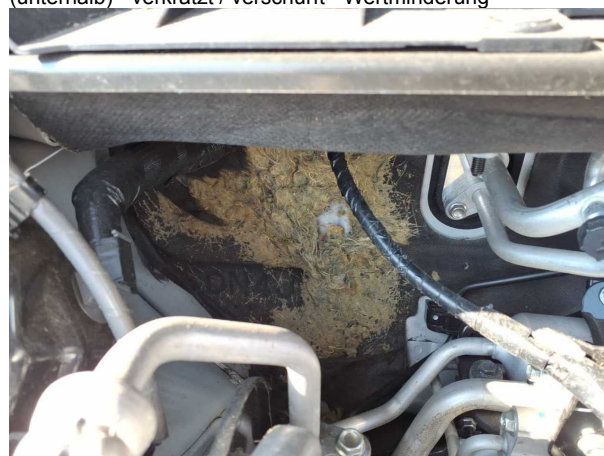
Beschädigung #2: Karosserie: Stirnwandverkleidung - Marderschaden - erneuern
