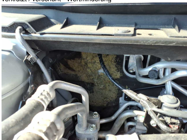
Beschädigung #2: Karosserie: Stirnwandverkleidung - Marderschaden - erneuern
