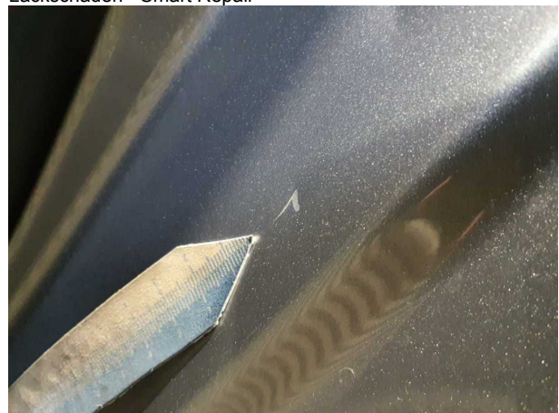
Beschädigung #3: Schweller links: Einstieg (Hi.li) - Delle / Lackschaden - Smart Repair
