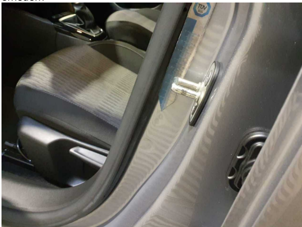
Beschädigung #2: Schweller links: Einstieg (Vo.li) - Delle(n) - sa... instandsetzen
