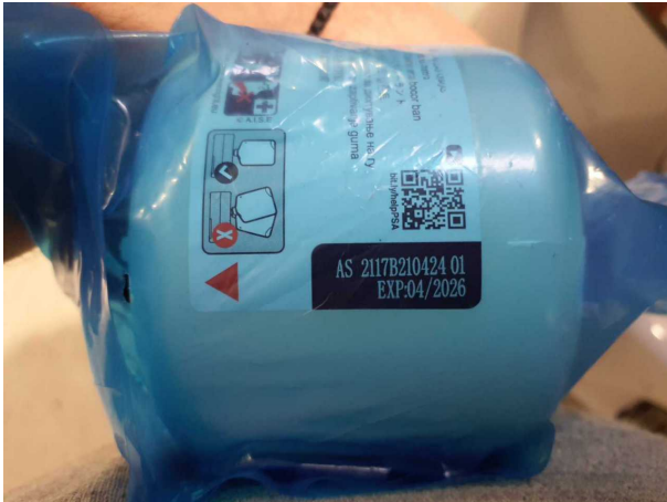
Beschädigung #1: Ausrüstung: Tirefit Füllmittel - abgelaufen - erneuern
