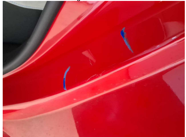
Beschädigung #4: Seitenwand links: Einstieg - verkratzt / verschürft - Smart Repair
