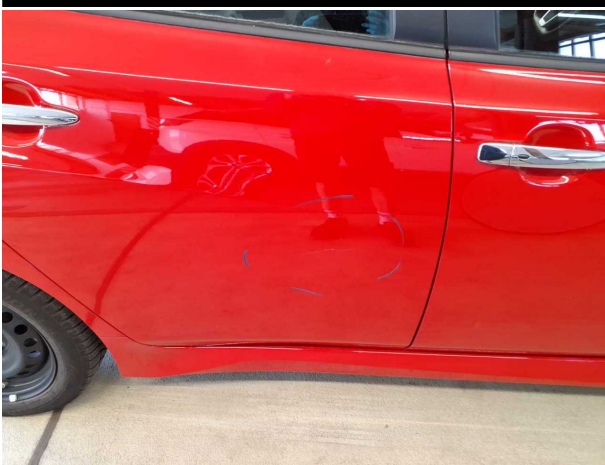
Beschädigung #7: Tür hinten rechts: Tür - verkratzt / verschürft - instandsetzen und lackieren
