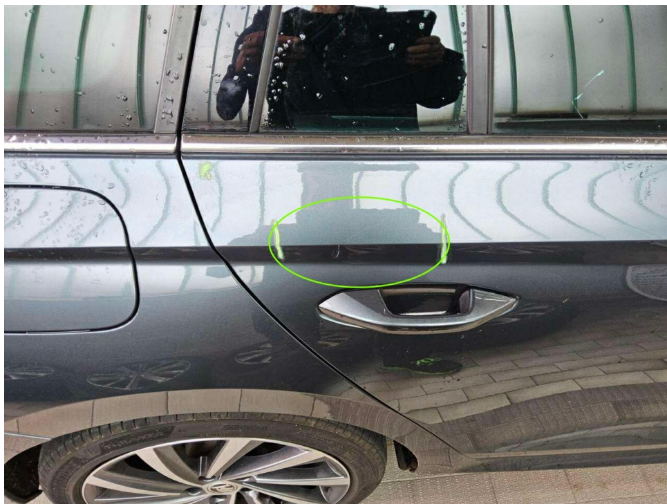
Bild 19 : Tür hinten rechts, verformt, instandsetzen und lackieren mit Lackaufbau
