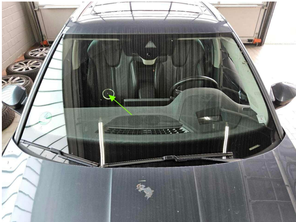
Bild 21 : T- Windschutzscheibe Steinschlag mit Rissbildung
