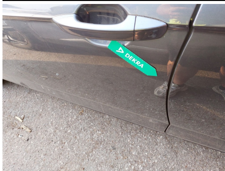
Puerta / Delantero Izquierdo / Abolladura
