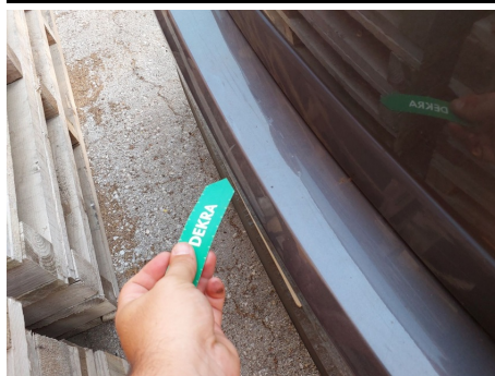
Paragolpes / Trasero / Abolladura
