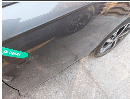
Puerta / Trasero Izquierdo / Abolladura
