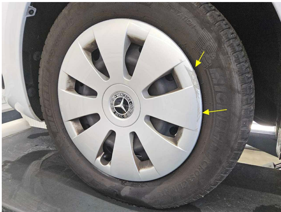
Bild 21 : Radzierblende vorne links verschrammt
