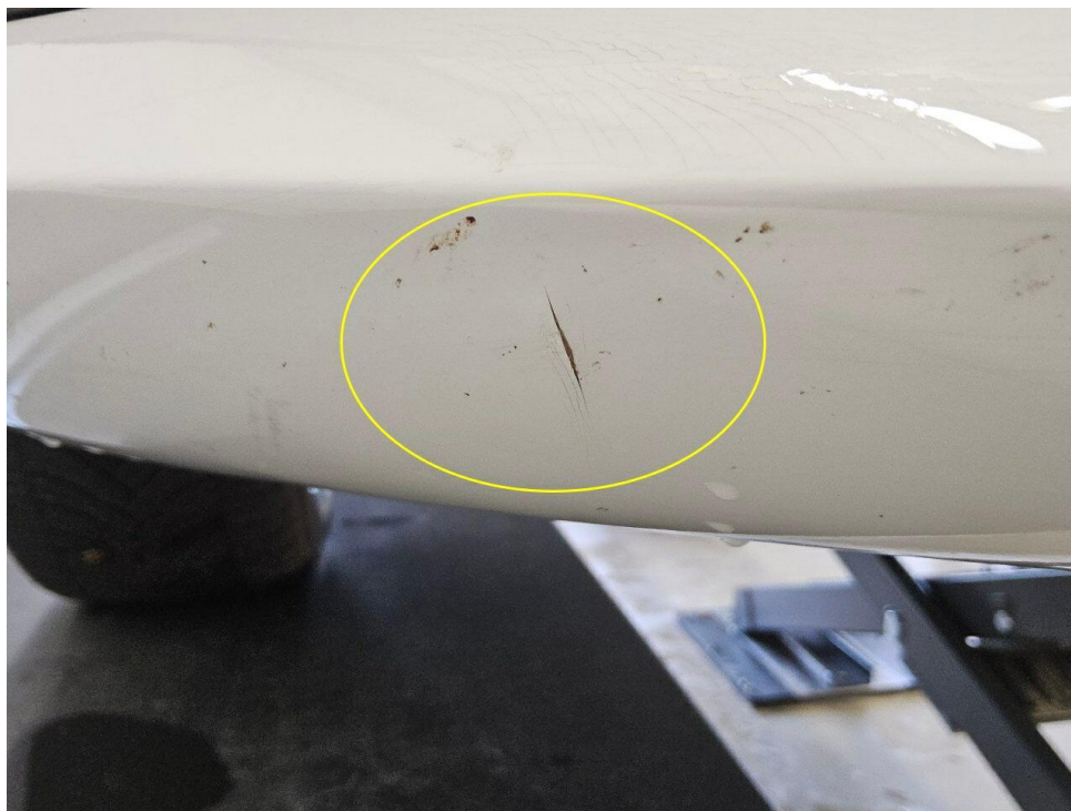
Bild 26 : Frontspoiler Lackierung, gerissen, lackieren mit Lackaufbau
