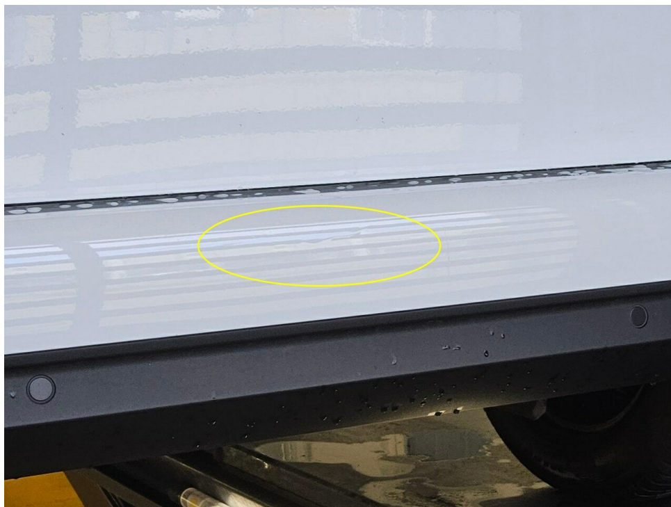
Bild 29 : Stoßfänger hinten mittig defomiert
