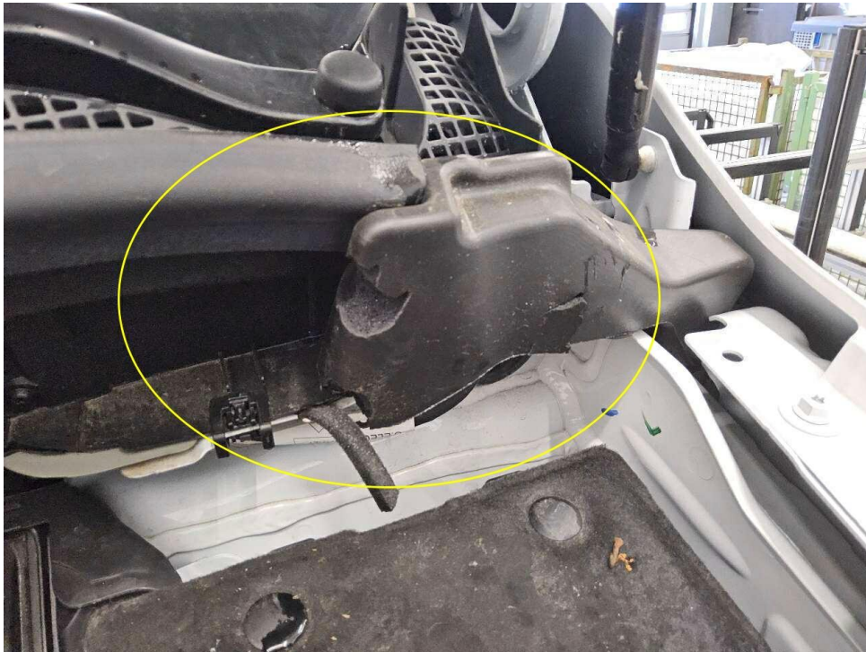
Bild 19 : Motorraumdämmung links Tierverbiss
