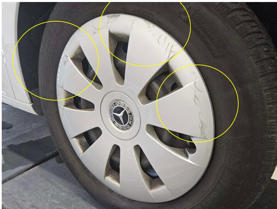
Bild 23 : Radzierblende vorne rechts verschrammt
