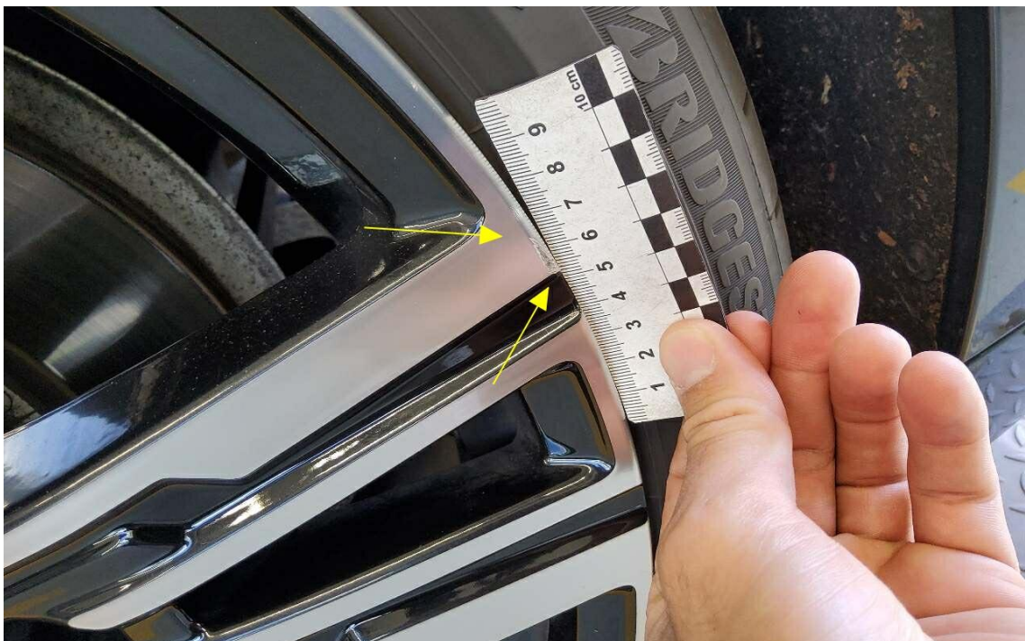
Bild 16 : Glanzgedrehte Sommerfelge hinten links verschrammt
