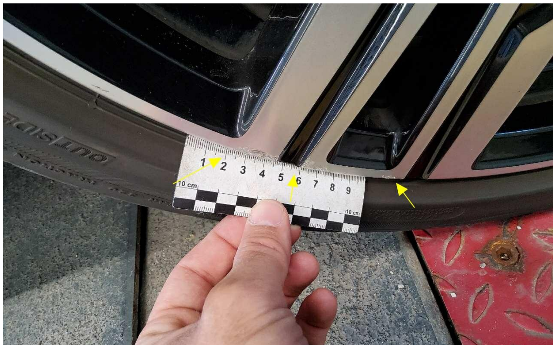
Bild 20 : Glanzgedrehte Sommerfelge vorne rechts verschrammt
