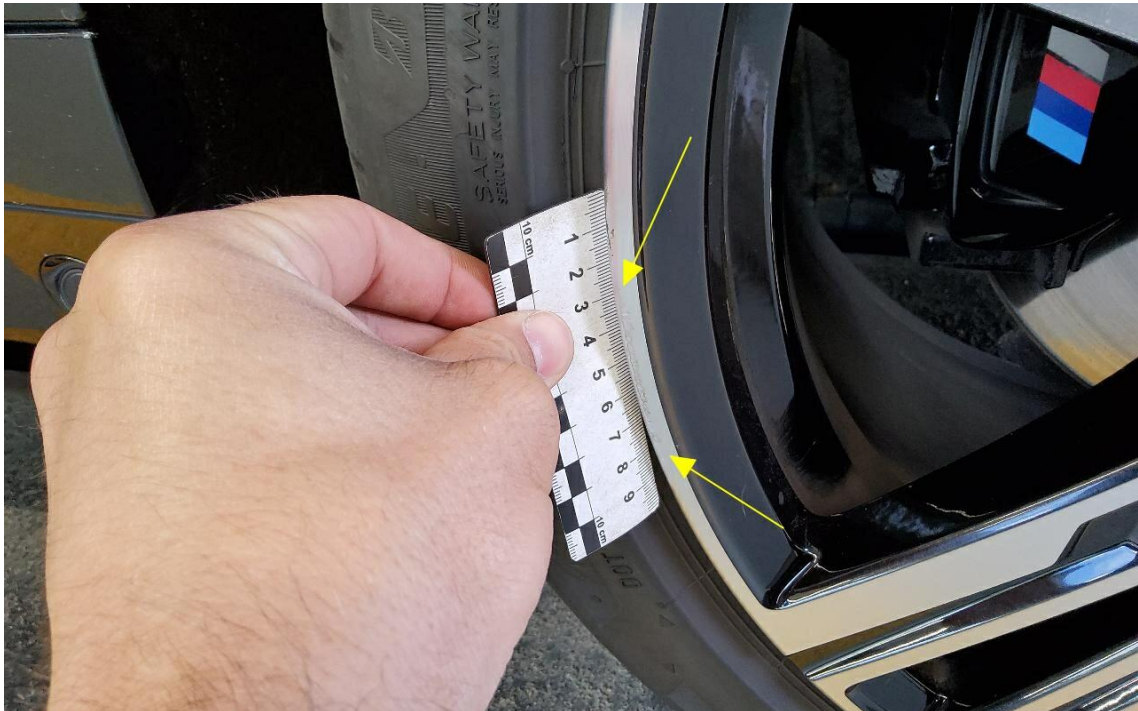
Bild 15 : Glanzgedrehte Sommerfelge hinten links verschrammt
