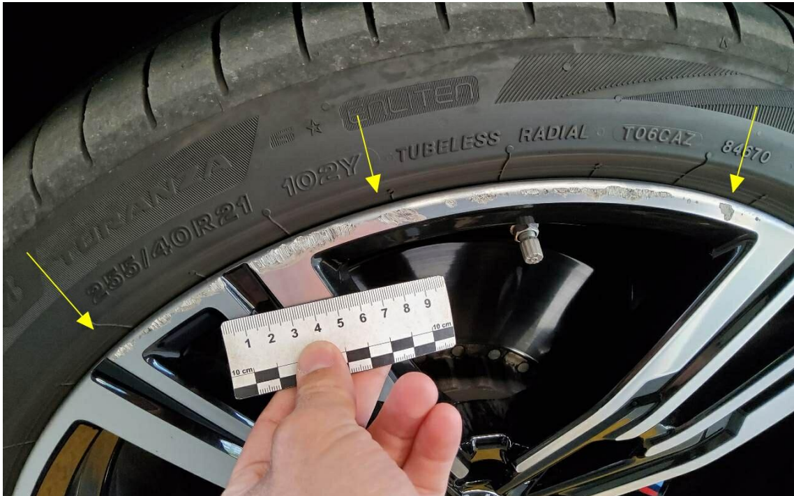
Bild 13 : Glanzgedrehte Sommerfelge vorne links verschrammt
