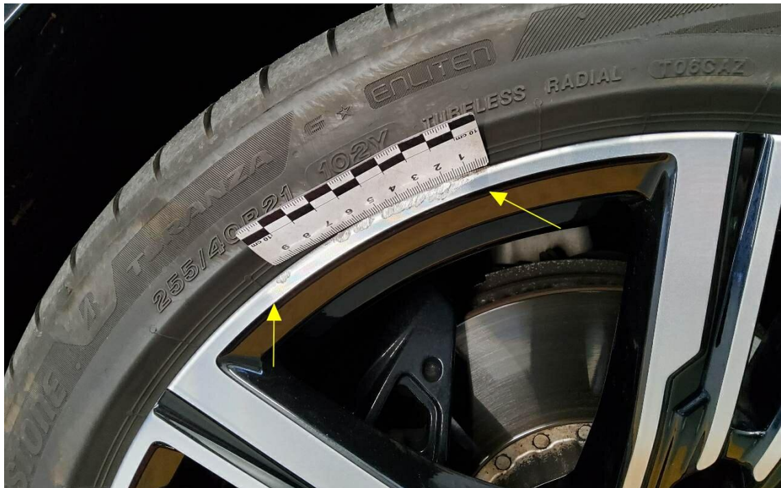
Bild 19 : Glanzgedrehte Sommerfelge vorne rechts verschrammt
