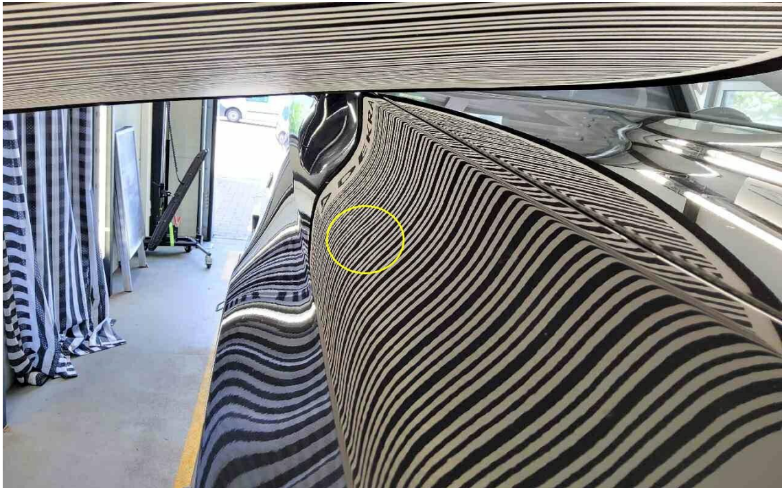
Bild 21 : Kotflügel rechts eingedellt
