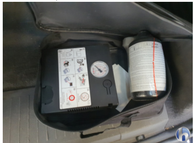
4. Tire-fit Füllmittel Fällig - Erneuern
