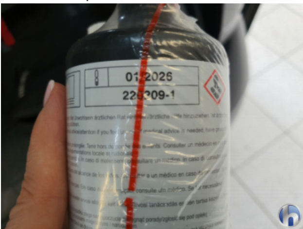
4. Tire-fit Füllmittel Fällig - Erneuern
