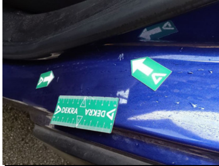
Entrée de porte / Arrière Gauche / Rayure
