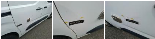
Door trim RR, Scratch(es), Replace
