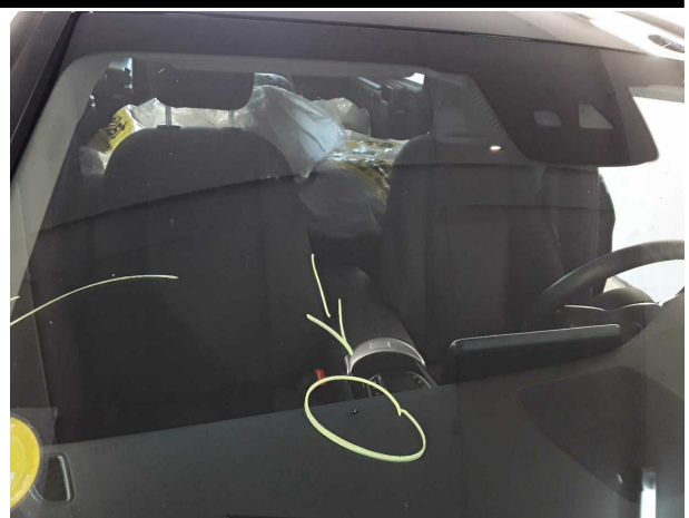
Beschädigung #8: Verglasung: Frontscheibe (Rissbildung) - Steinschlag - erneuern
