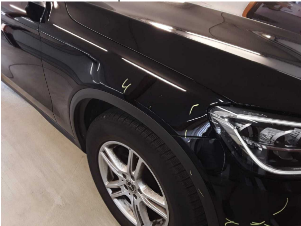
Beschädigung #6: Kotflügel rechts: Kotflügel rechts - verkratzt / verschürft - instandsetzen und lackieren
