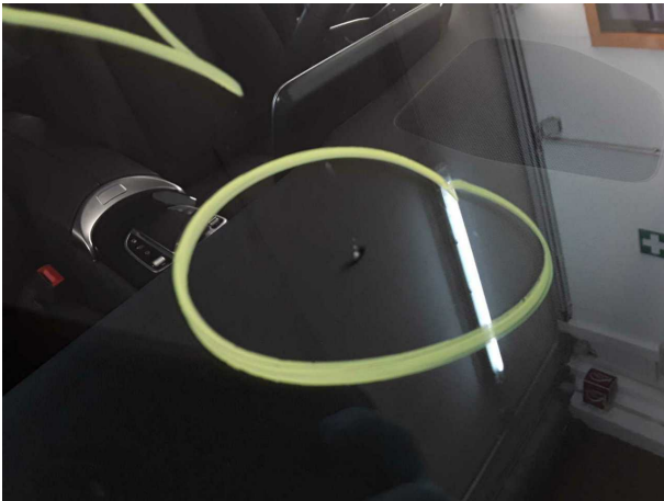
Beschädigung #8: Verglasung: Frontscheibe (Rissbildung) - Steinschlag - erneuern
