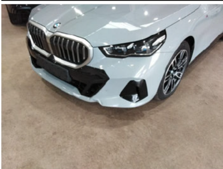
Stoßfänger / Vorne / Gebrochen
