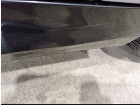
Schwellerverkleidung / Links / Kratzer
