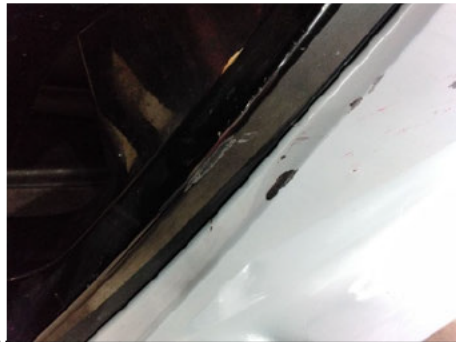
Stoßfängerleiste / Vorne Links / Kratzer
