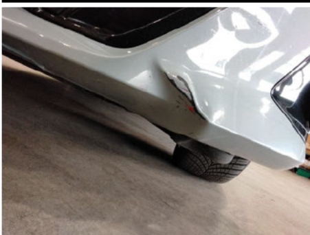
Stoßfänger / Vorne / Gebrochen
