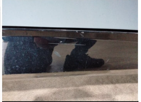
Schwellerverkleidung / Links / Kratzer
