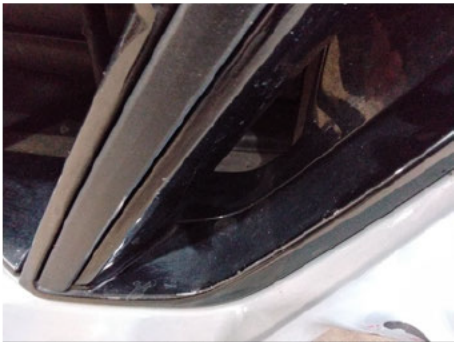
Stoßfängerleiste / Vorne Links / Kratzer
