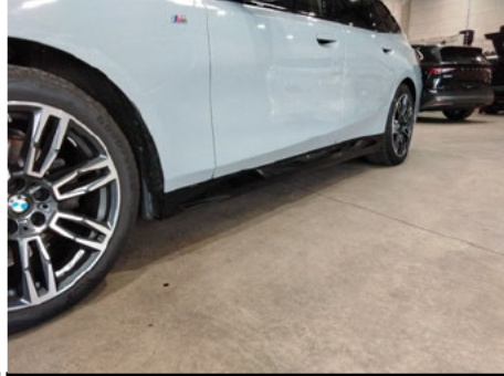
Schwellerverkleidung / Links / Kratzer
