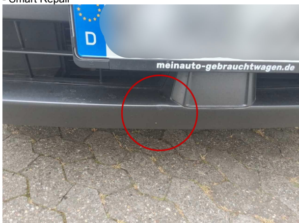
Beschädigung #3: Stossfänger vorn: Stossfänger vorn (unlackiert) - beschädigt - erneuern
