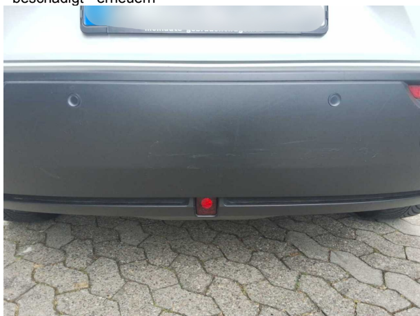
Beschädigung #4: Stossfänger hinten: Stossfänger hinten (unlackiert) - verkratzt / verschürft - erneuern
