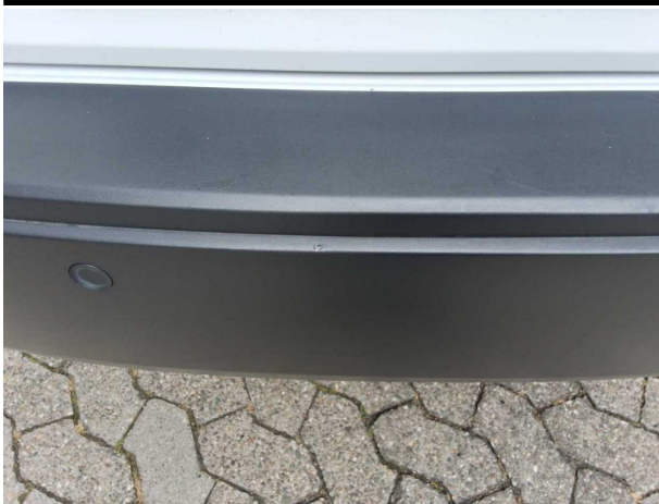
Beschädigung #4: Stossfänger hinten: Stossfänger hinten (unlackiert) - verkratzt / verschürft - erneuern
