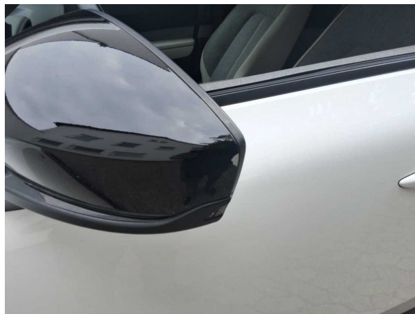
Beschädigung #1: Außenspiegel links: Abdeckkappe - Lackmangel - Smart Repair
