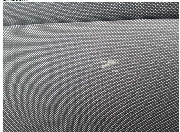
Beschädigung #5: Sitz hinten: Rücksitz - beschädigt - erneuern
