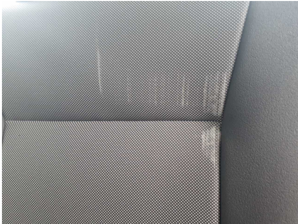
Beschädigung #5: Sitz hinten: Rücksitz - beschädigt - erneuern
