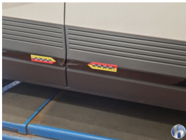
3. Türleisten Beschädigt - Erneuern
