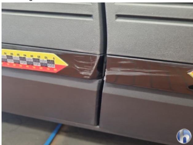
3. Türleisten Beschädigt - Erneuern
