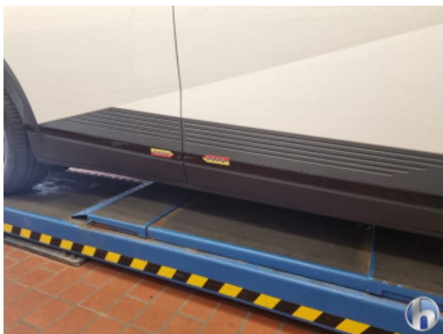
3. Türleisten Beschädigt - Erneuern
