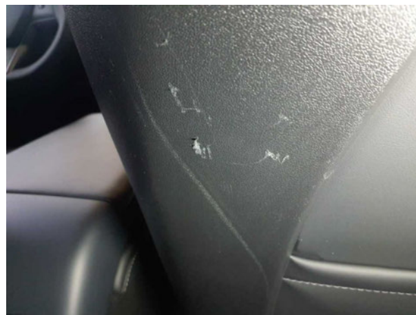
Beschädigung #4: Sitz vorn: Lehne rechts (Verkleidung hinten) - verkratzt / verschürft - Wertminderung
