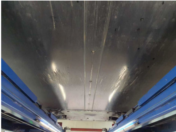
Beschädigung #7: elektrisches System: Batterieabdeckung (Mehrkosten möglich) - verkratzt / verschürft - befunden ggf.
