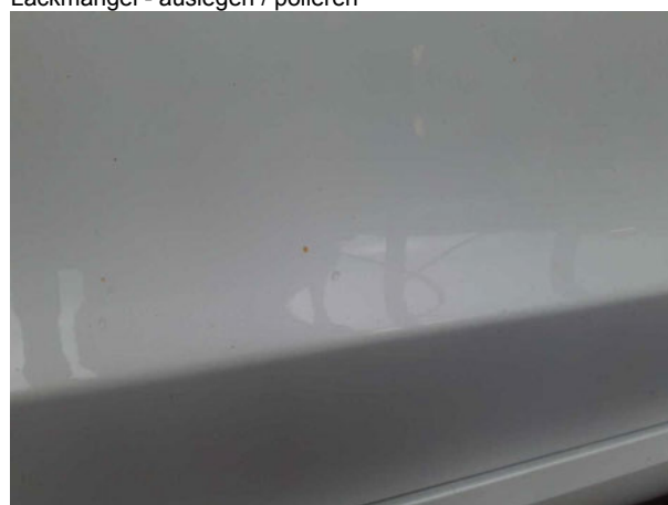
Beschädigung #3: Tür vorn links: Tür (Flugrost) - auslegen / polieren
