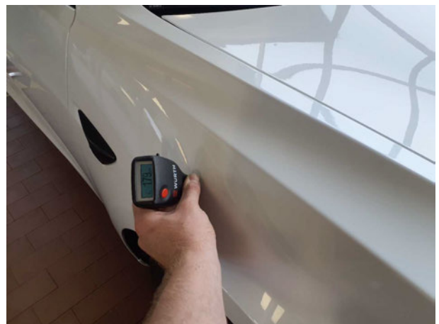
Nachlackierung 1: Kotflügel rechts, Tür vorne rechts
