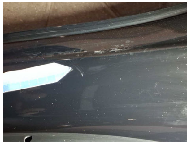
Beschädigung #1: Schweller rechts: Einstieg - verkratzt / verschürft - Smart Repair
