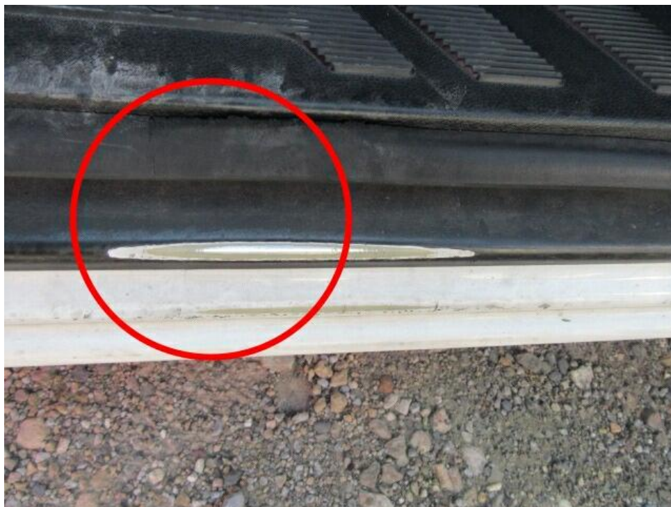
Bild 15 : Einstige vorne links Lackabtragungen Folie Einstieg vorne links schadhaft
