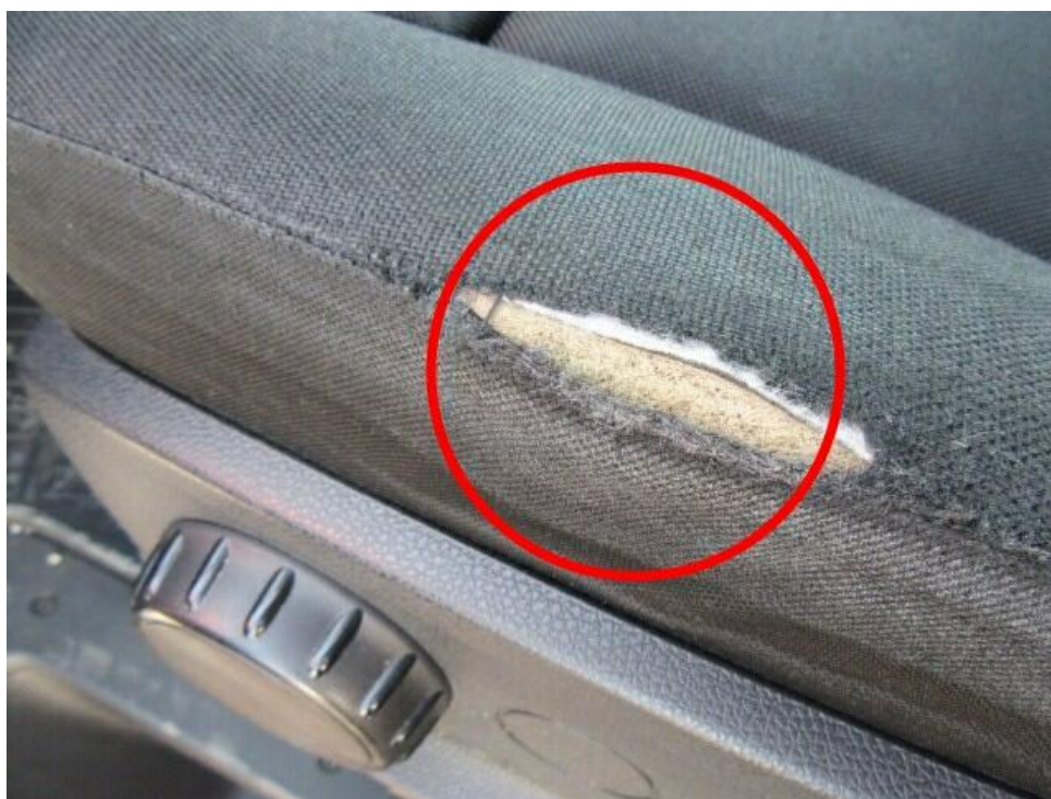
Bild 16 : Sitzbezug und Polster vorne links schadhaft
