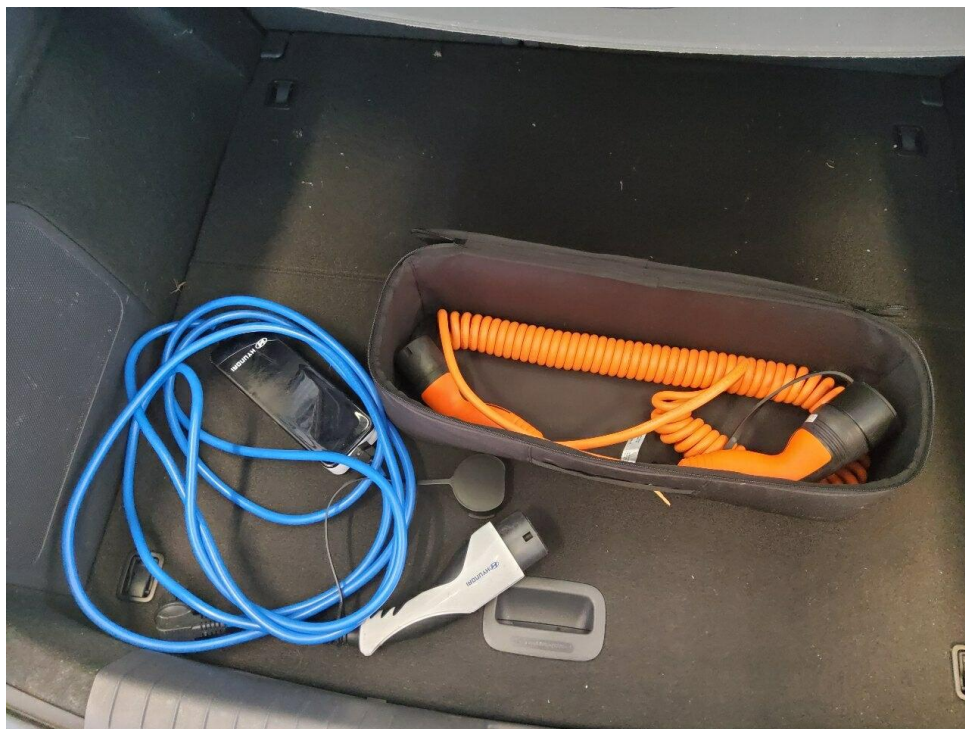
Bild 6 : Ladekabel beim E-Fahrzeug
