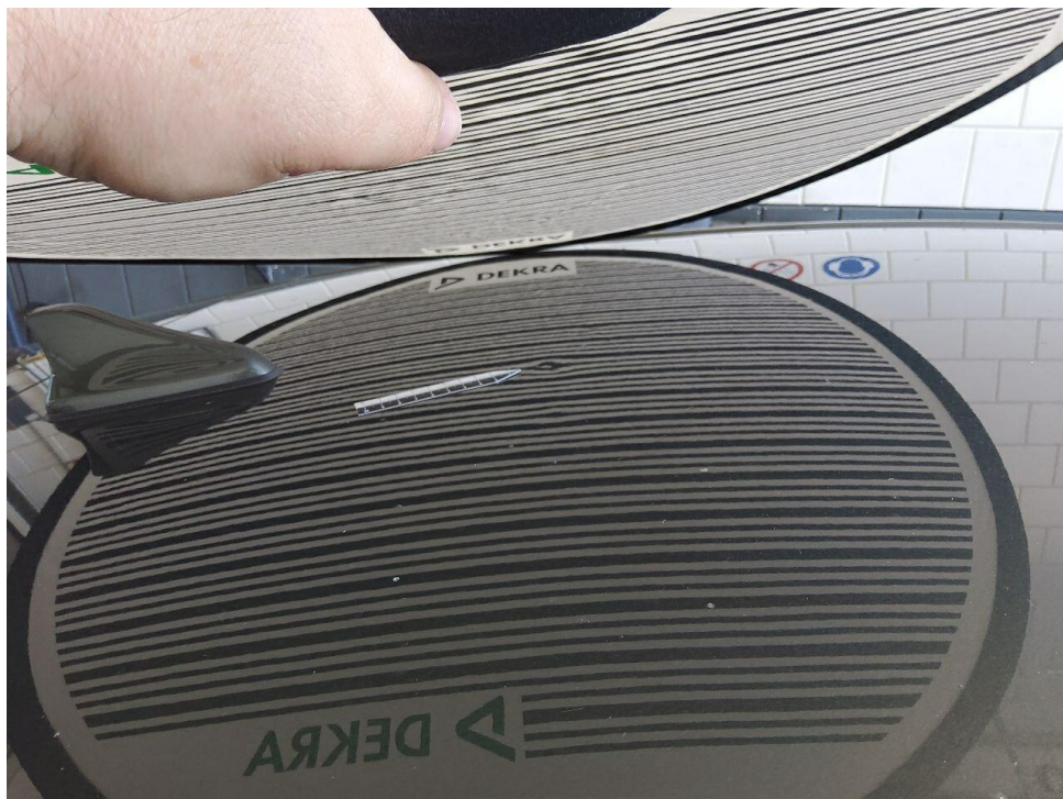
Bild 13 : Dach, mehrfach eingedellt, drücken
