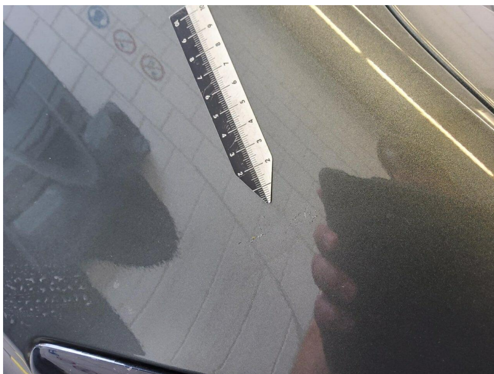
Bild 11 : Seitenteil hinten links Lackierung, Umweltschaden, lackieren mit Lackaufbau
