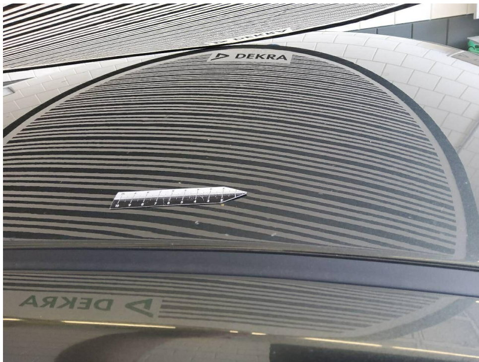
Bild 14 : Dach, mehrfach eingedellt, drücken
