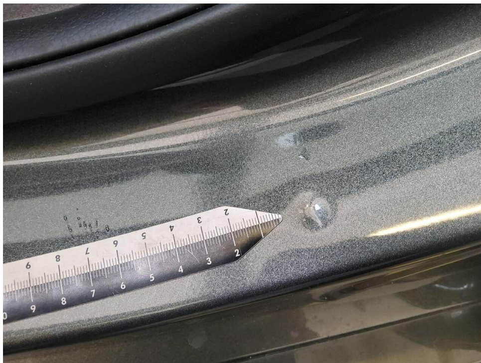
Bild 8 : Tür vorne links, mehrfach eingedellt, instandsetzen und lackieren mit Lackaufbau
