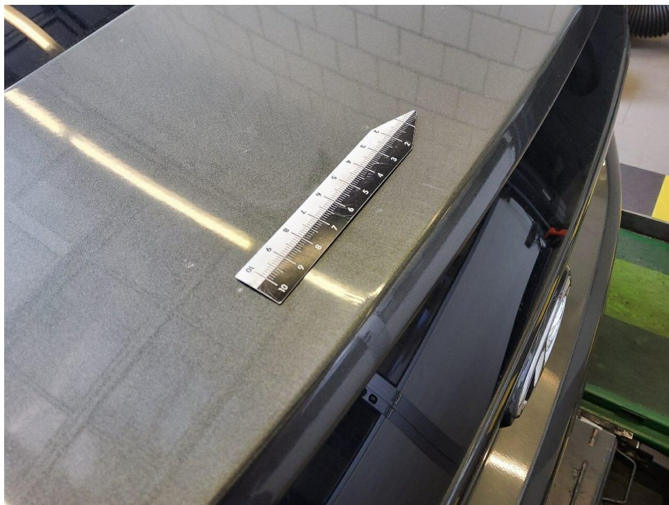
Bild 10 : Heckdeckel Lackierung, Umweltschaden, lackieren mit Lackaufbau
