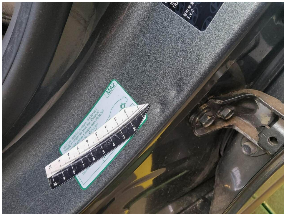
Bild 7 : Tür vorne links, mehrfach eingedellt, instandsetzen und lackieren mit Lackaufbau
