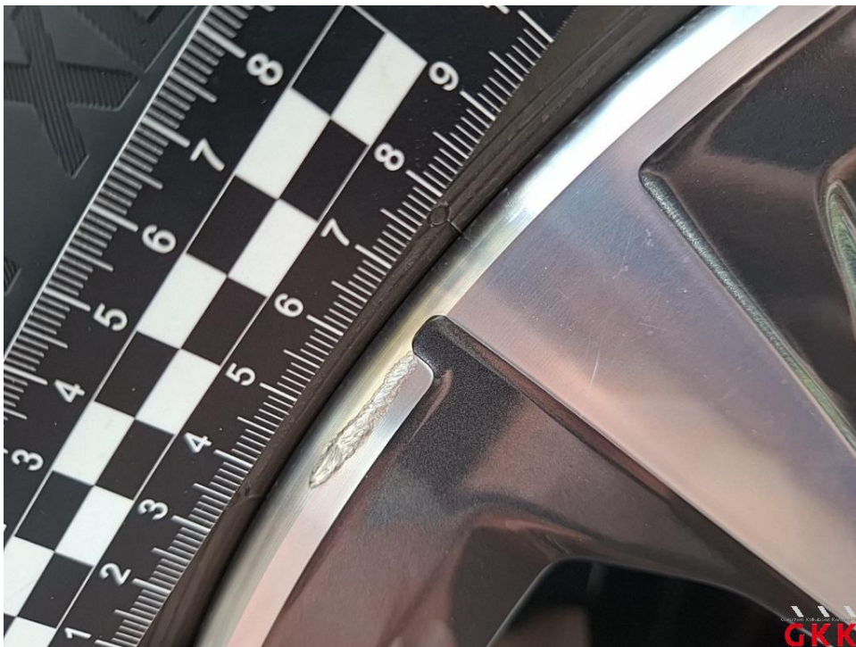
Bild 14. LM-Rad, hinten rechts, Materialabtrag, ersetzen
