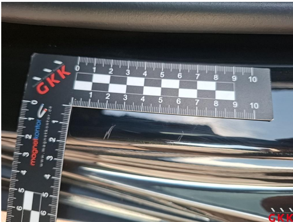
Bild 28. Tür hinten links, Einstieg, verkratzt, auslegen, schleifen, polieren
