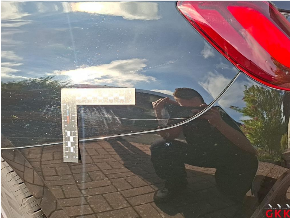
Bild 31. Seitenwand links, verkratzt, lackieren
