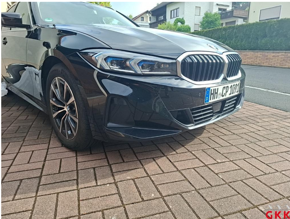
Bild 18. Stoßfänger vorne, Verkleidung -lackiert-, verkratzt, Smartrepair
