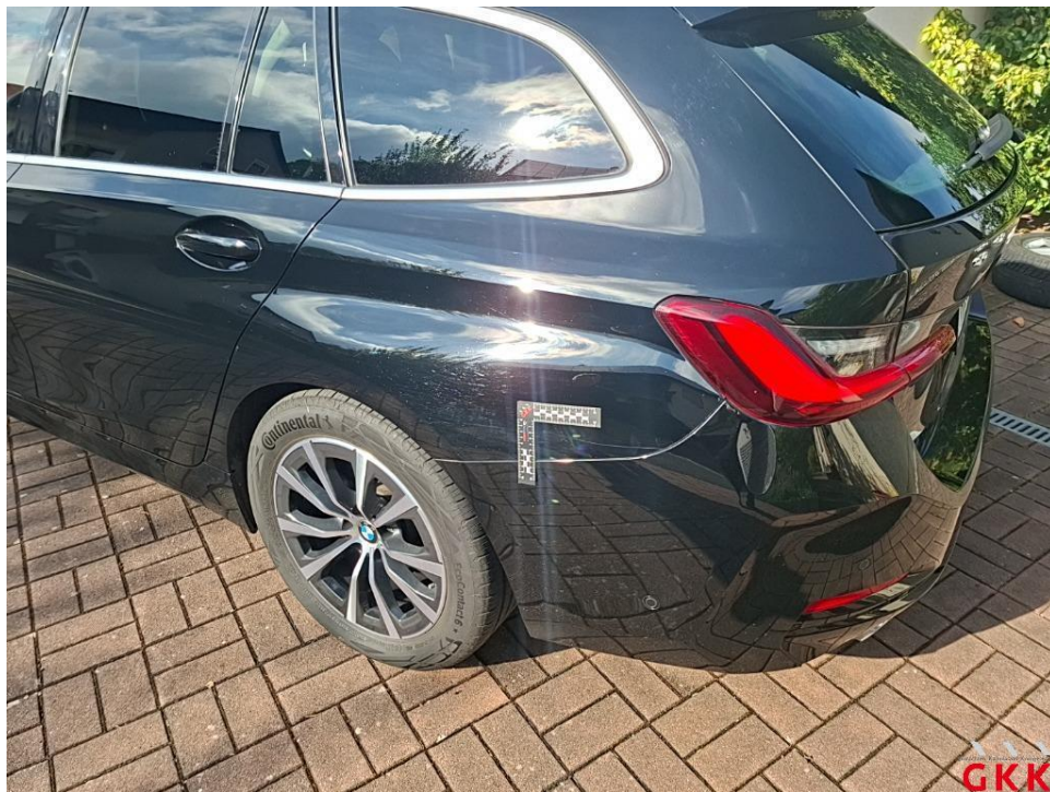
Bild 30. Seitenwand links, verkratzt, lackieren
