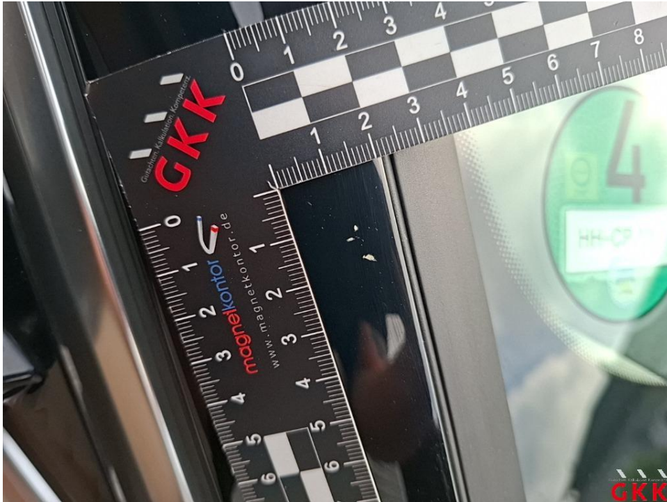
Bild 23. A- Säule rechts, Steinschlag und Kratzer, auslegen, schleifen, polieren
