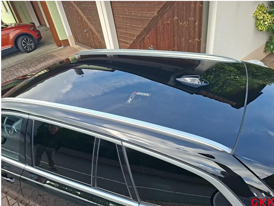
Bild 24. Dach, Harzanhaftungen/-rückstände, aufbereiten
