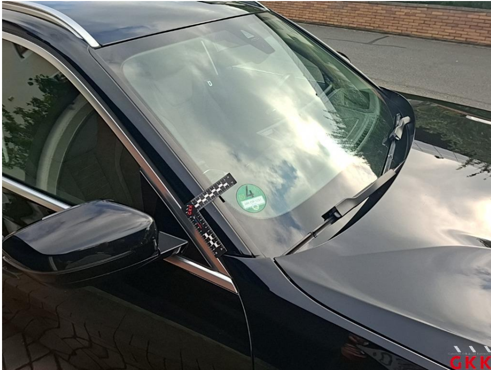
Bild 21. A- Säule rechts, Steinschlag und Kratzer, auslegen, schleifen, polieren
