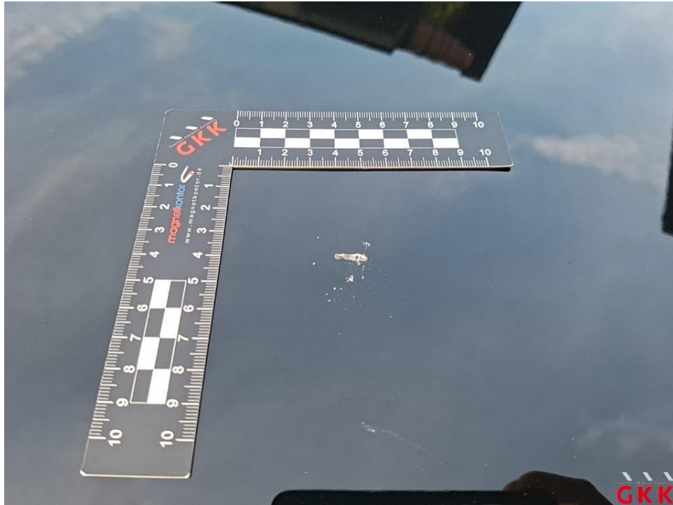
Bild 25. Dach, Harzanhaftungen/-rückstände, aufbereiten
