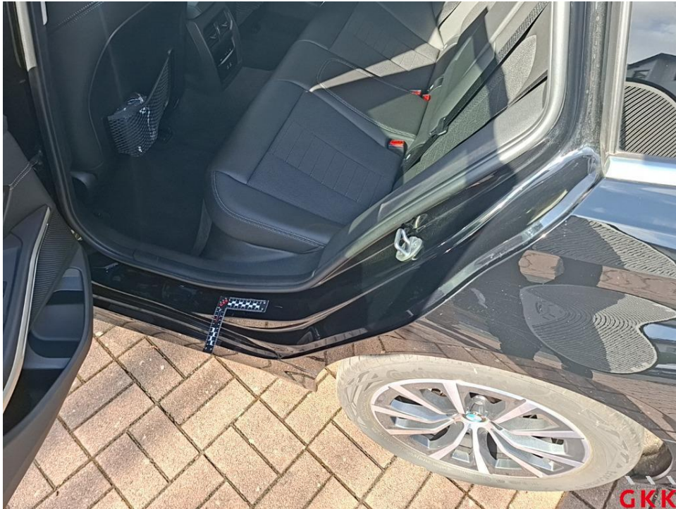
Bild 27. Tür hinten links, Einstieg, verkratzt, auslegen, schleifen, polieren
