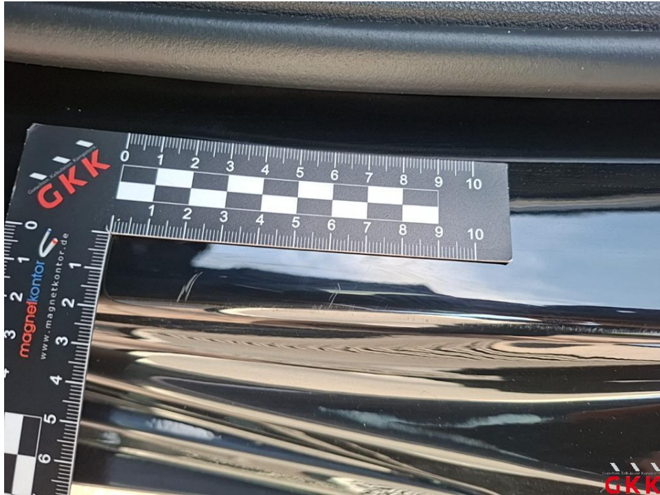
Bild 29. Tür hinten links, Einstieg, verkratzt, auslegen, schleifen, polieren
