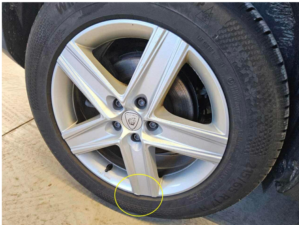
Bild 36 : Leichtmetallfelge Winterrad hinten rechts verschrammt
