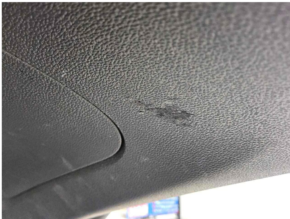
Bild 42 : Verkleidung Heckklappe verschrammt
