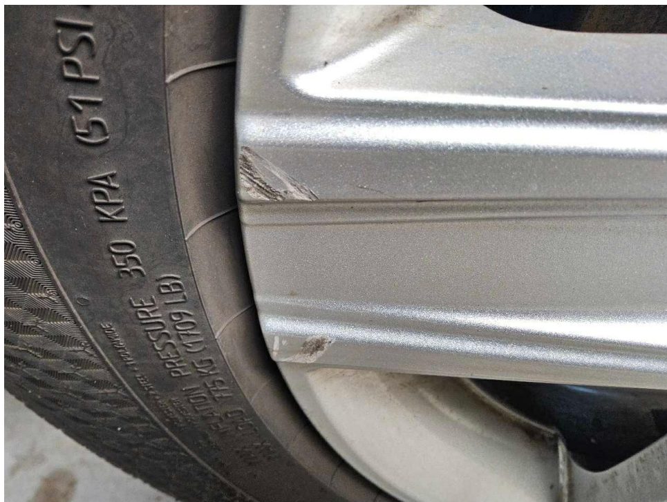
Bild 40 : Leichtmetallfelge Winterrad hinten links verschrammt
