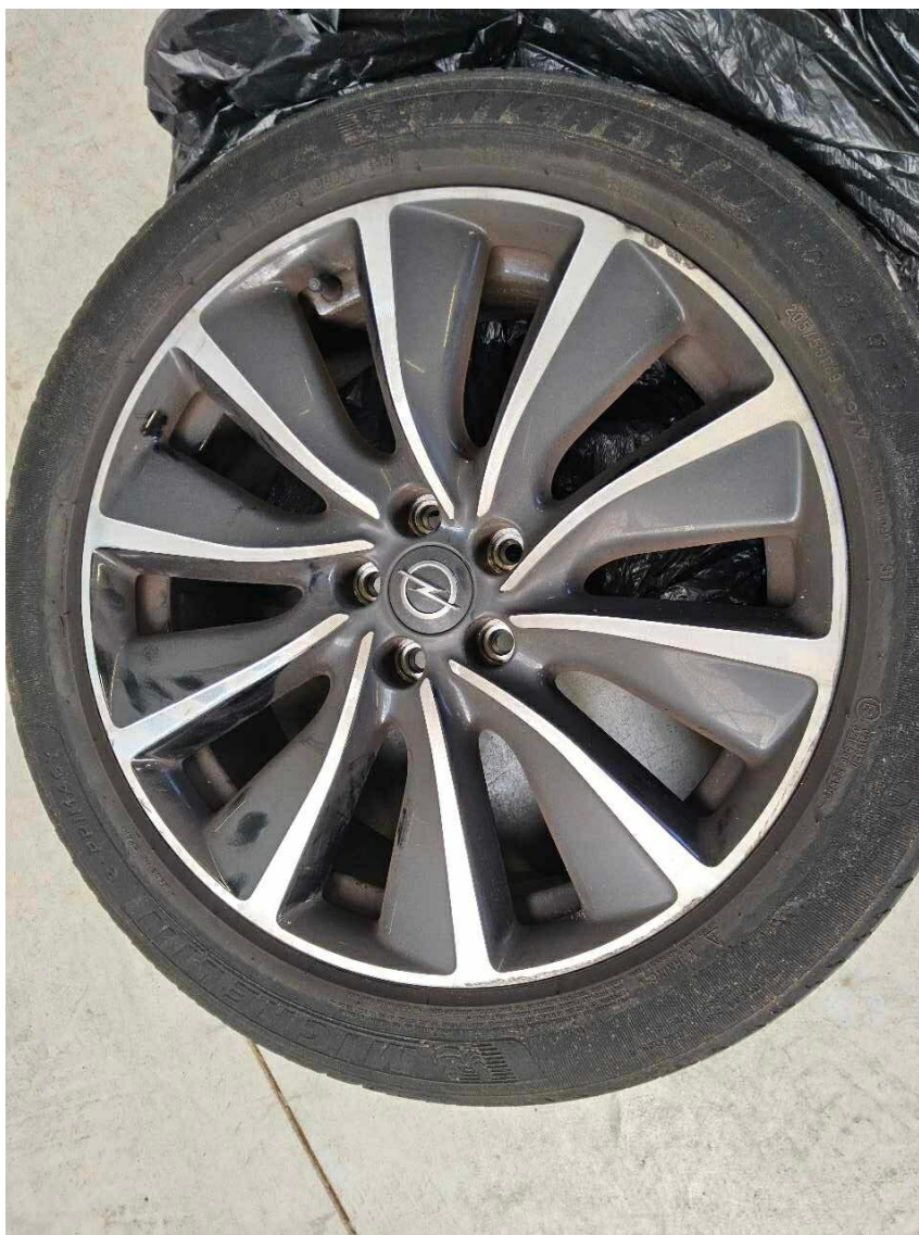
Bild 18 : Glanzgedrehte Leichtmetallfelge vorne rechts verschrammt, Materialabtrag >1mm
