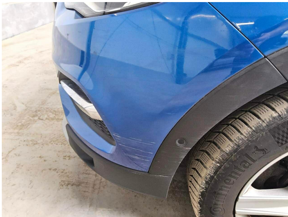
Bild 23 : Stoßfänger und Radlaufblende vorne linksseitig verschrammt
