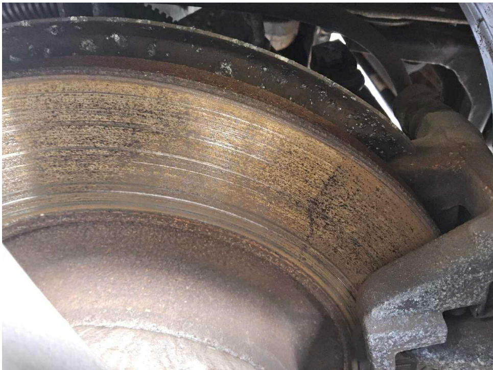
Bild 34 : Bremsscheiben Hinterachse Tragbild mangelhaft, Riefen-und Korrosionsbildung
