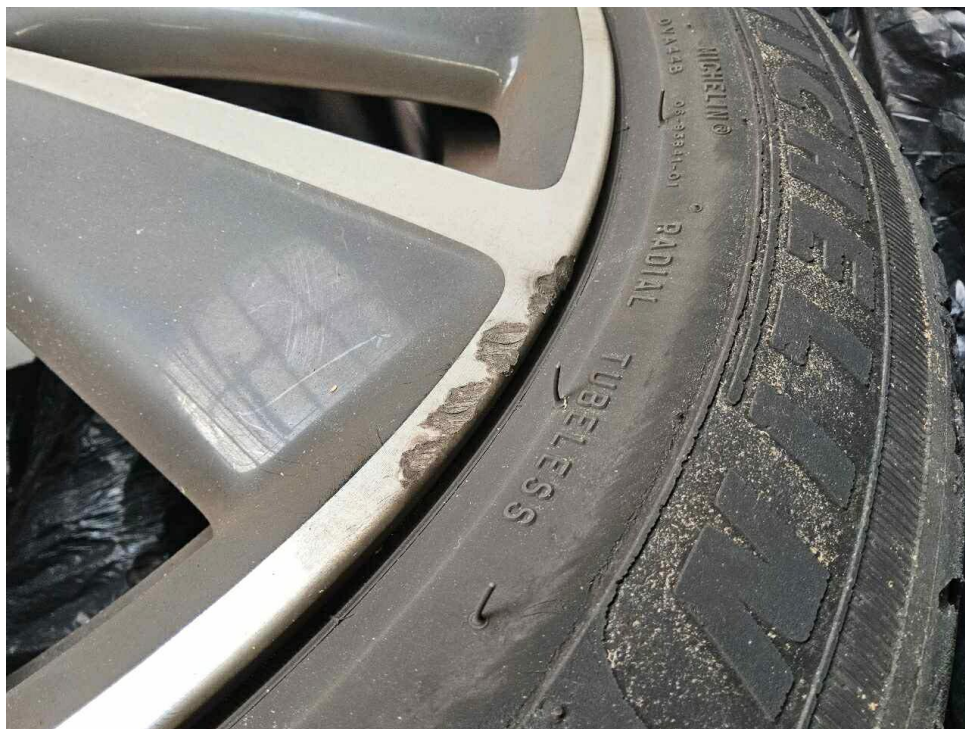
Bild 19 : Glanzgedrehte Leichtmetallfelge vorne rechts verschrammt, Materialabtrag >1mm
