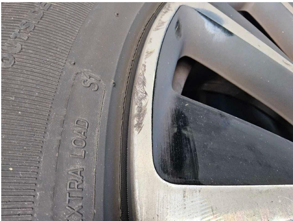
Bild 22 : Glanzgedrehte Leichtmetallfelge vorne links verschrammt, Materialabtrag >1mm
