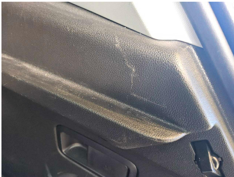
Bild 45 : Verkleidung Laderaum rechts verschrammt
