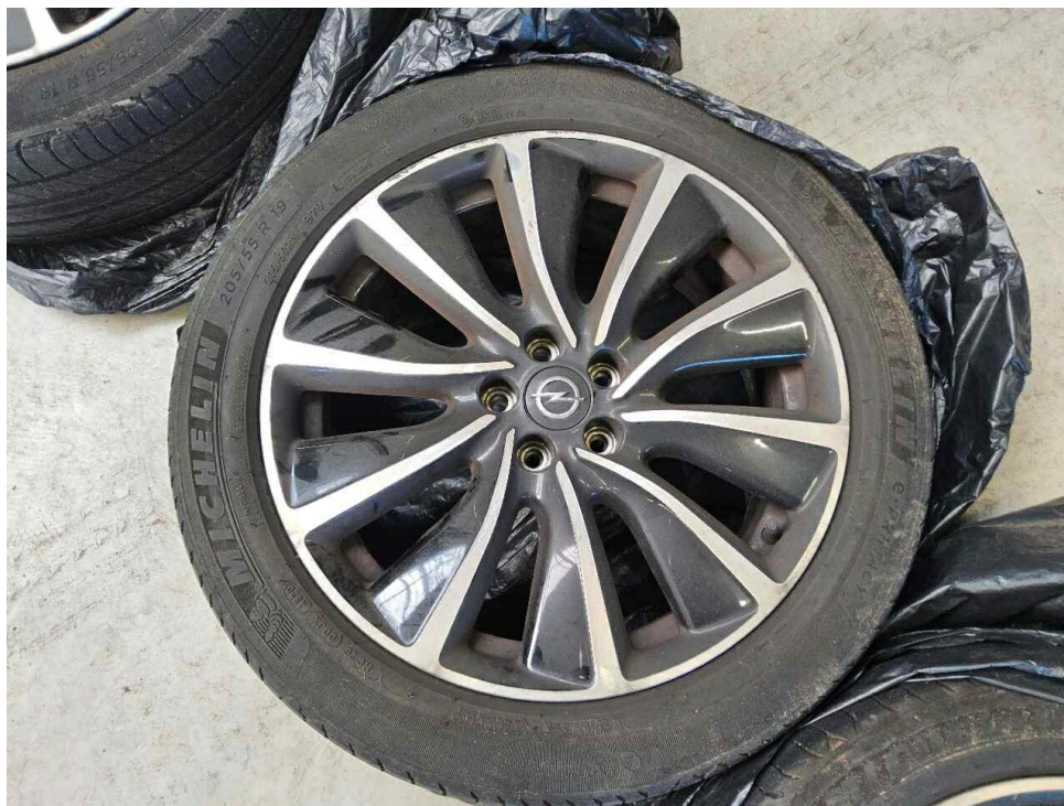
Bild 20 : Glanzgedrehte Leichtmetallfelge vorne links verschrammt, Materialabtrag >1mm
