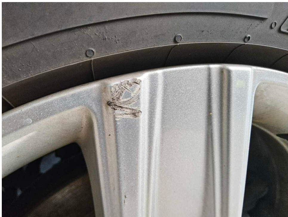
Bild 39 : Leichtmetallfelge Winterrad hinten links verschrammt
