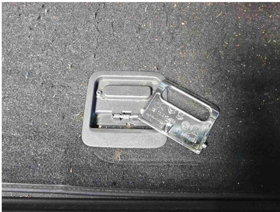
Bild 49 : Griff Ablageboden Laderaum gebrochen
