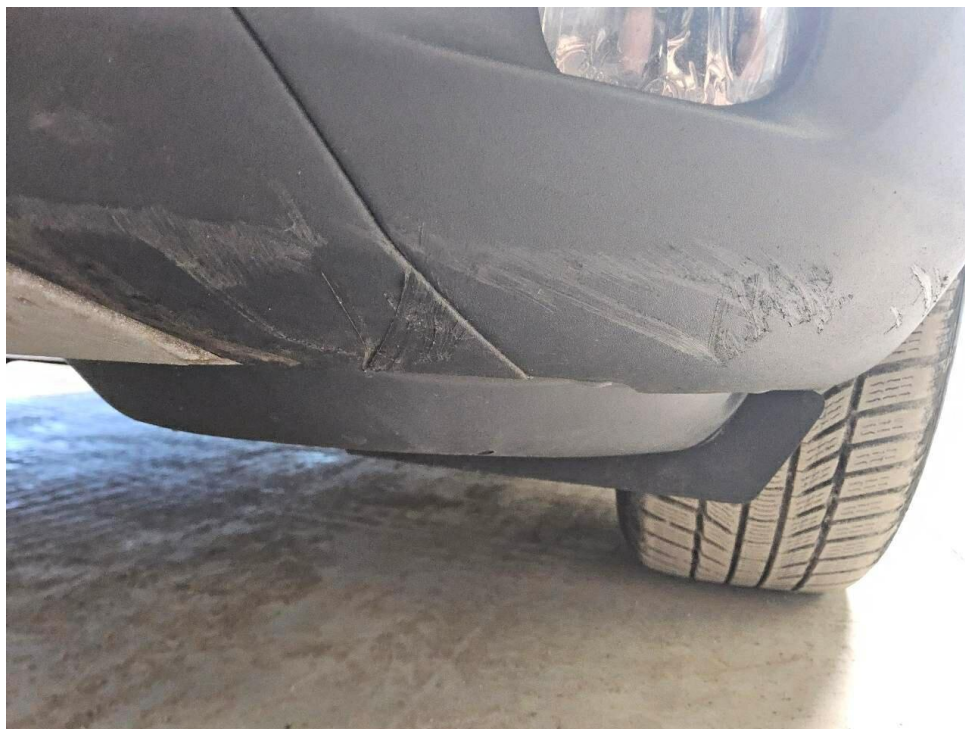
Bild 25 : Stoßfänger und Radlaufblende vorne linksseitig verschrammt
