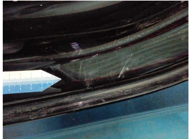
Beschädigung #3: Seitenwand links: Einstieg - Kratzer - Smart Repair
