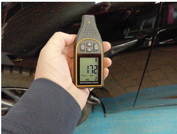
Nachlackierung 1: Kotflügel links, Seitenwand links, Tür hinten links
