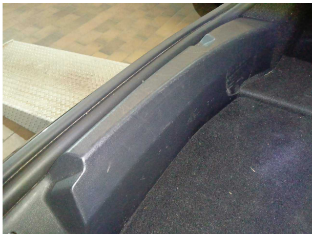
Beschädigung #1: Verkleidungen/Abdeckungen: Verkleidung Ladekante - verkratzt / verschürft - erneuern
