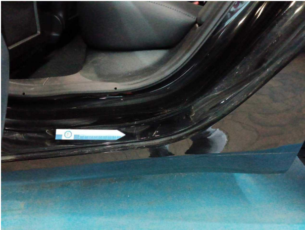
Beschädigung #3: Seitenwand links: Einstieg - Kratzer - Smart Repair
