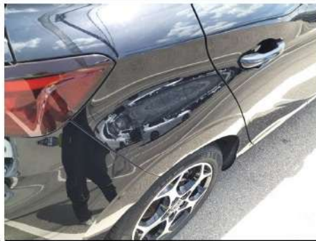
Parafango / Posteriore Destro / Rientranza
