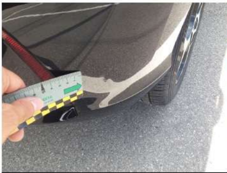
Paraurti / Posteriore / Ammaccato vernice incisa
