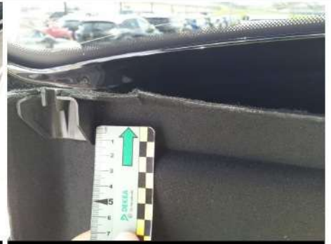
Ripia no cappelleria / - / Non conforme
