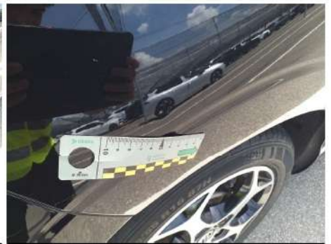
Parafango / Posteriore Destro / Rientranza
