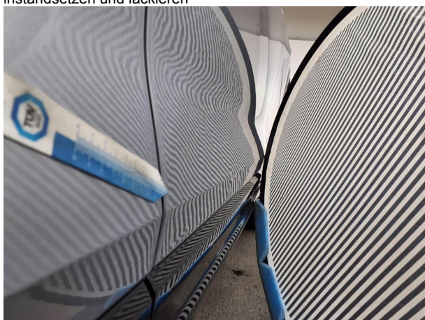
Beschädigung 6: Tür vorn rechts: Tür (Wellig) - Lackmangel - instandsetzen und lackieren
