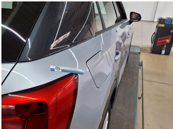
Beschädigung 1: Seitenwand rechts: Seitenwand - Delle(n) - Smart Repair
