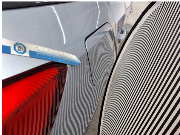
Beschädigung 1: Seitenwand rechts: Seitenwand - Delle(n) - Smart Repair
