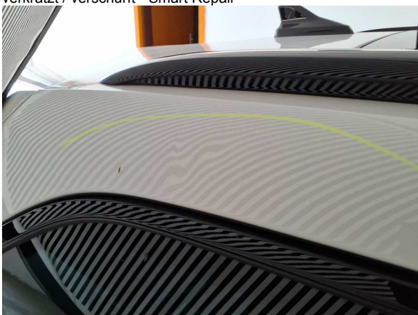
Beschädigung #13: Fahrzeugdach: Dachholm rechts - Delle(n) - sanft instandsetzen
