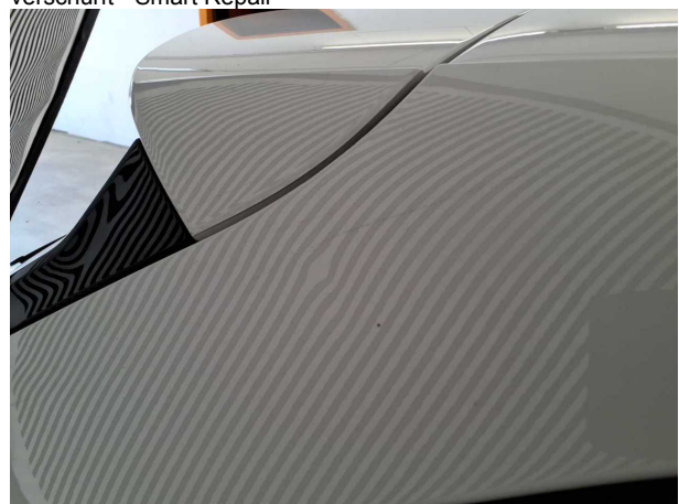
Beschädigung #13: Fahrzeugdach: Dachholm rechts - Delle... - sanft instandsetzen
