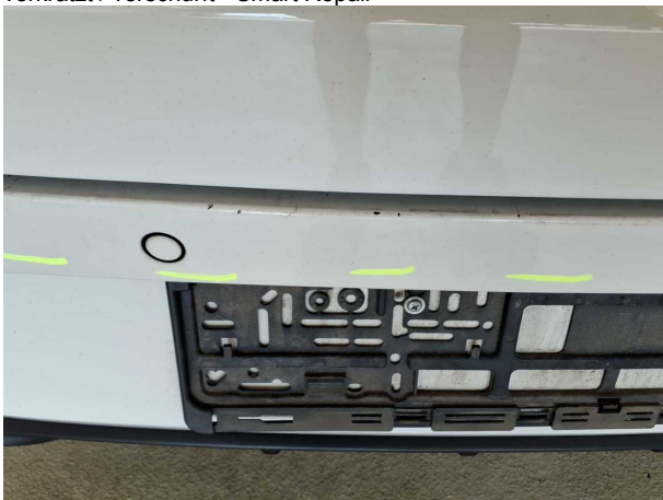
Beschädigung #11: Stossfänger hinten: Stossfänger hinten - verkratzt / verschürft - Smart Repair
