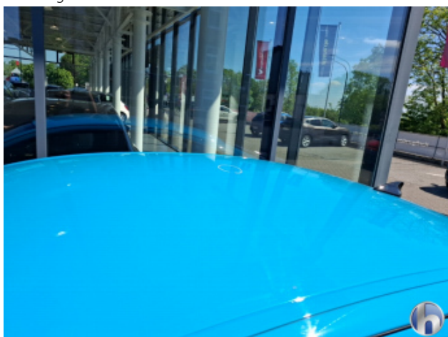
1. Dach Gebrauchsspuren - Ohne Reparatur
