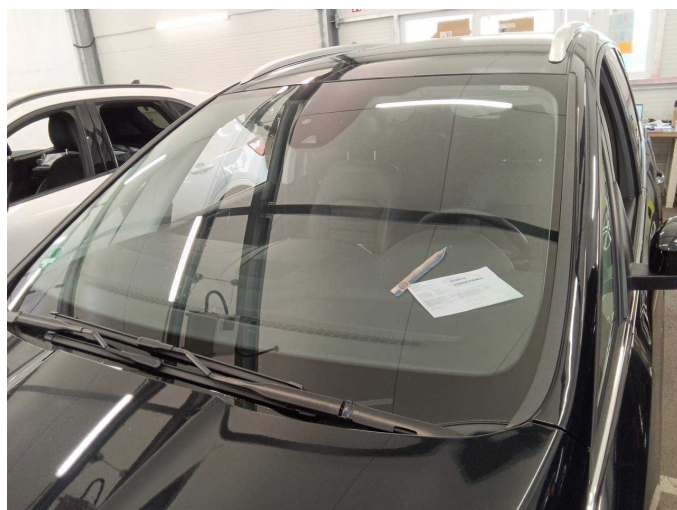
Damage 6: Vehicle glazing: Windscreen, heated (Großer Abplatzer im Fahrersichtfeld, Sichtbeeinträchtigung) - Stone chips - Replace
