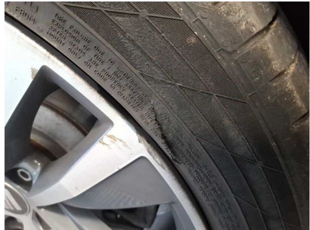
Beschädigung #2: Rad/Reifen: Reifen hinten rechts - beschädigt - erneuern
