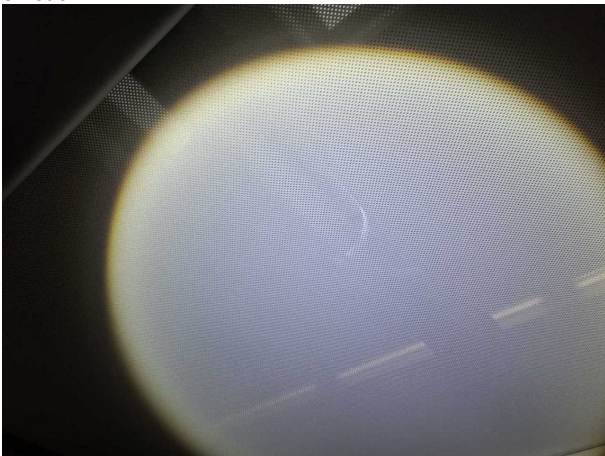
Beschädigung #5: Verkleidungen/Abdeckungen: Dachhimmel (Sonnenrollo) - beschädigt - erneuern
