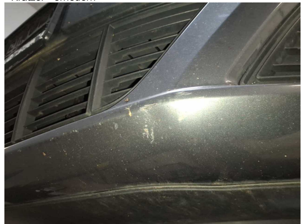
Beschädigung #7: Stossfänger vorn: Stossfänger vorn - verformt - erneuern
