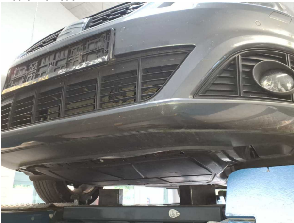
Beschädigung #7: Stossfänger vorn: Stossfänger vorn - verformt - erneuern
