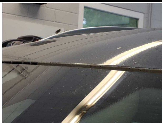
Beschädigung #8: Fahrzeugdach: Dach - Korrosion - lackieren
