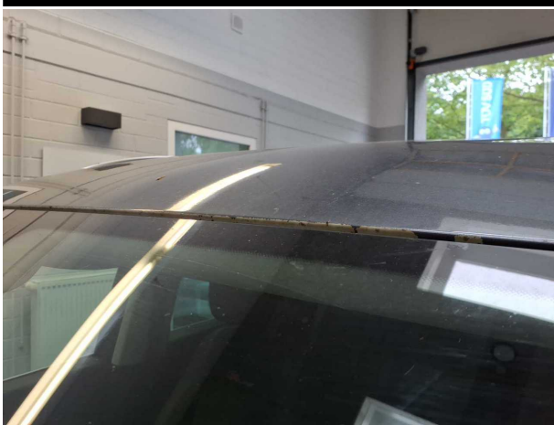
Beschädigung #8: Fahrzeugdach: Dach - Korrosion - lackieren
