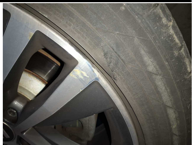
Beschädigung #6: Rad/Reifen: Leichtmetallfelge hinten rechts - Kratzer - erneuern
