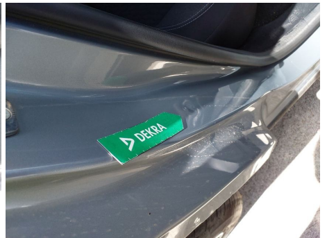
Travesaño de la puerta / Trasero Derecho / Abolladura
