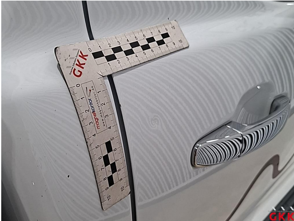
Bild 45. Tür hinten rechts, bis 3 Dellen / Bauteil, Smartrepair
