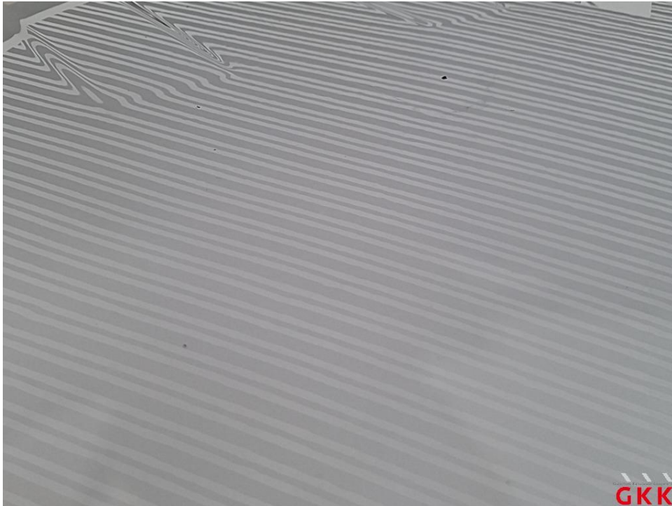
Bild 49. Dach, 4 bis 10 Dellen / Bauteil, kalt drücken
