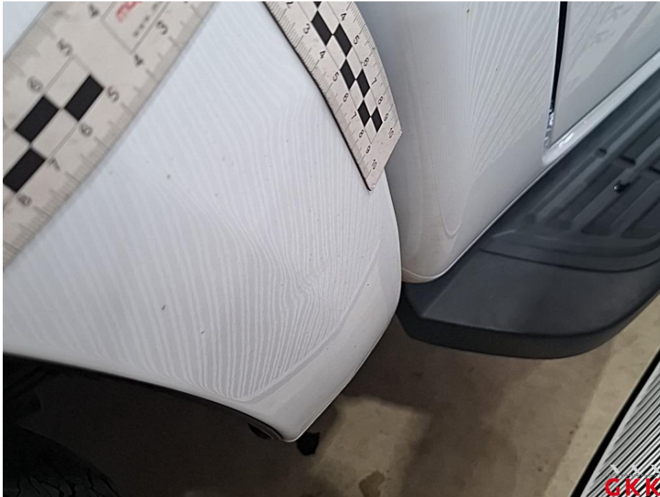
Bild 43. Seitenwand rechts, beschädigt, instand setzen - lackieren
