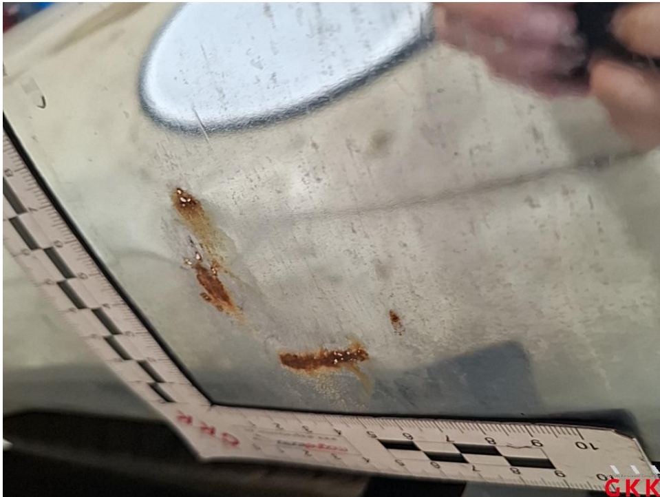
Bild 38. Stoßfänger hinten, Ecke rechts -unlackiert-, beschädigt, ersetzen
