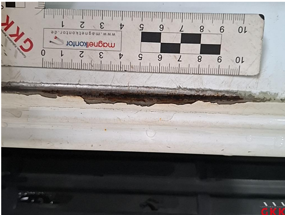
Bild 20. Tür vorne links, Einstieg, verkratzt, lackieren
