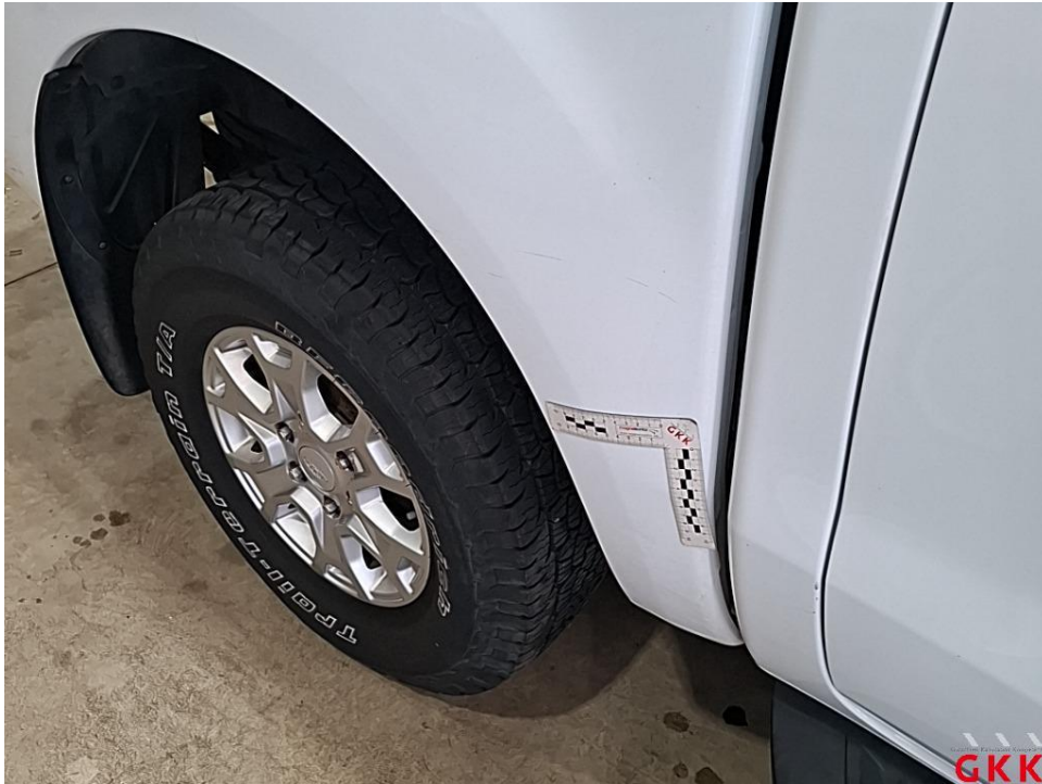
Bild 41. Seitenwand rechts, beschädigt, instand setzen - lackieren
