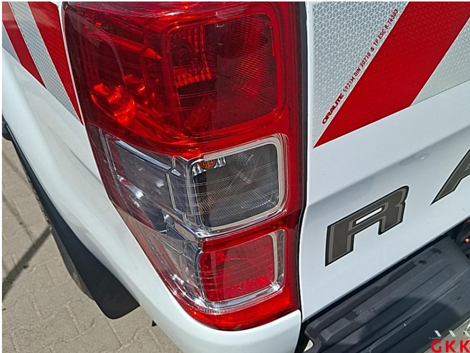
Bild 62. Rückleuchte links, außen, verkratzt, ersetzen
