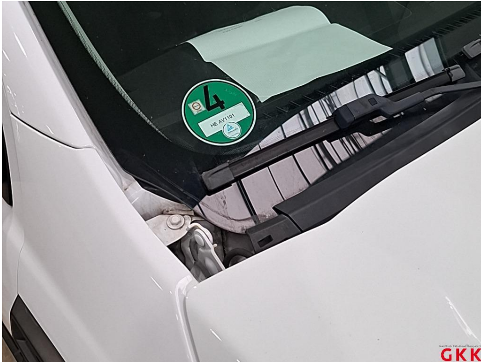
Bild 17. Frontscheibe, Leiste -rechts-, fehlt, ersetzen
