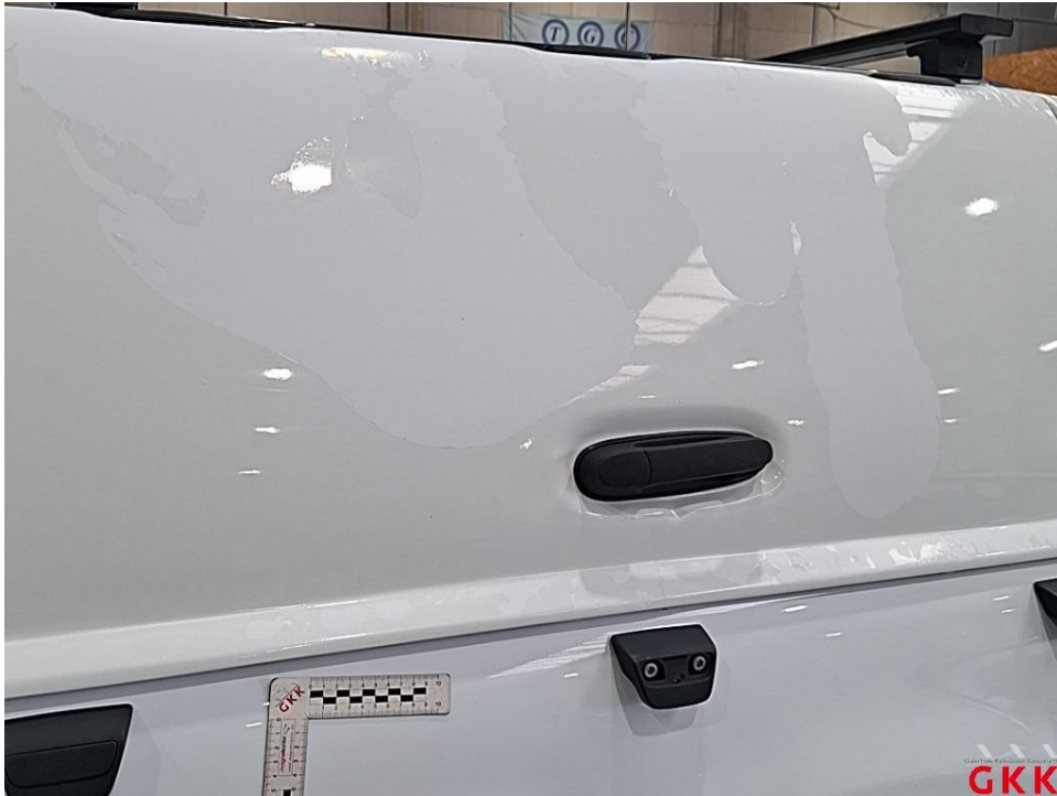
Bild 39. Kabinenaufbau hinten Tür rechts, Lackierung verätzt, lackieren
