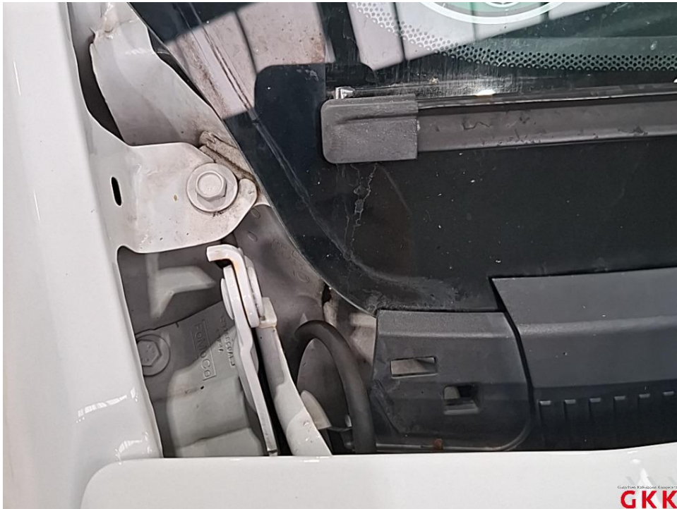
Bild 18. Frontscheibe, Leiste -rechts-, fehlt, ersetzen
