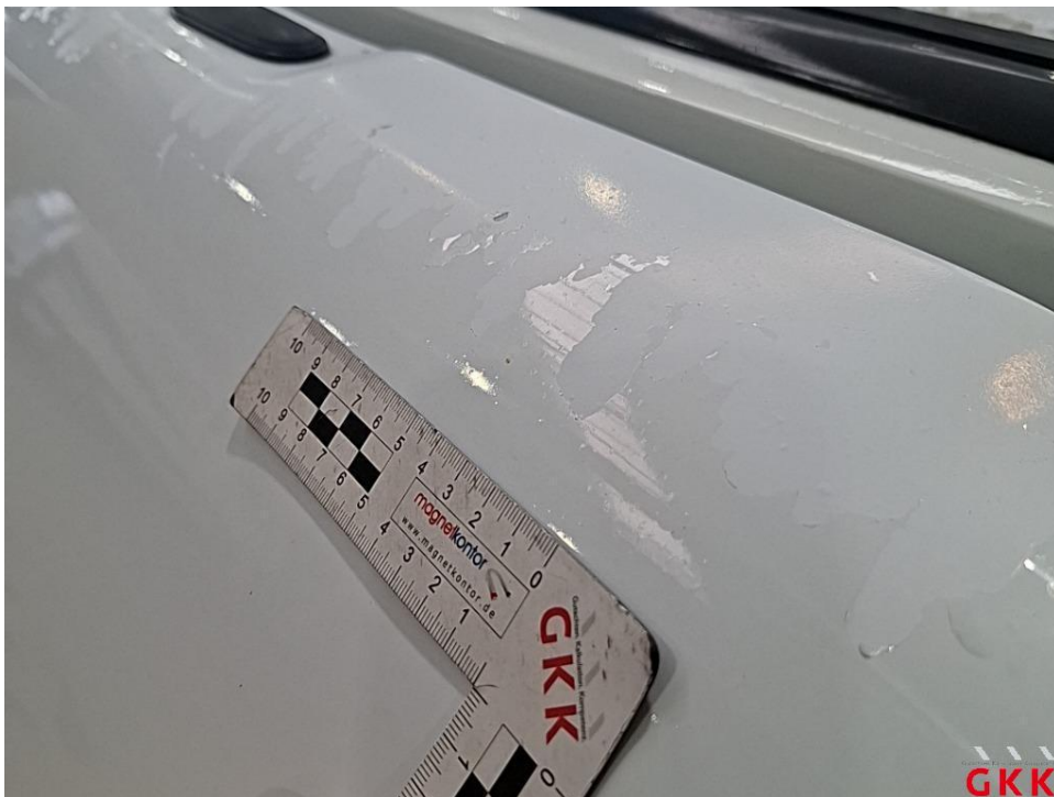
Bild 54. Kabinenaufbau hinten Tür links, Lackierung verätzt, lackieren
