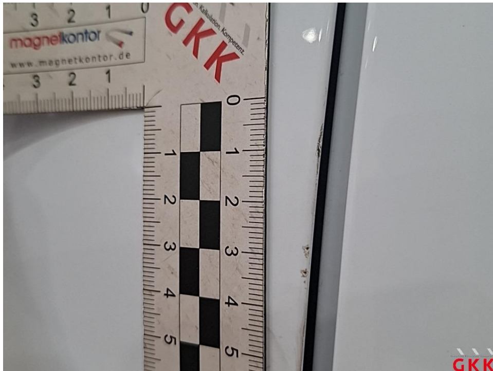
Bild 23. Tür vorne links, Kante, verkratzt, Smartrepair
