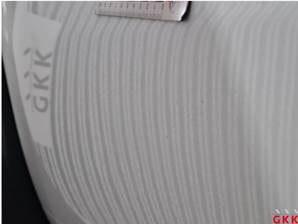
Bild 25. Seitenwand links, Reparaturmangel, Smartrepair
