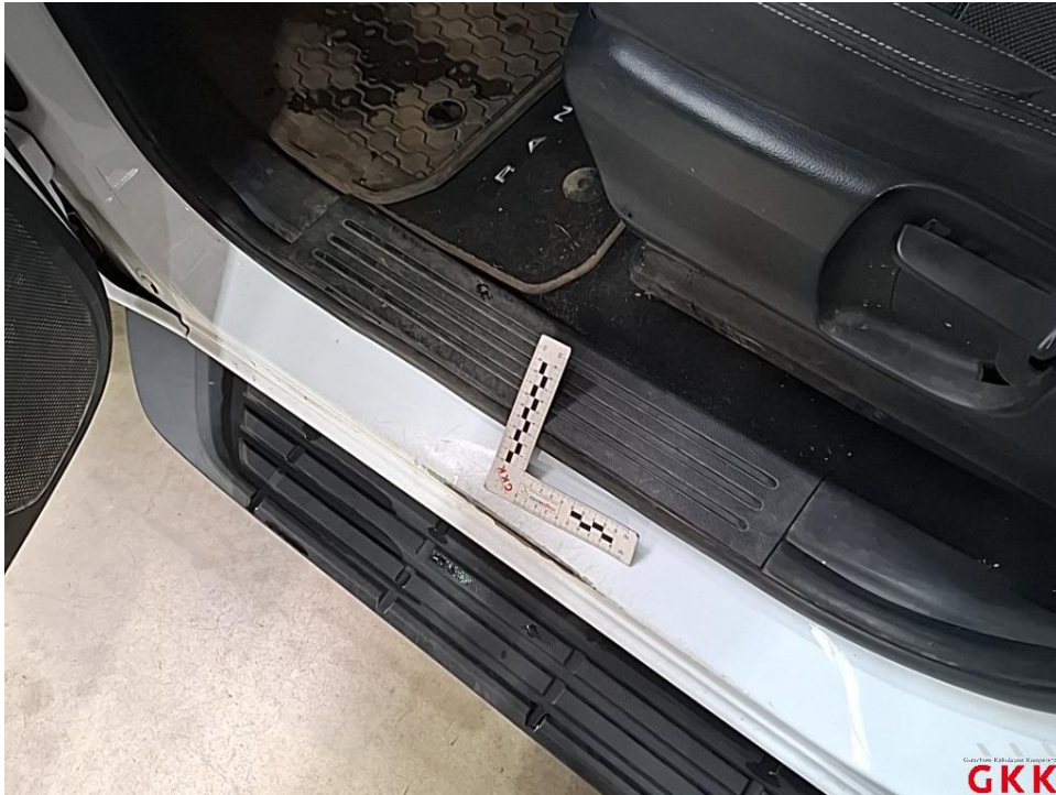
Bild 19. Tür vorne links, Einstieg, verkratzt, lackieren
