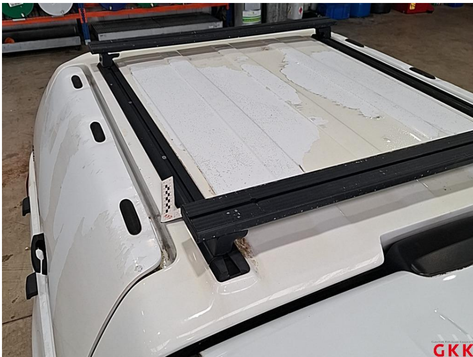
Bild 50. Kabinenaufbau hinten, Lackierung verätzt, lackieren
