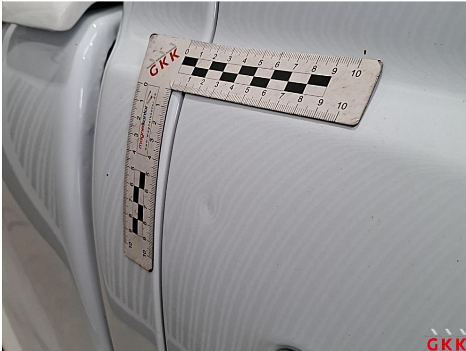
Bild 46. Tür hinten rechts, bis 3 Dellen / Bauteil, Smartrepair
