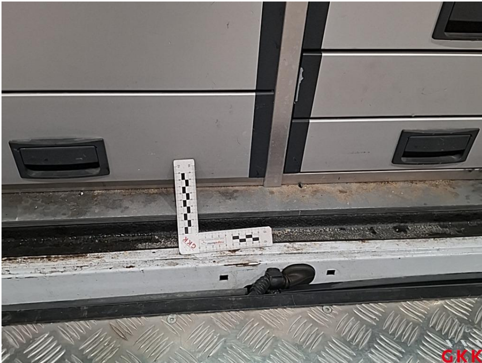
Bild 30. Ladekante, verkratzt, lackieren
