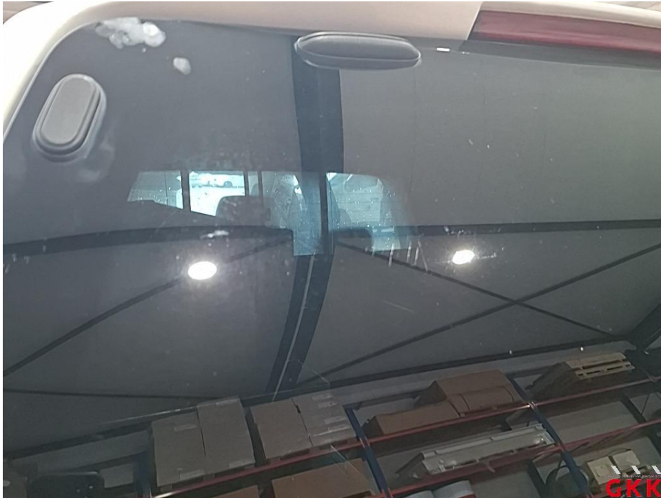
Bild 33. Heckscheibe, getönt, verkratzt, polieren
