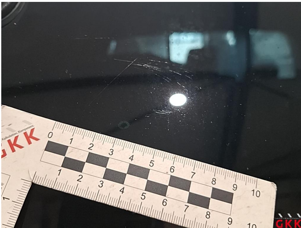
Bild 34. Heckscheibe, getönt, verkratzt, polieren
