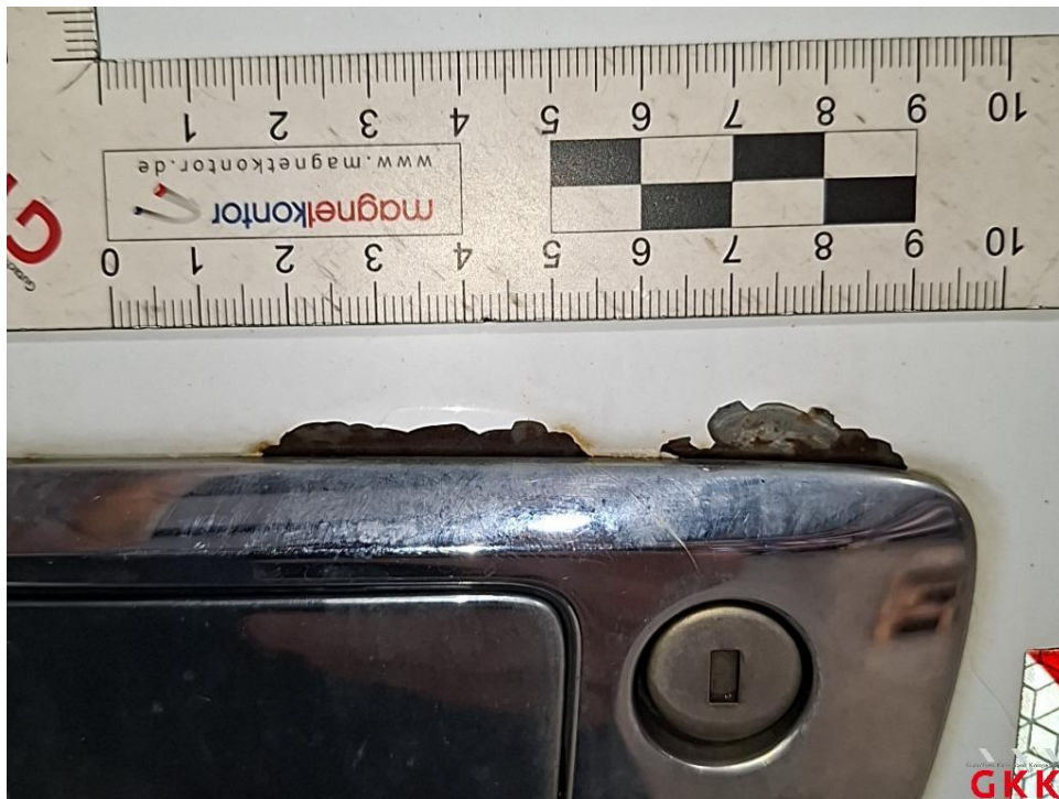
Bild 28. Heckklappe, korrodiert, instand setzen - lackieren
