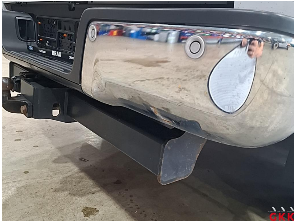
Bild 36. Stoßfänger hinten, Ecke rechts -unlackiert-, beschädigt, ersetzen
