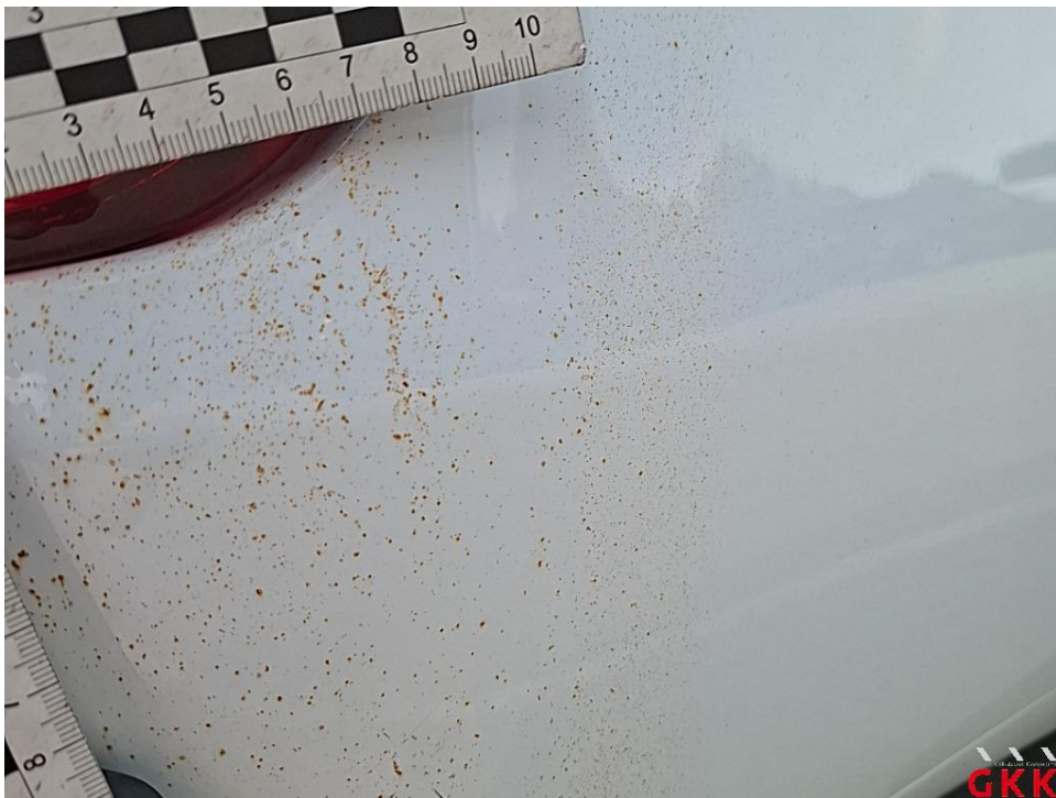
Bild 66. Seitenwand rechts, Industriestaubanhaftung / Flugrost, Smartrepair
