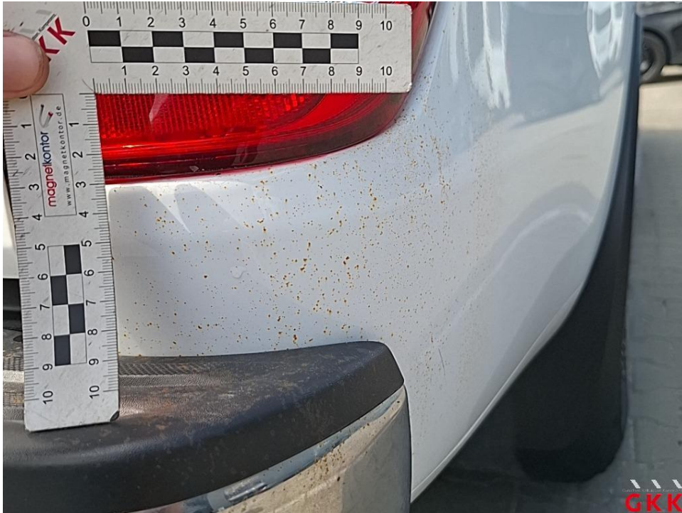
Bild 65. Seitenwand rechts, Industriestaubanhaftung / Flugrost, Smartrepair
