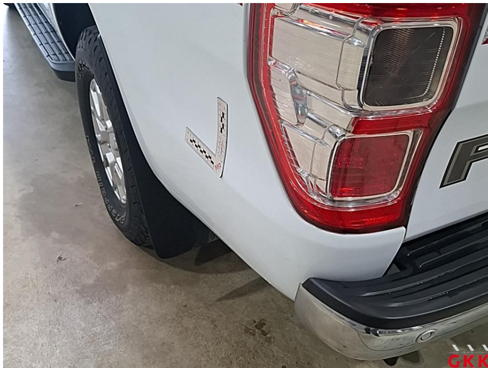
Bild 24. Seitenwand links, Reparaturmangel, Smartrepair
