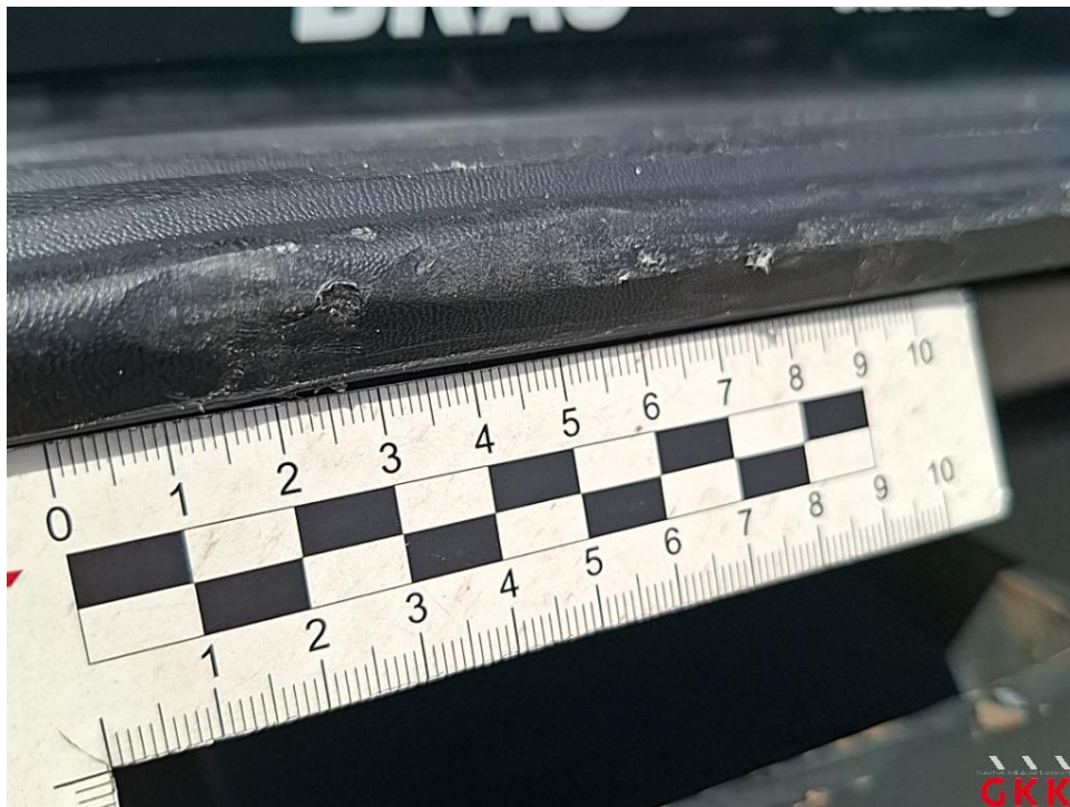
Bild 60. Stoßfänger hinten, Verkleidung oberhalb -unlackiert-, beschädigt, ersetzen
