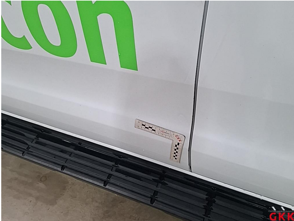
Bild 21. Tür vorne links, Kante, verkratzt, Smartrepair
