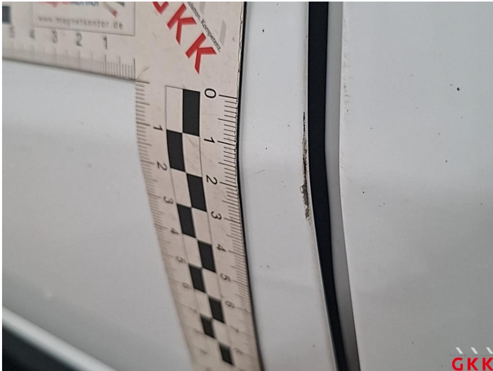
Bild 22. Tür vorne links, Kante, verkratzt, Smartrepair
