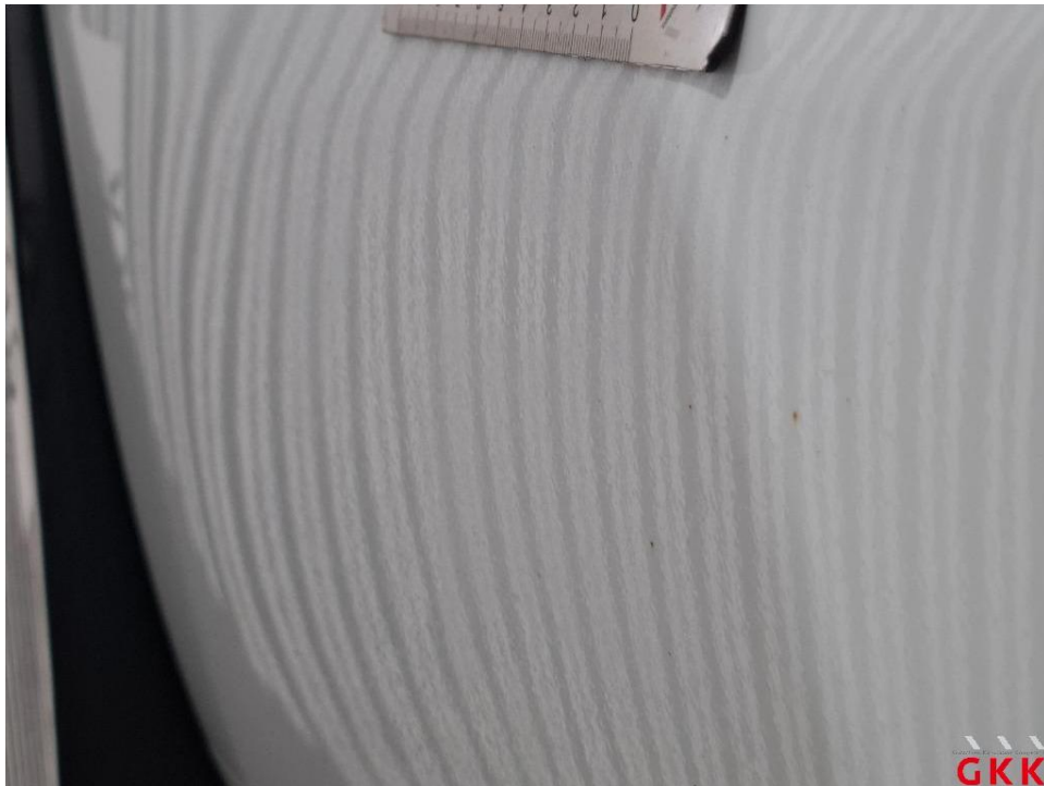
Bild 26. Seitenwand links, Reparaturmangel, Smartrepair
