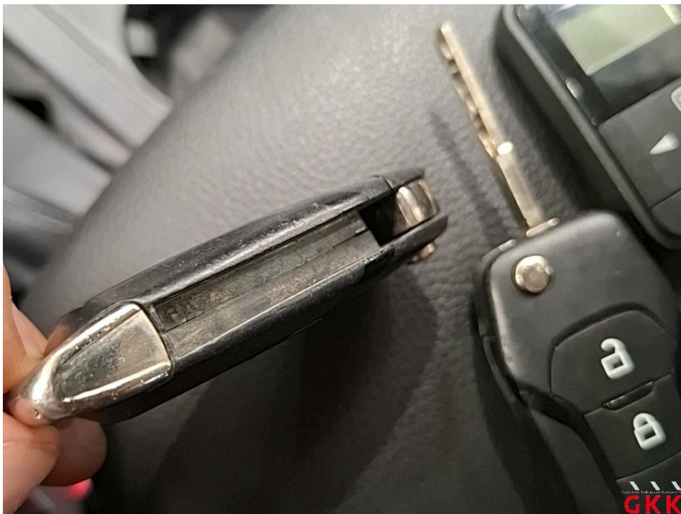
Bild 14. Hauptschlüssel, mit Fernbedienung, beschädigt, ersetzen
