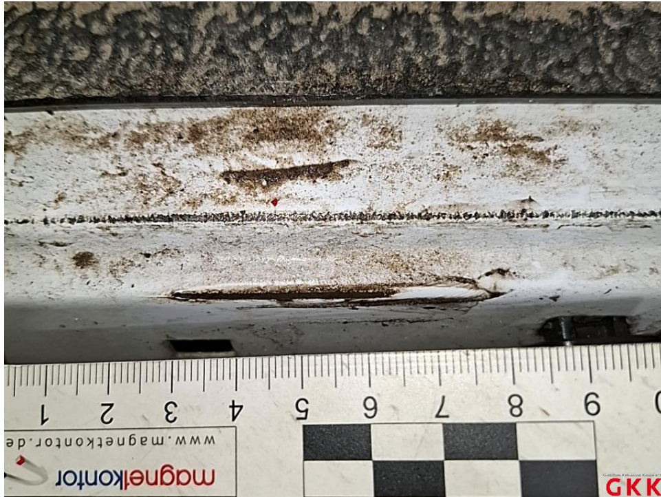
Bild 31. Ladekante, verkratzt, lackieren
