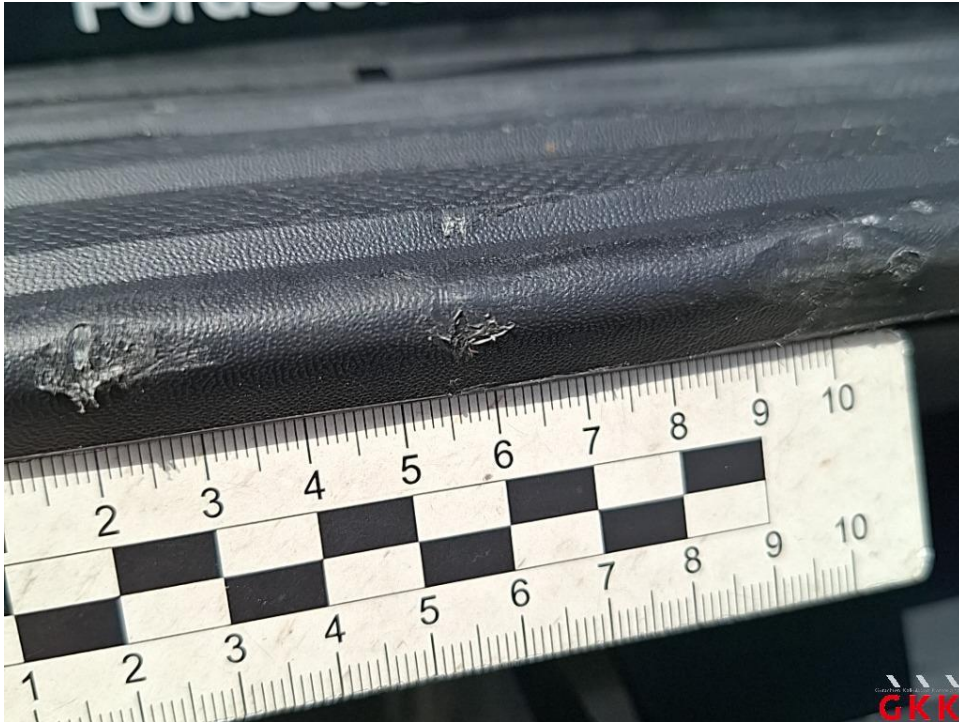
Bild 61. Stoßfänger hinten, Verkleidung oberhalb -unlackiert-, beschädigt, ersetzen
