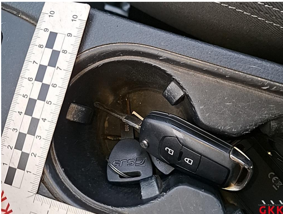
Bild 58. Mittelkonsole Getränkehalter, beschädigt, ersetzen
