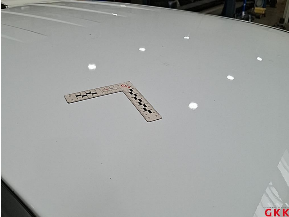
Bild 47. Dach, 4 bis 10 Dellen / Bauteil, kalt drücken
