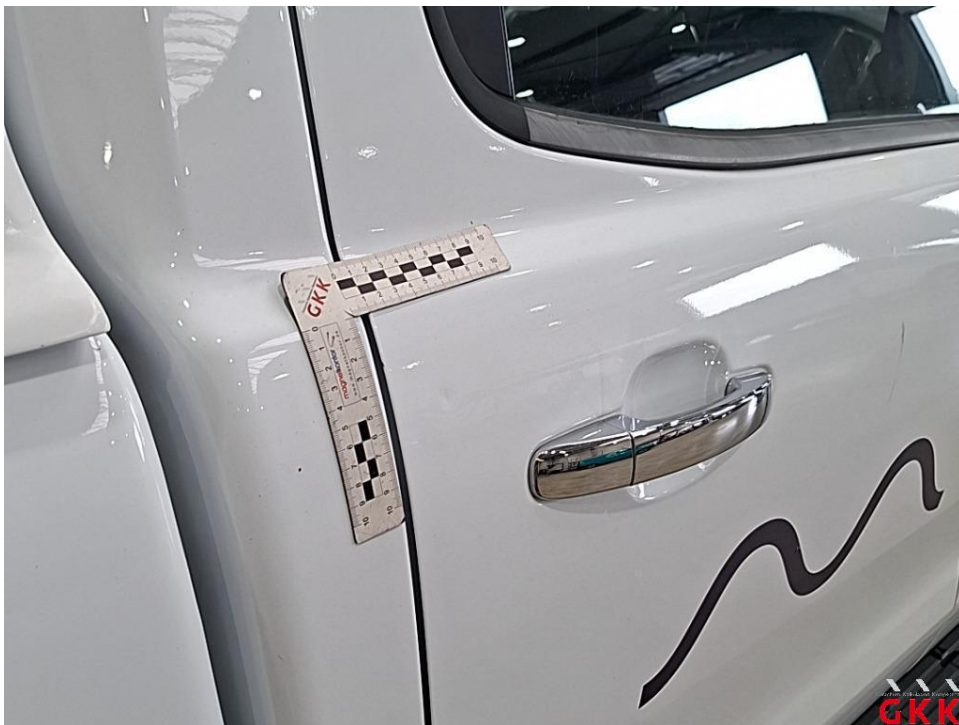
Bild 44. Tür hinten rechts, bis 3 Dellen / Bauteil, Smartrepair
