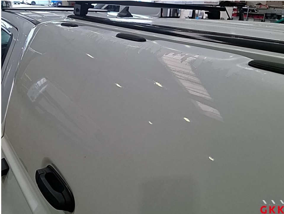
Bild 53. Kabinenaufbau hinten Tür links, Lackierung verätzt, lackieren
