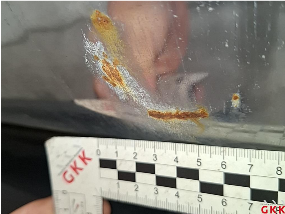
Bild 37. Stoßfänger hinten, Ecke rechts -unlackiert-, beschädigt, ersetzen
