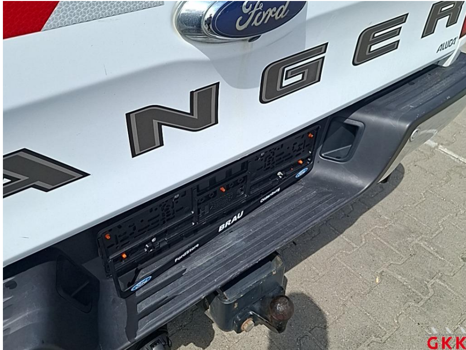
Bild 59. Stoßfänger hinten, Verkleidung oberhalb -unlackiert-, beschädigt, ersetzen
