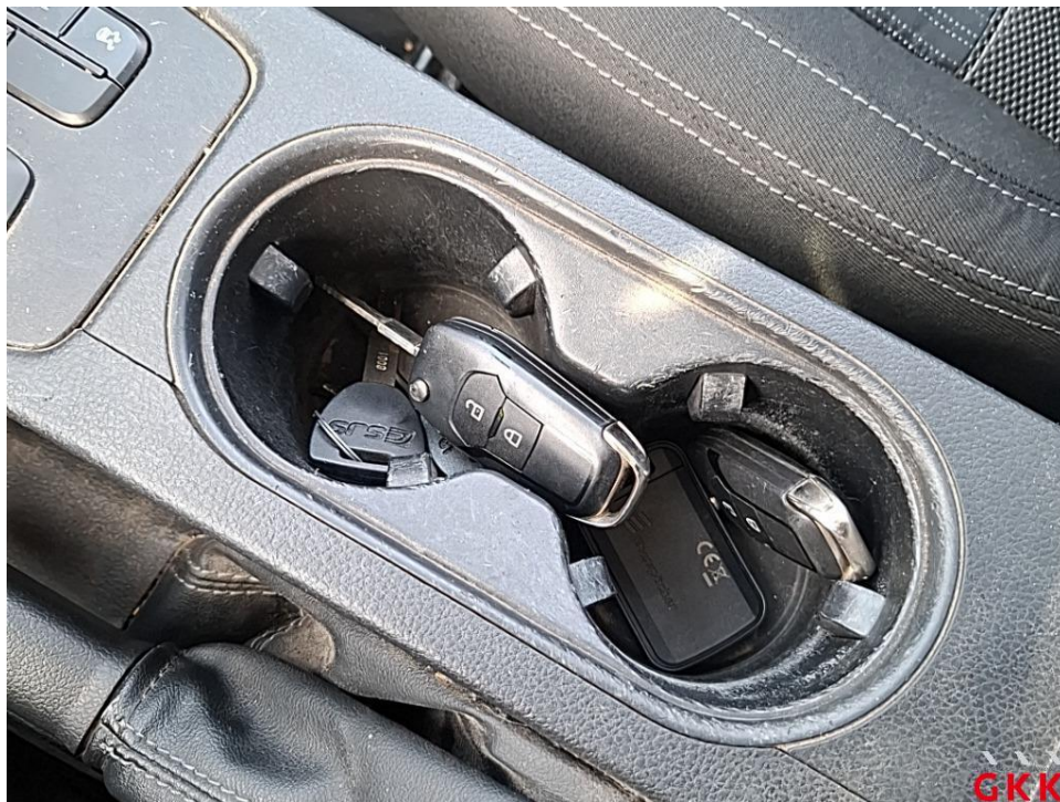
Bild 56. Mittelkonsole Getränkehalter, beschädigt, ersetzen
