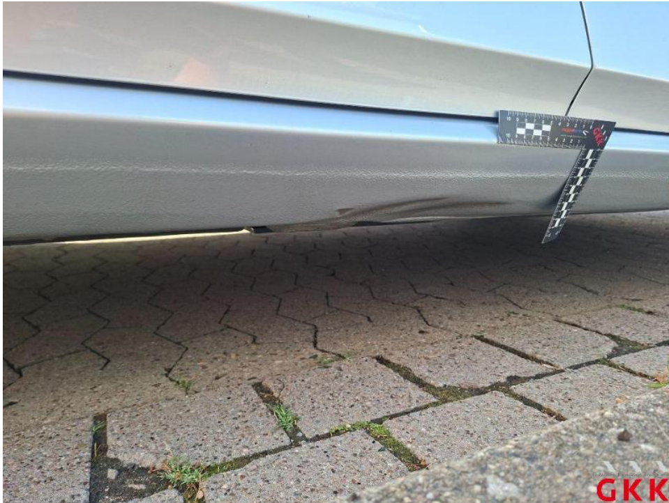
Bild 53. Schweller rechts, beschädigt, instand setzen - lackieren
