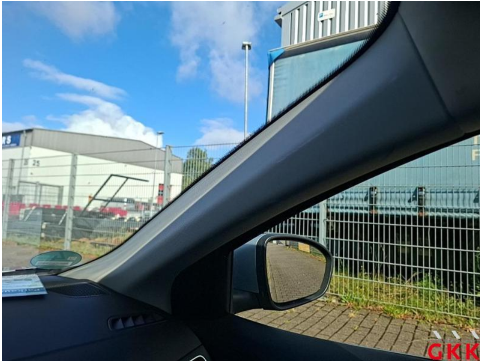
Bild 55. A- Säule rechts, Innenverkleidung, verkratzt, ersetzen
