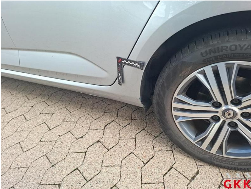
Bild 43. Seitenwand links, Reparaturmangel, instand setzen - lackieren
