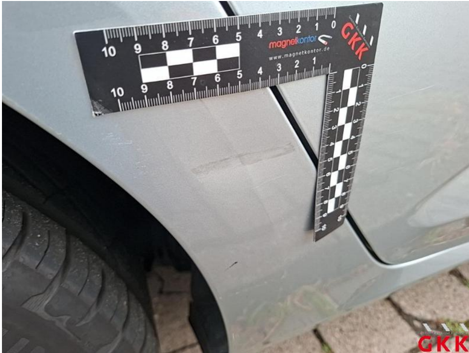
Bild 31. Seitenwand rechts, beschädigt, instand setzen - lackieren
