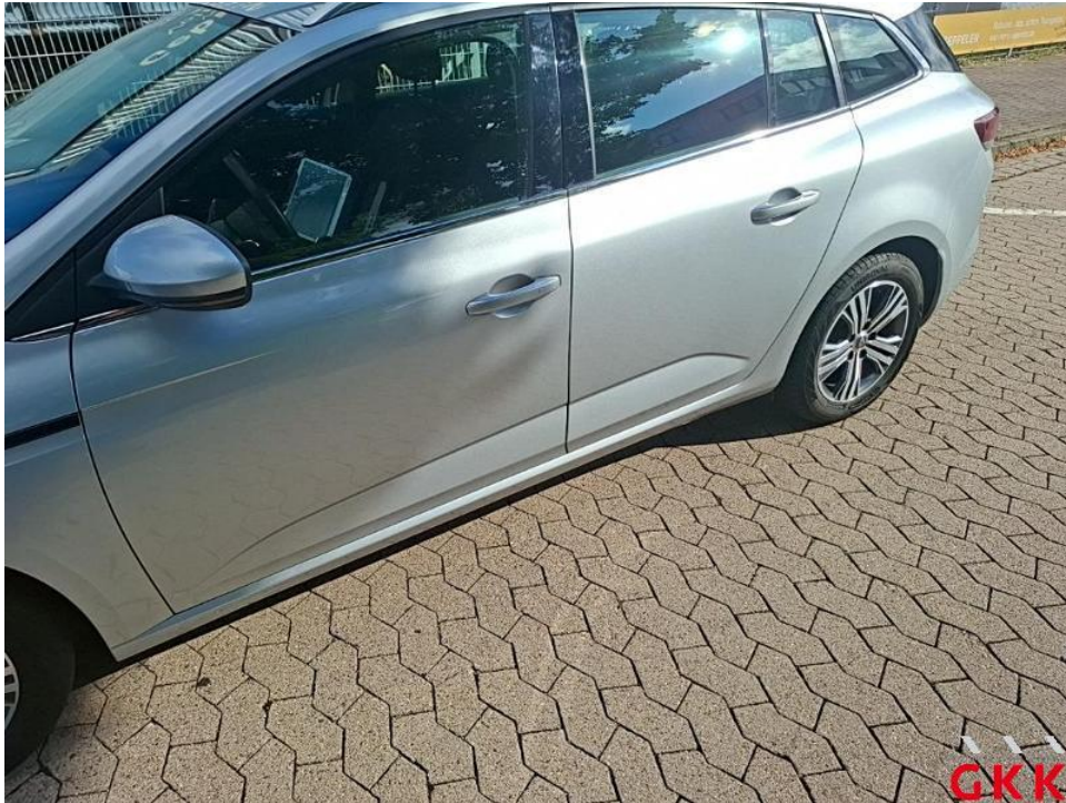
Bild 49. Tür hinten links, Reparaturmangel, lackieren
