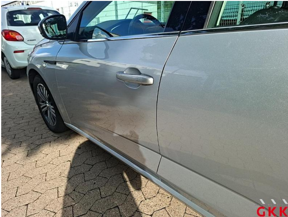
Bild 50. Tür hinten links, Reparaturmangel, lackieren
