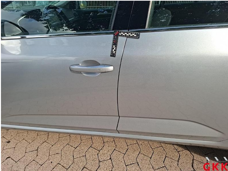
Bild 46. Tür hinten links Spaltmaß fehlerhaft, Reparaturmangel, einstellen
