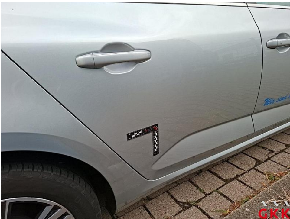
Bild 32. Tür hinten rechts, verkratzt, lackieren
