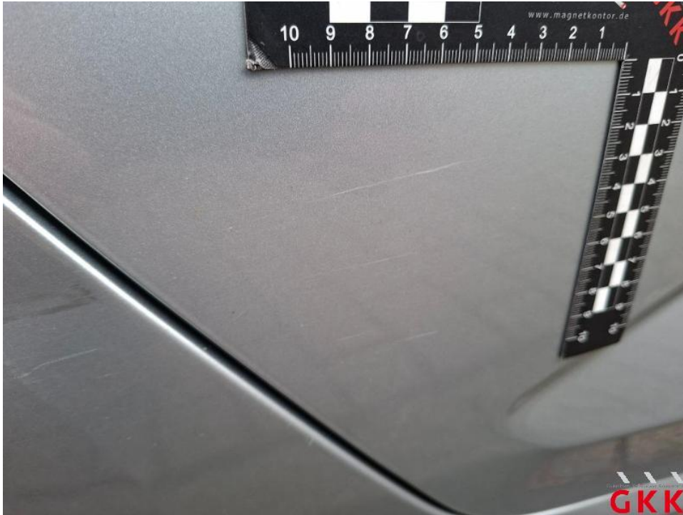
Bild 33. Tür hinten rechts, verkratzt, lackieren
