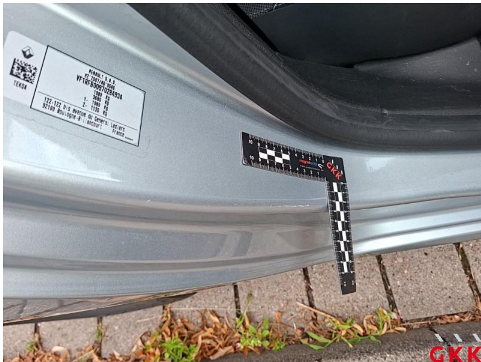
Bild 18. Tür hinten rechts, Einstieg, verkratzt, auslegen, schleifen, polieren
