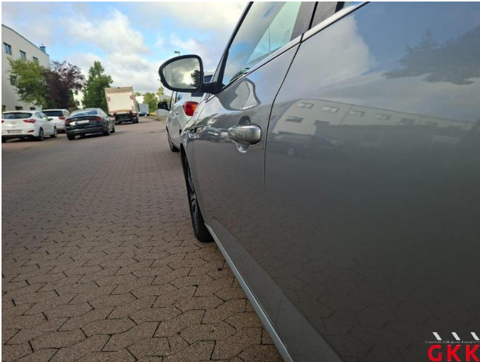
Bild 48. Tür hinten links Spaltmaß fehlerhaft, Reparaturmangel, einstellen
