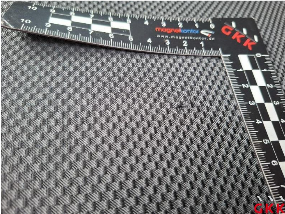
Bild 25. Sitz vorne links, Bezug Sitzkissen -Stoff-, beschädigt, ersetzen
