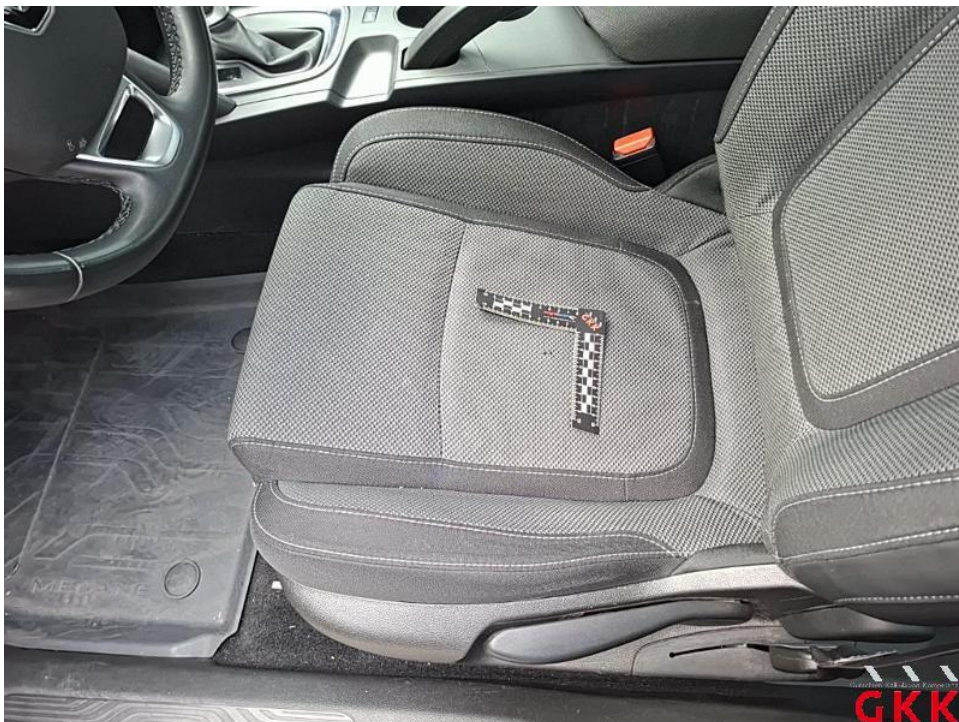
Bild 24. Sitz vorne links, Bezug Sitzkissen -Stoff-, beschädigt, ersetzen
