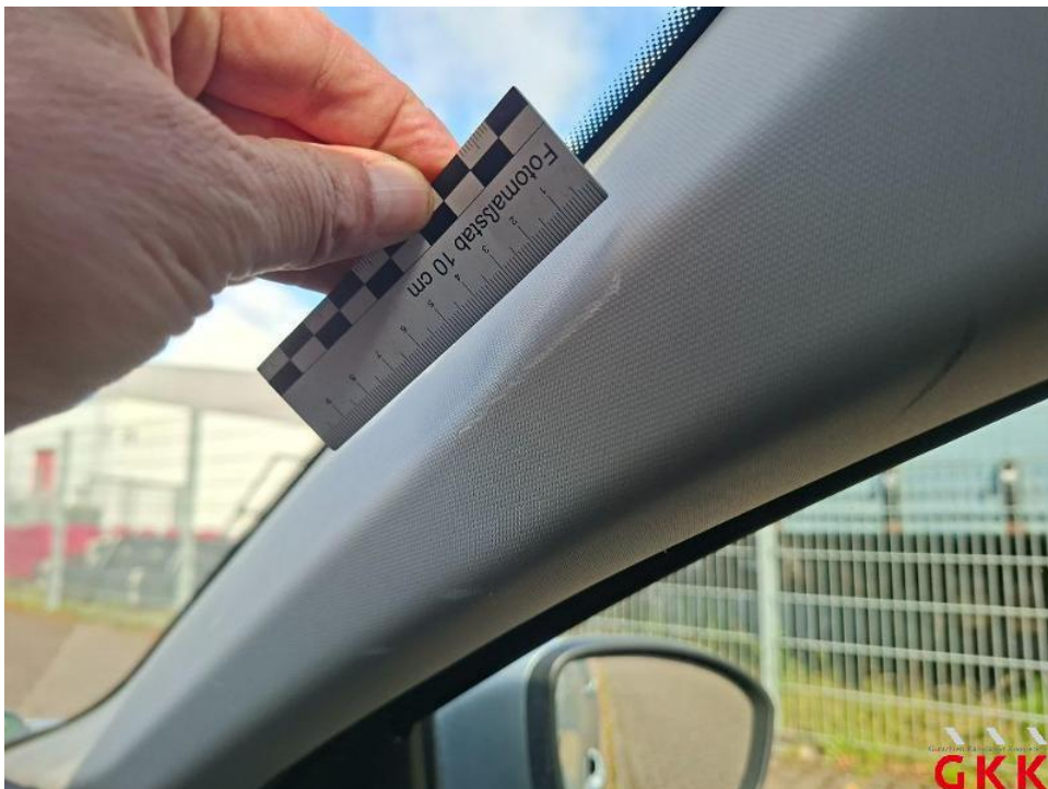
Bild 56. A- Säule rechts, Innenverkleidung, verkratzt, ersetzen
