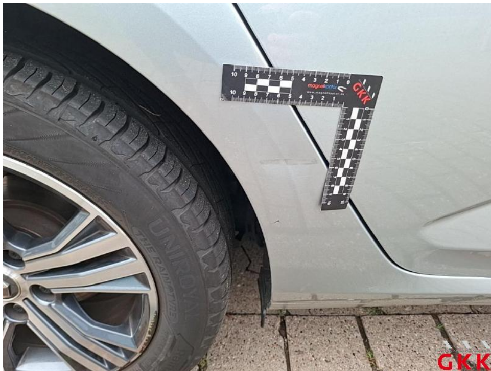
Bild 30. Seitenwand rechts, beschädigt, instand setzen - lackieren
