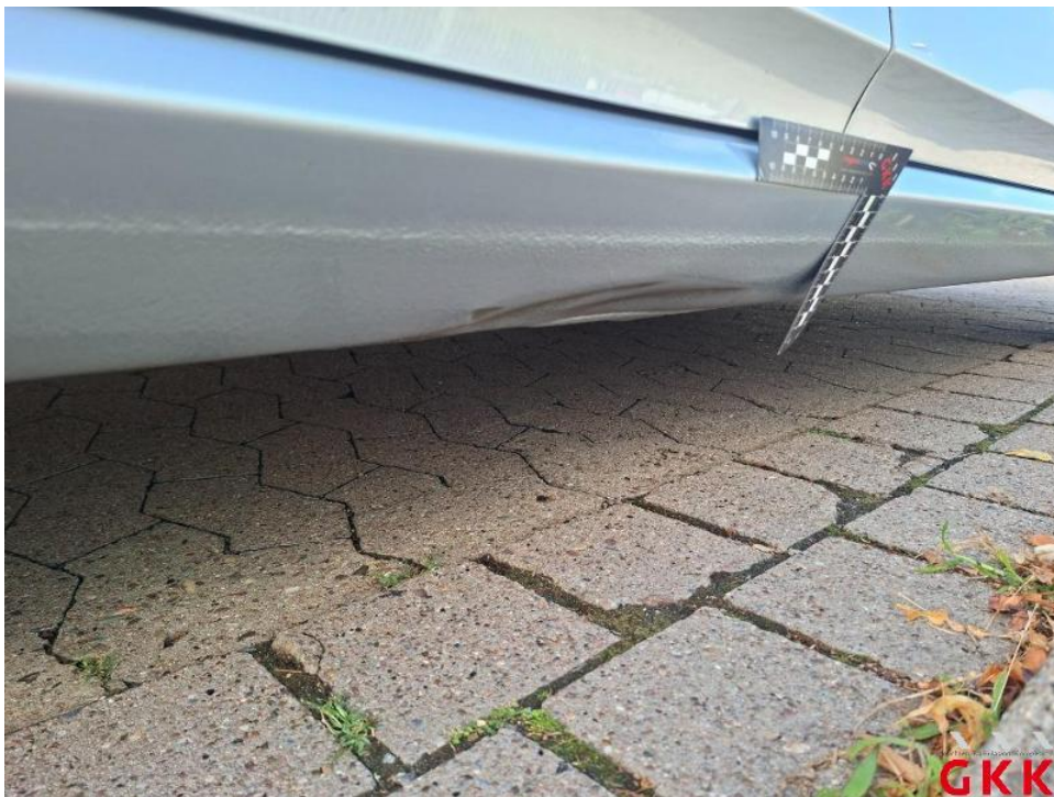
Bild 54. Schweller rechts, beschädigt, instand setzen - lackieren
