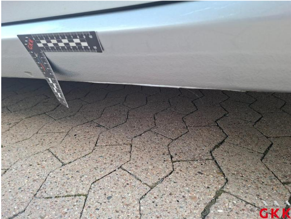
Bild 45. Seitenwand links, Reparaturmangel, instand setzen - lackieren
