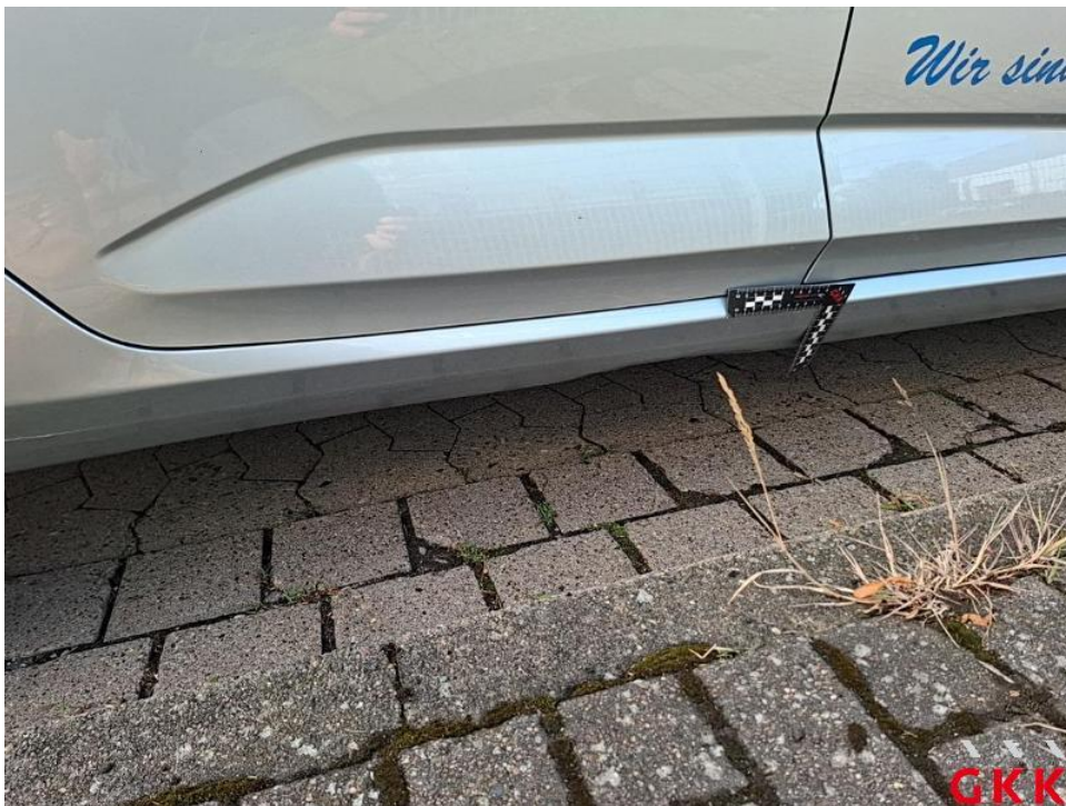
Bild 52. Schweller rechts, beschädigt, instand setzen - lackieren
