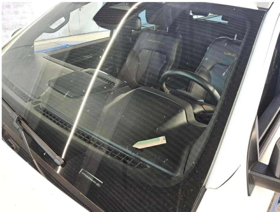
Bild 16 : Frontscheibe, Steinschlag, Gebrauchsspur
