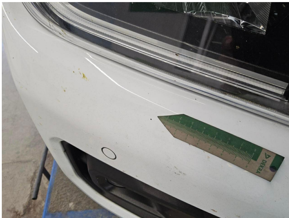
Bild 15 : Stoßfänger vorne Lackierung, Steinschlag, Gebrauchsspur
