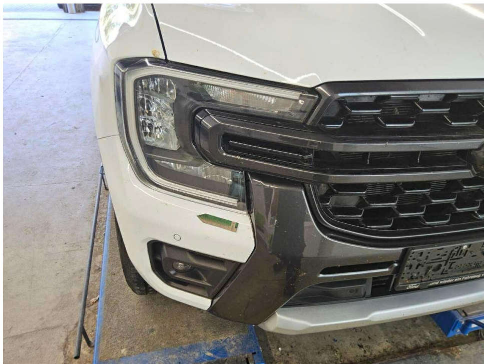
Bild 14 : Stoßfänger vorne Lackierung, Steinschlag, Gebrauchsspur
