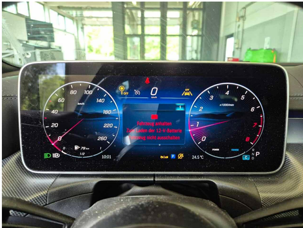
Bild 17 : 12 Volt Batterie tiefentladen, Fahrzeug nur mit Starthilfe startbar, Batterie ersetzen
