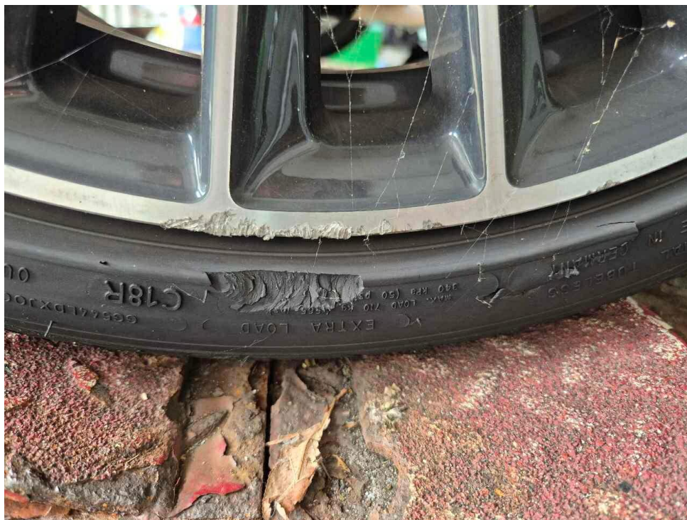
Bild 18 : LM-Felge hinten rechts verschrammt (glanzgedreht)
