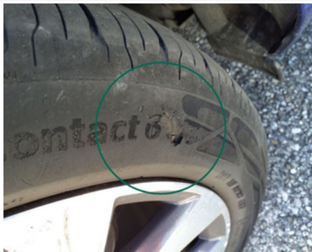
Pneu / Arrière Droit / Déchiré
