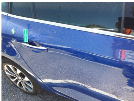
Porte / Arrière Droit / Enfoncement
