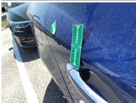
Porte / Arrière Droit / Enfoncement
