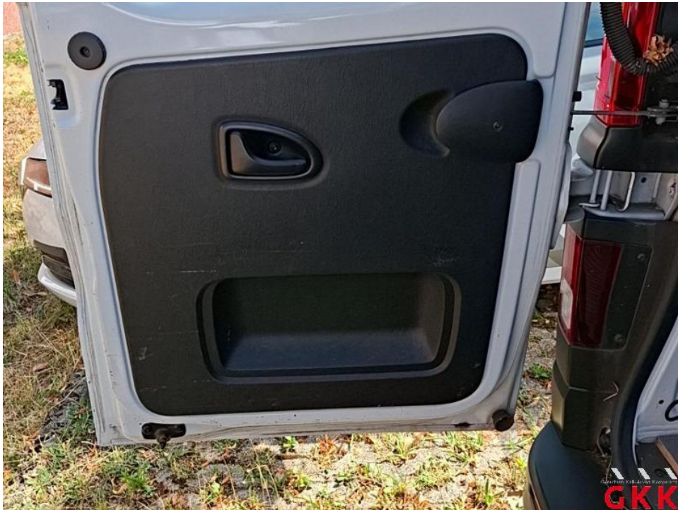
Bild 68. Hecktür links, Innenverkleidung, verkratzt, ersetzen
