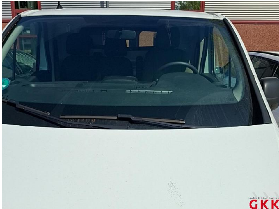
Bild 39. Frontscheibe, Steinschlag im Sichtfeld, ersetzen
