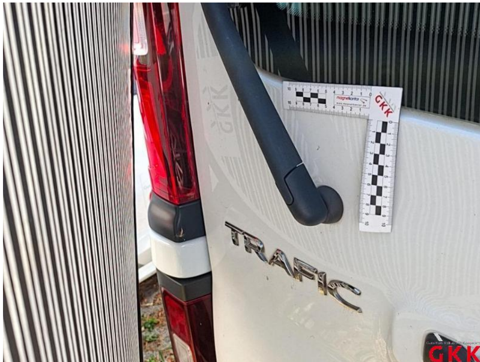
Bild 73. Hecktür links, beschädigt, instand setzen - lackieren
