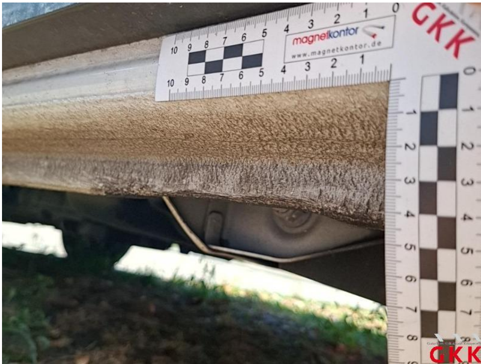
Bild 37. Schweller links, beschädigt, instand setzen - lackieren
