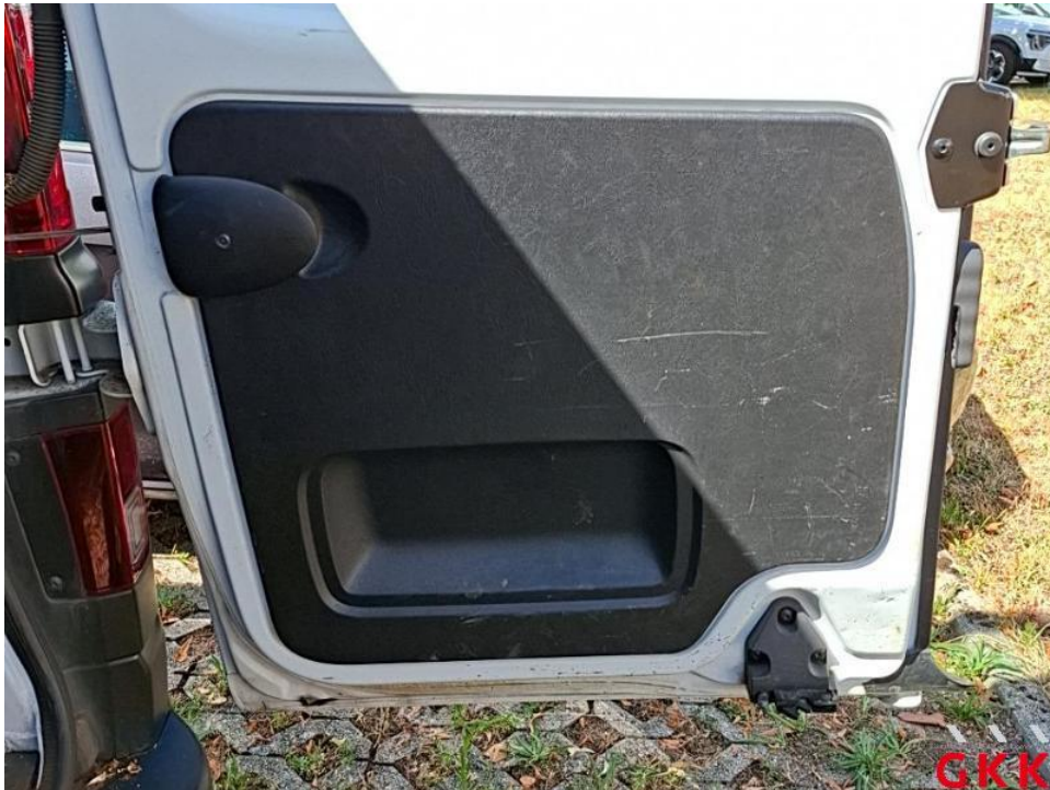
Bild 60. Hecktür rechts, Innenverkleidung, verkratzt, ersetzen
