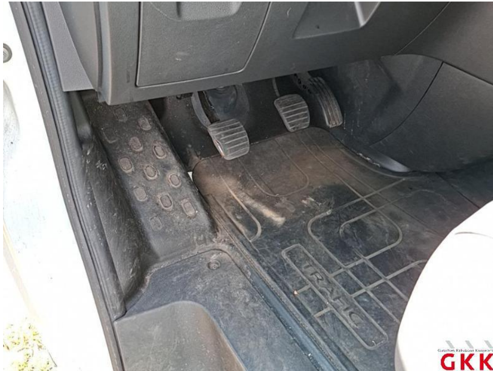
Bild 24. Kupplungspedal, Pedalgummi, beschädigt, ersetzen
