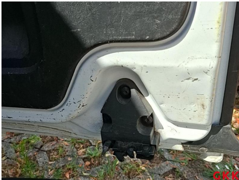
Bild 84. Hecktür rechts, innen, beschädigt, instand setzen - lackieren
