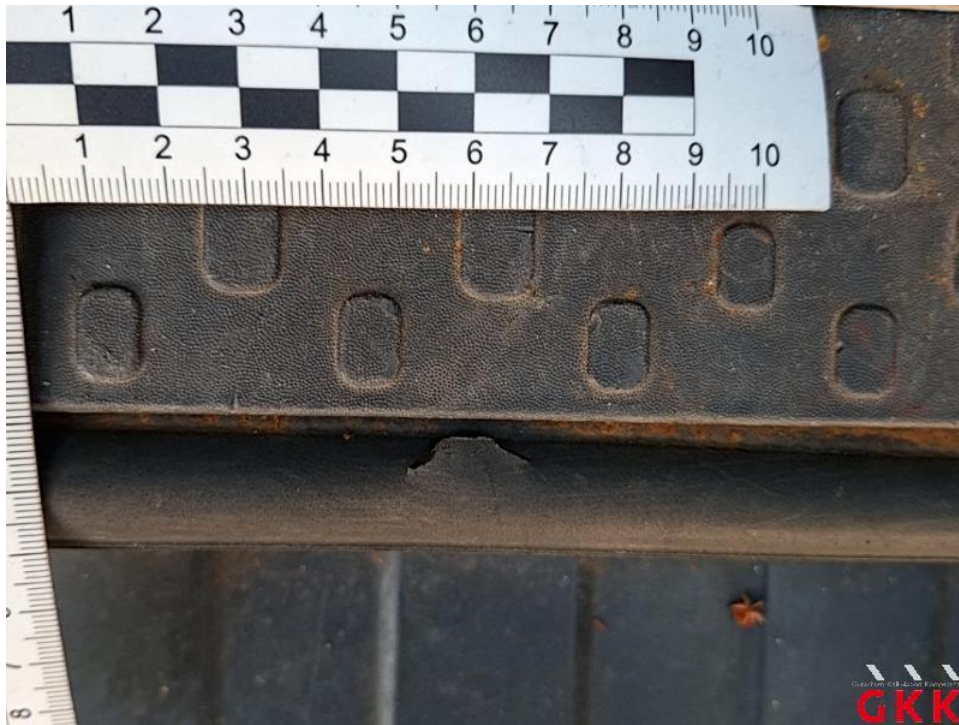
Bild 63. Laderaum, Dichtung, beschädigt, ersetzen
