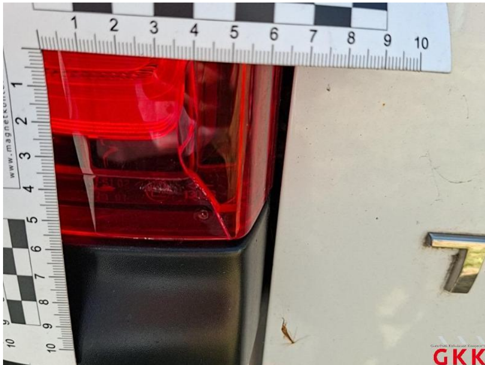
Bild 79. Rückleuchte links, außen, beschädigt, ersetzen
