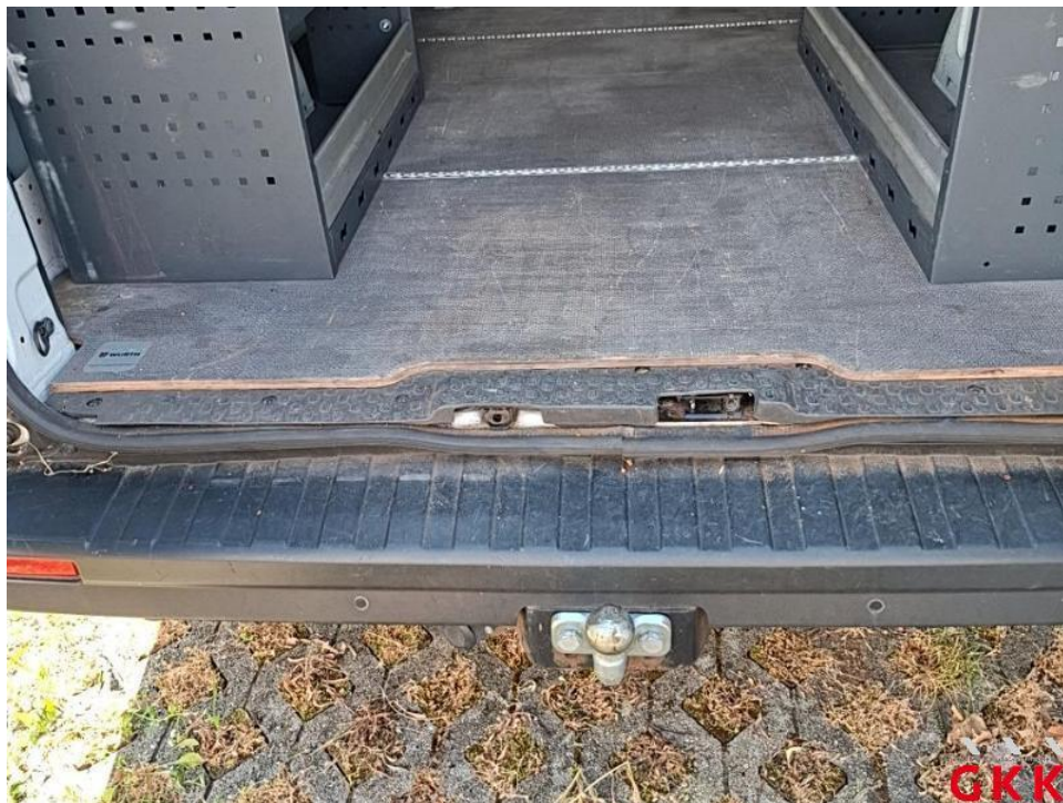
Bild 70. Stoßfänger hinten, Verkleidung -unlackiert-, beschädigt, ersetzen
