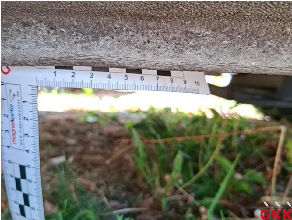
Bild 51. Schweller rechts, beschädigt, instand setzen - lackieren
