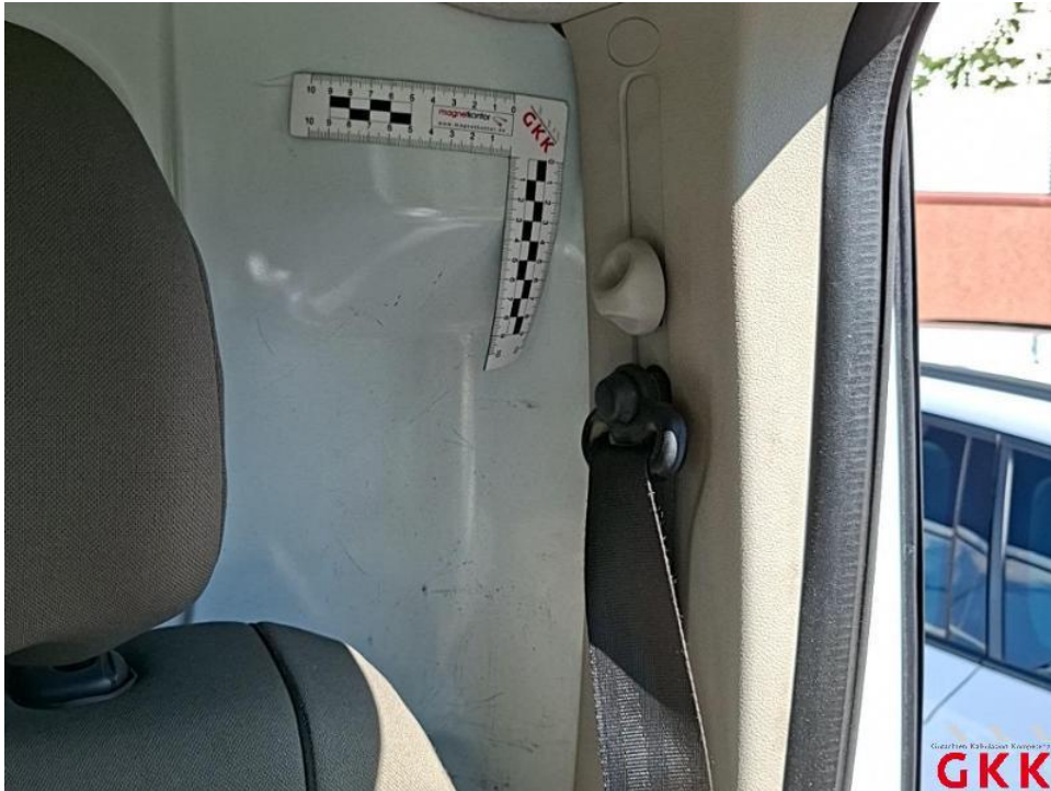
Bild 19. Trennwand, verkratzt, Smartrepair
