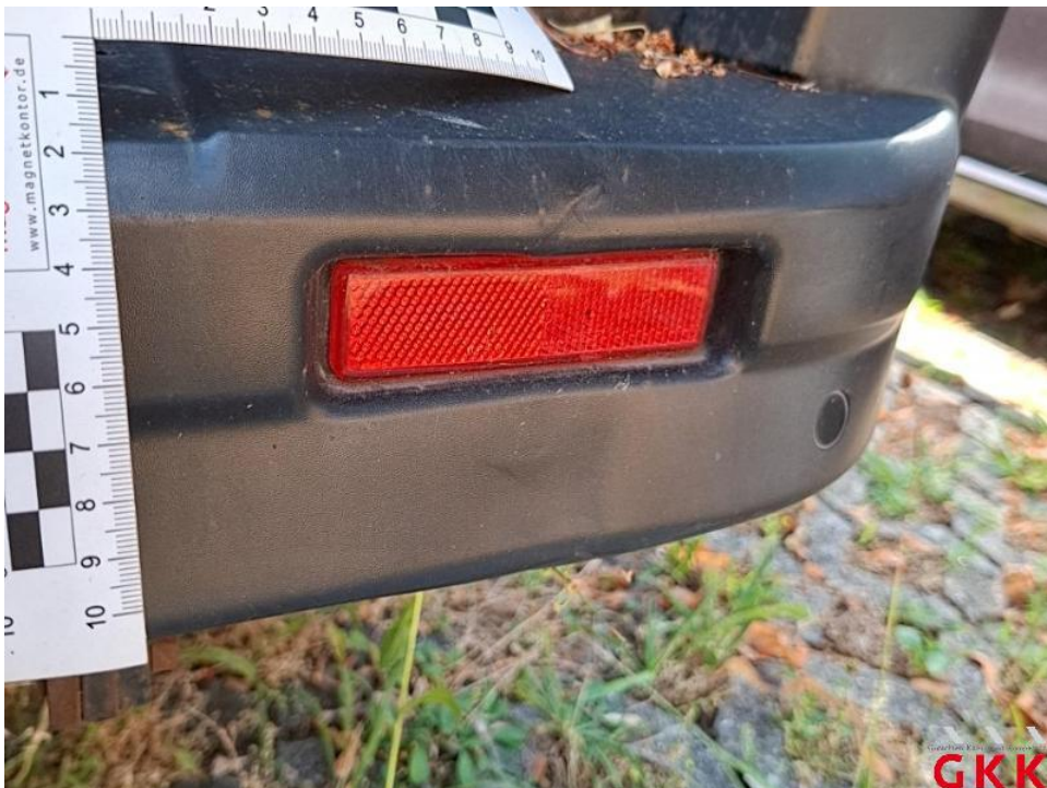
Bild 72. Stoßfänger hinten, Verkleidung -unlackiert-, beschädigt, ersetzen
