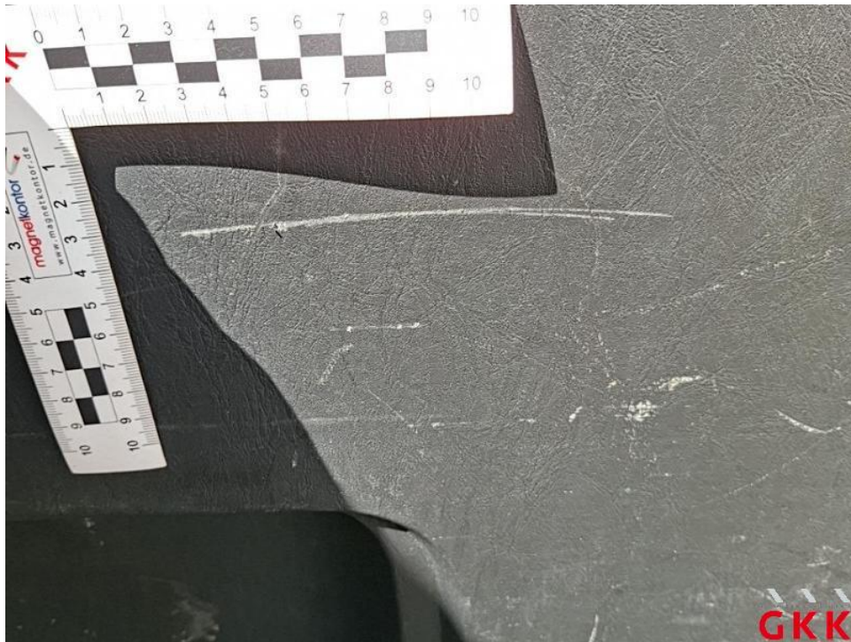
Bild 61. Hecktür rechts, Innenverkleidung, verkratzt, ersetzen
