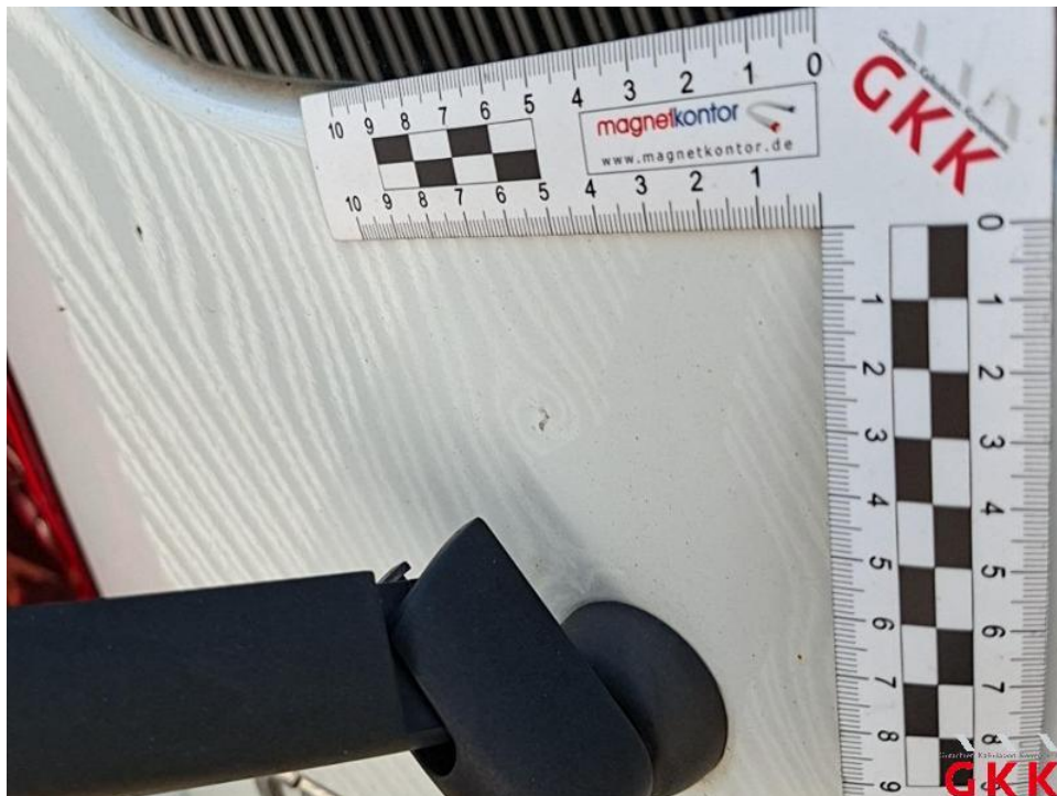
Bild 74. Hecktür links, beschädigt, instand setzen - lackieren
