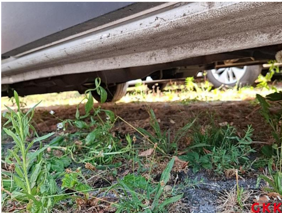
Bild 50. Schweller rechts, beschädigt, instand setzen - lackieren
