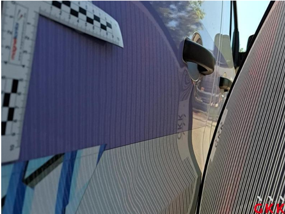
Bild 57. Schiebetür rechts, bis 3 Dellen / Bauteil, kalt drücken
