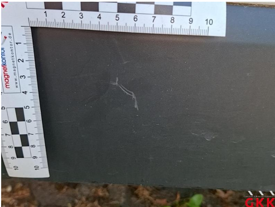
Bild 54. Tür vorne rechts, Leiste -unten-, verkratzt, Smartrepair
