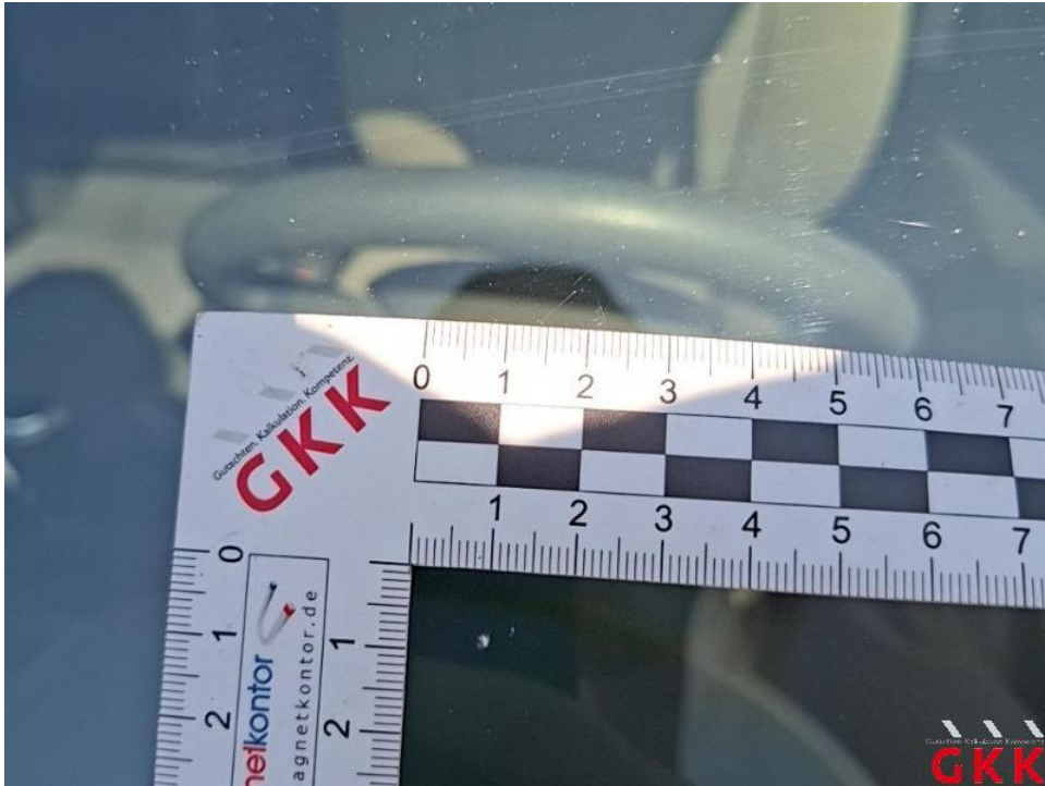
Bild 41. Frontscheibe, Steinschlag im Sichtfeld, ersetzen
