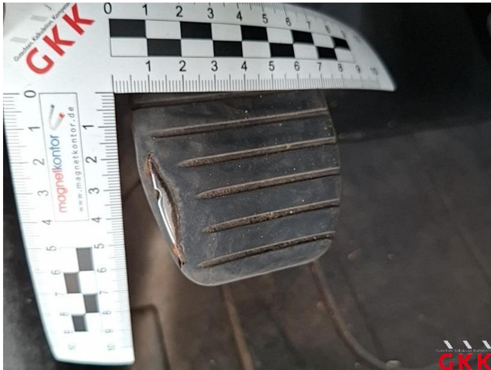
Bild 25. Kupplungspedal, Pedalgummi, beschädigt, ersetzen
