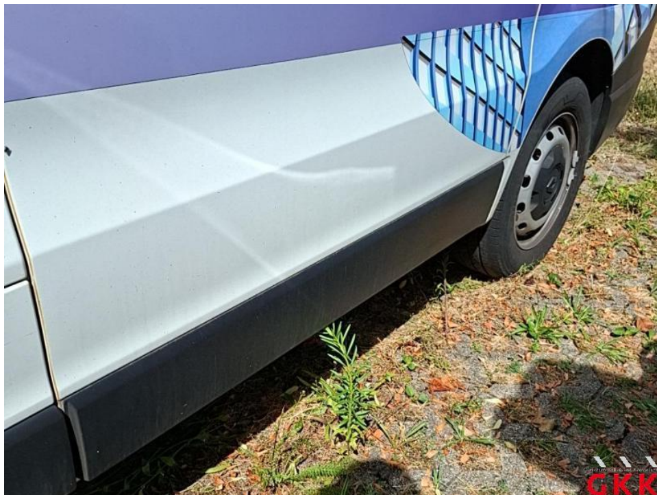
Bild 80. Seitenwand links, Leiste -unten-, verkratzt, ersetzen
