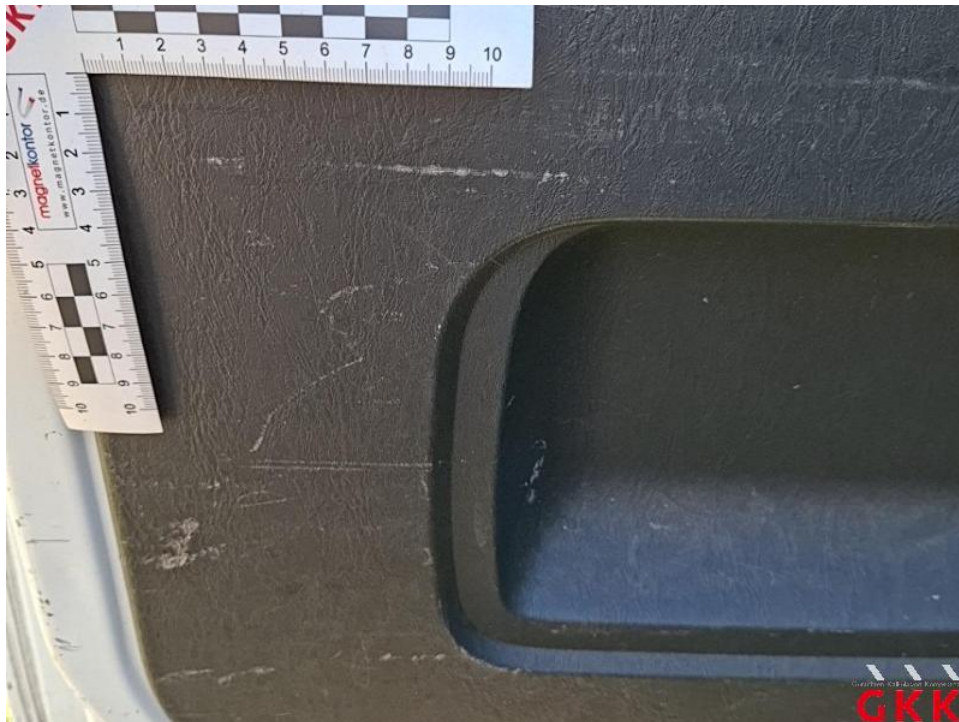
Bild 69. Hecktür links, Innenverkleidung, verkratzt, ersetzen
