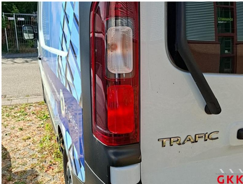
Bild 78. Rückleuchte links, außen, beschädigt, ersetzen
