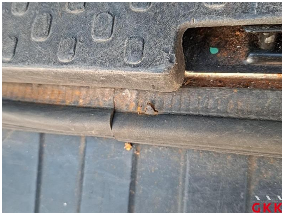
Bild 64. Laderaum, Dichtung, beschädigt, ersetzen
