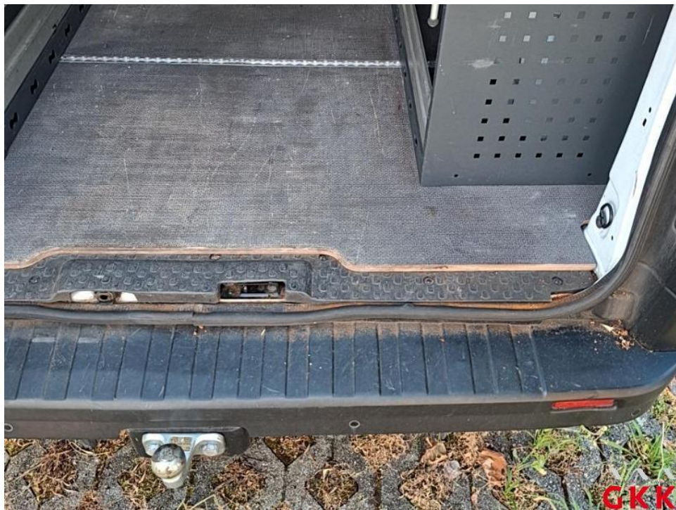
Bild 62. Laderaum, Dichtung, beschädigt, ersetzen
