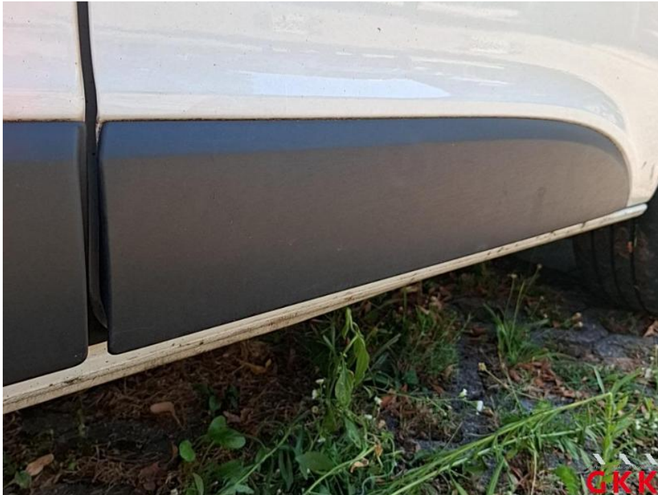
Bild 53. Tür vorne rechts, Leiste -unten-, verkratzt, Smartrepair
