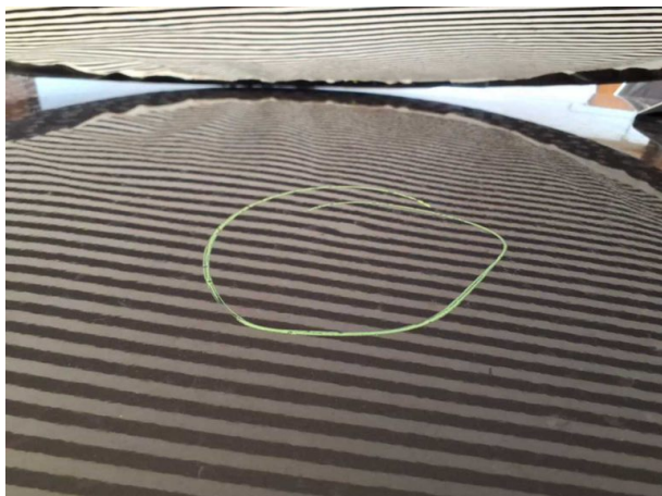
Beschädigung #2: Fahrzeugdach: Dach - Delle(n) - sanft instandsetzen
