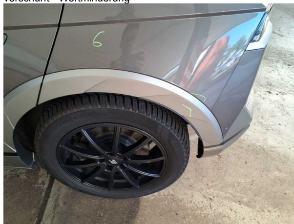
Beschädigung #6: Seitenwand links: Radhausverbreiterung - verkratzt / verschürft - Wertminderung
