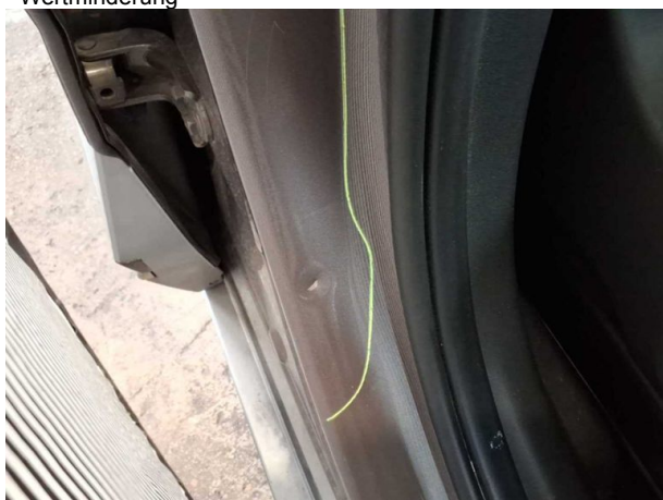
Beschädigung #10: Schweller rechts: Einstieg - Delle / Lackschaden - Smart Repair
