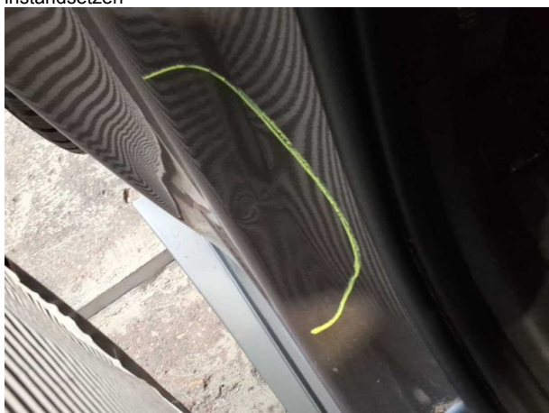
Beschädigung #4: Seitenwand rechts: Einstieg - Delle(n) - sanft instandsetzen
