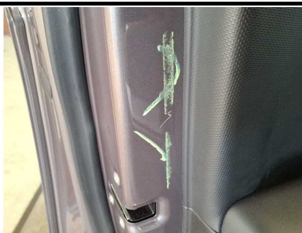
Beschädigung #8: Tür vorn links: Tür - verkratzt / verschürft - Smart Repair
