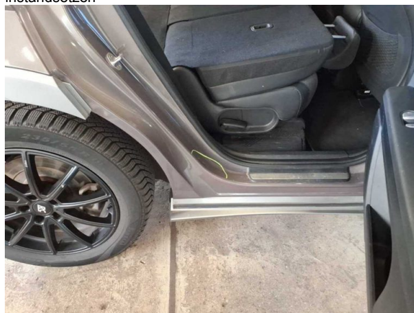
Beschädigung #4: Seitenwand rechts: Einstieg - Delle(n) - sanft instandsetzen
