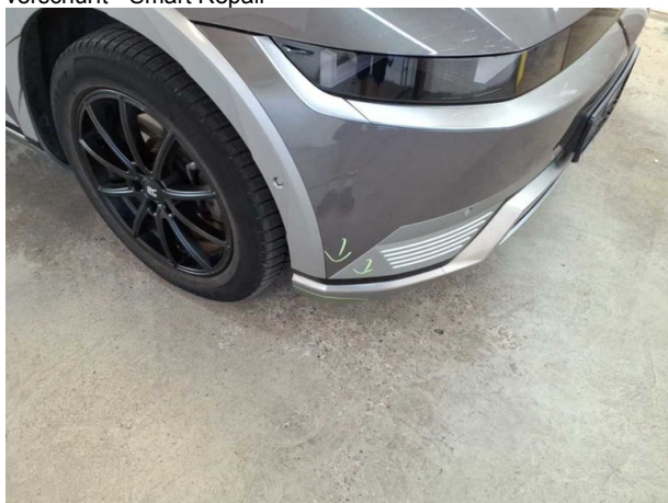
Beschädigung #9: Stossfänger vorn: Spoiler - verkratzt / versch... - Wertminderung
