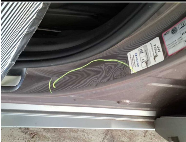
Beschädigung #12: Schweller links: Einstieg - Delle / Lackschad... - Smart Repair
