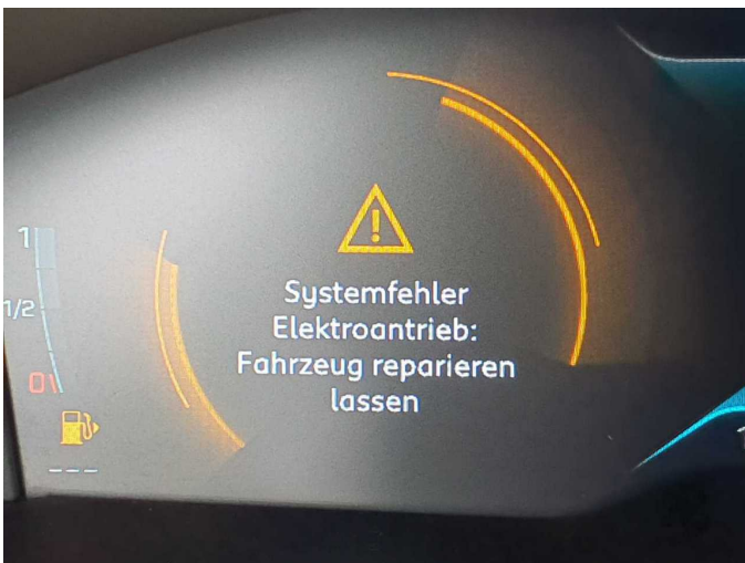
Damage 9: Instrument panel: Indicator light (Systemfehler Elektroantrieb) - on - Perform diagnosis
