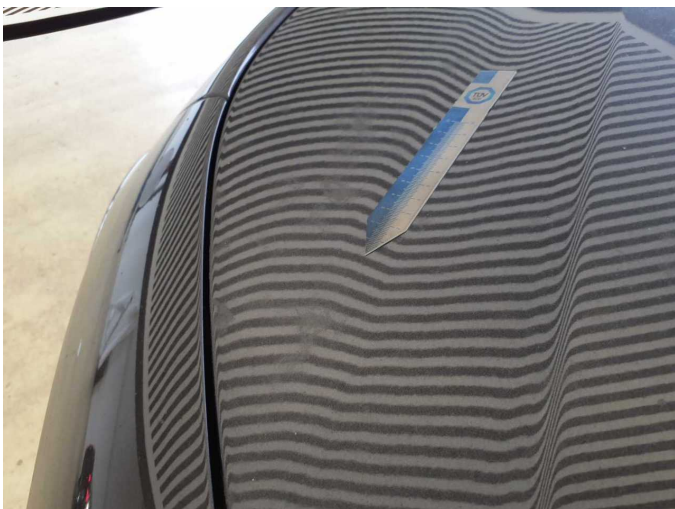
Damage 15: Bonnet: Bonnet (Anätzung) - Paint defect - Repair and paint
