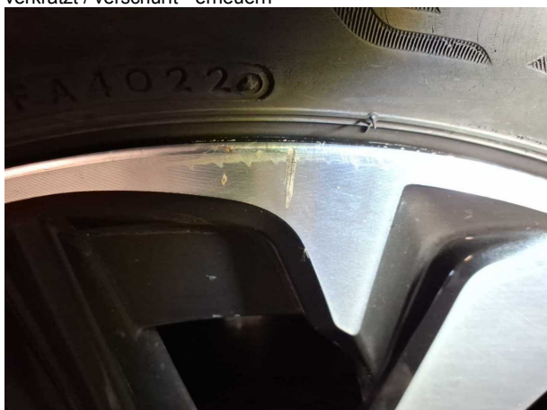
Beschädigung #2: Rad/Reifen: Leichtmetallfelge vorn rechts - Kratz... erneuern
