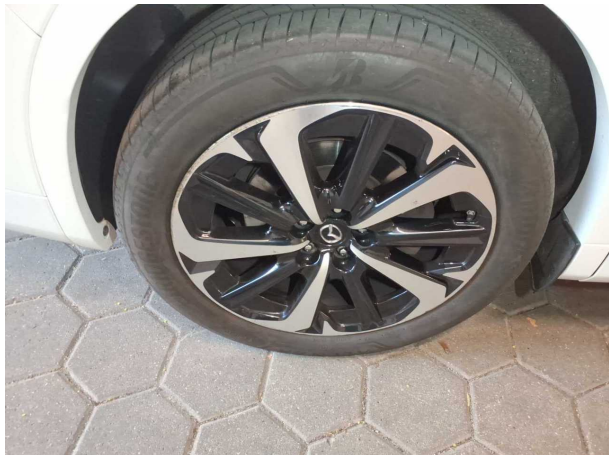
Beschädigung #1: Rad/Reifen: Leichtmetallfelge hinten rechts - verkratzt / verschürft - erneuern
