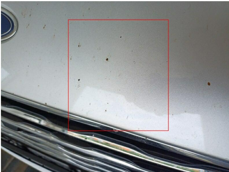
Bild 17 : Motorhaube Lackierung, viele Steinschläge, lackieren mit Lackaufbau
