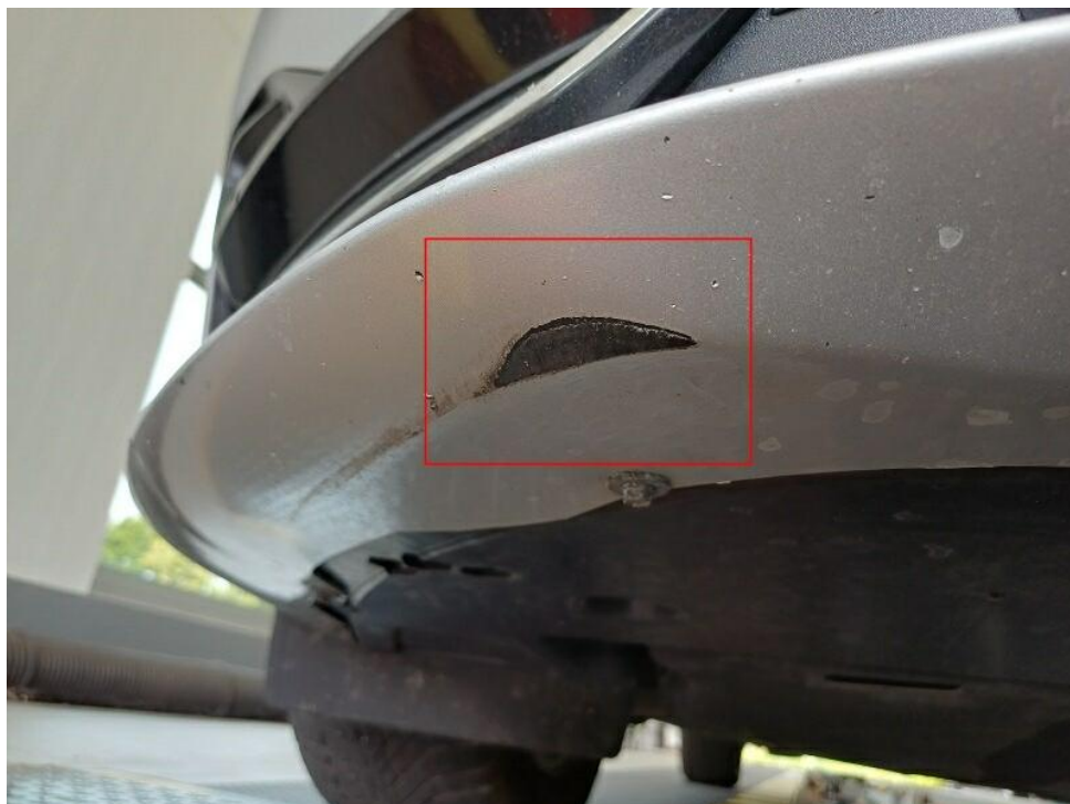
Bild 15 : Stoßfänger vorne Lackierung, verschrammt, lackieren mit Lackaufbau
