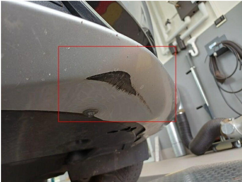
Bild 16 : Stoßfänger vorne Lackierung, verschrammt, lackieren mit Lackaufbau
