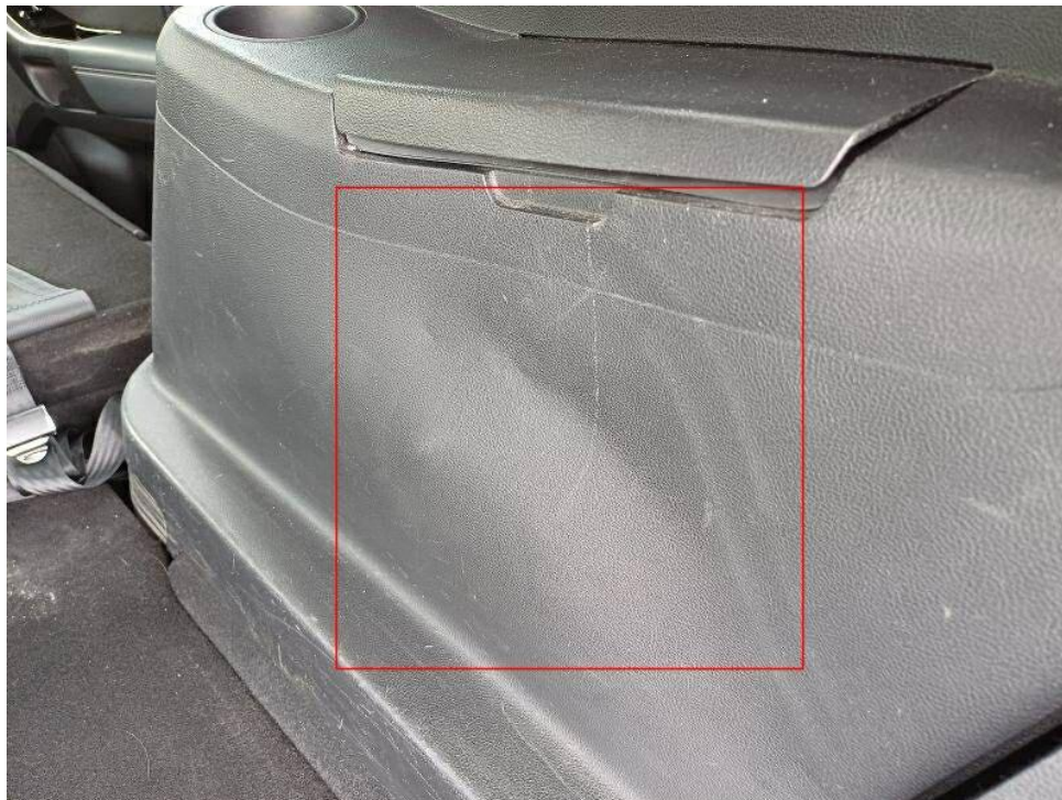
Bild 21 : Verkleidung Laderaum rechts deformiert
