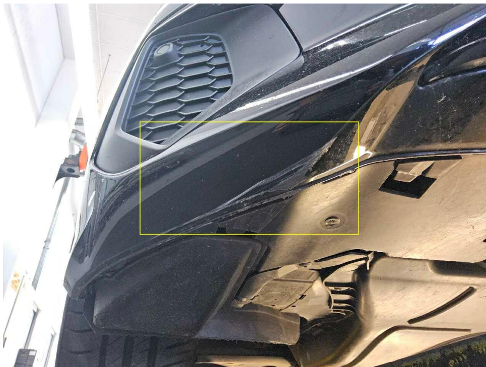
Bild 15 : Stoßfänger vorne, zerkratzt
