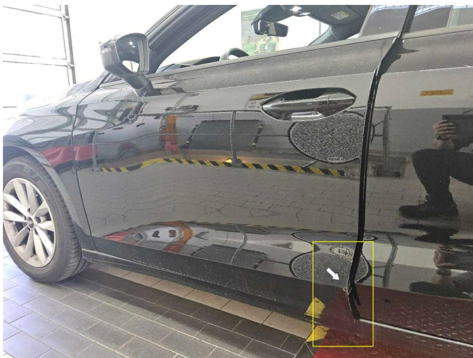
Bild 18 : Tür vorne links Kante, zerkratzt
