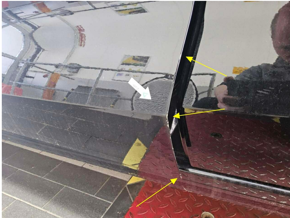
Bild 19 : Tür vorne links Kante, zerkratzt
