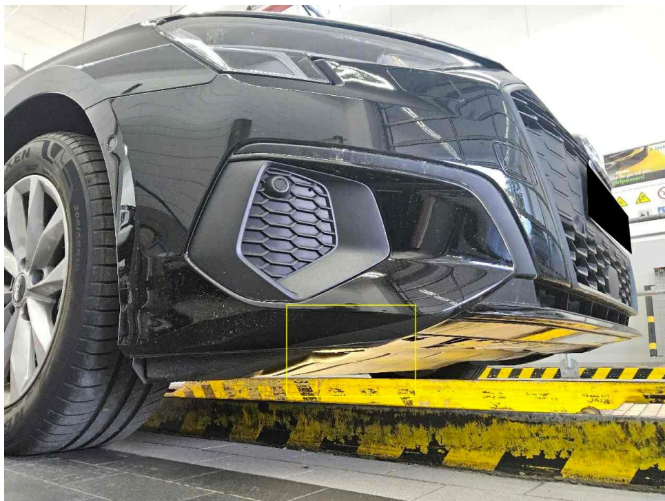
Bild 14 : Stoßfänger vorne, zerkratzt
