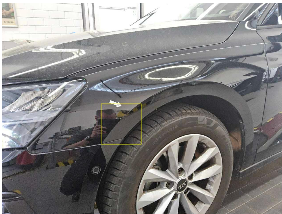
Bild 16 : Kotflügel vorne links, zerkratzt (oberflächlich)
