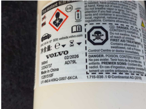
Beschädigung #2: Ausrüstung: Tirefit Füllmittel - abgelaufen - erneuern
