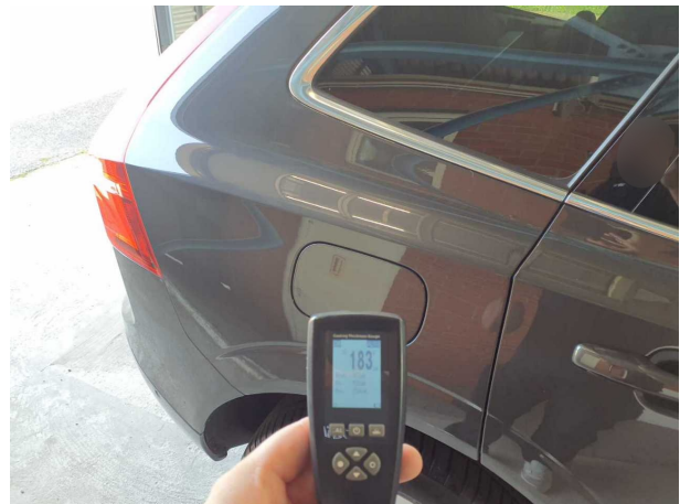
Nachlackierung 2: Seitenwand rechts
