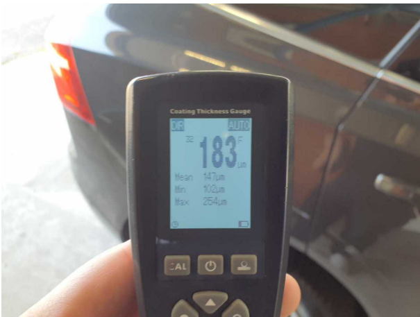
Nachlackierung 2: Seitenwand rechts
