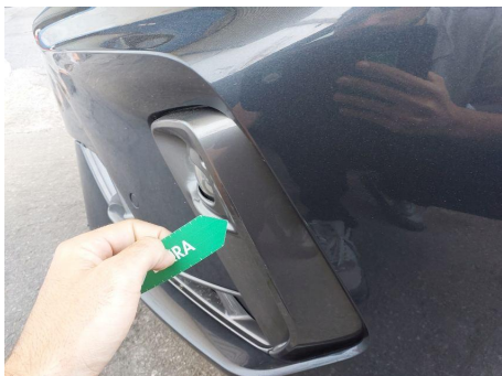
Moldura de paragolpes / Delantero izquierdo / Ralladura
