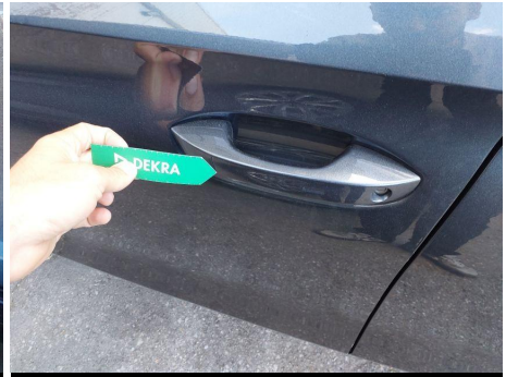
Manetas de puerta / Delantero Izquierdo / Ralladura
