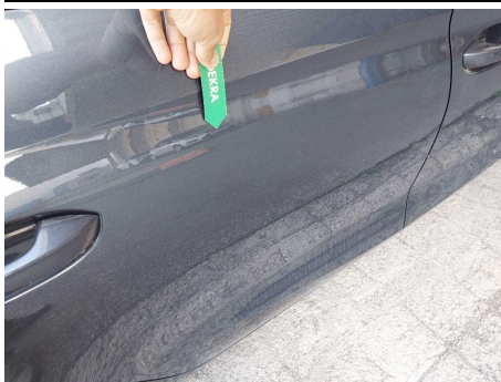
Puerta / Trasero Derecho / Abolladura
