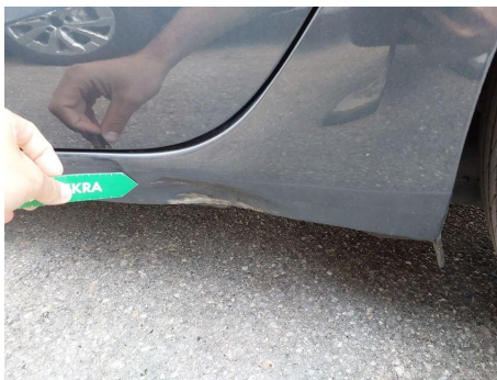
Peldaño / Izquierda / Abolladura
