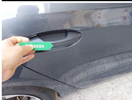
Manetas de puerta / Trasero Derecho / Ralladura
