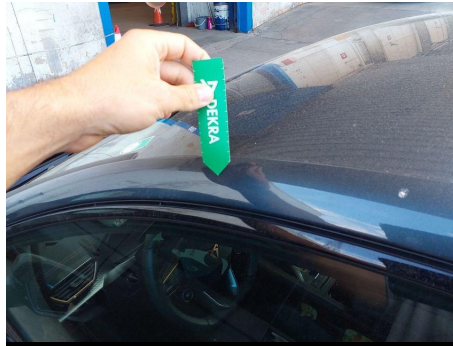
Poste de techo A / B / C / Izquierda / Abolladura
