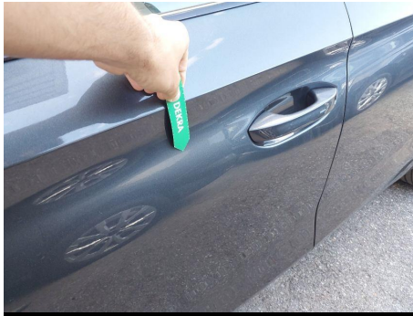
Puerta / Delantero Izquierdo / Abolladura
