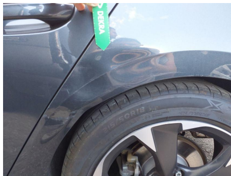
Puerta / Trasero Izquierdo / Abolladura
