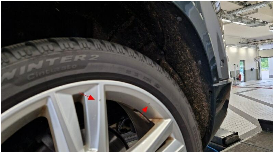
Bild 16 : Felge hinten links Lackierung, zerkratzt, Gebrauchsspur
