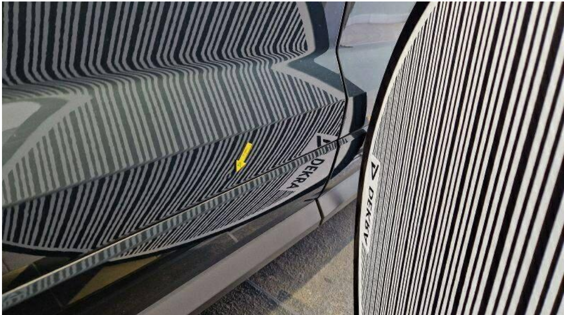
Bild 15 : Tür hinten rechts, eingedellt, Gebrauchsspur
