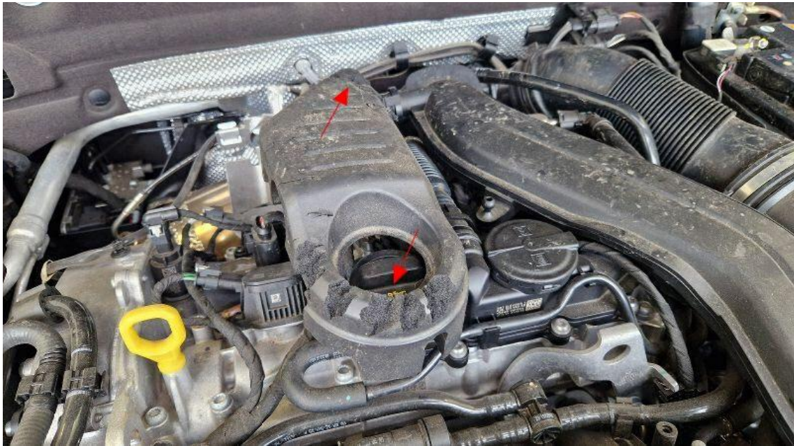
Bild 13 : Adeckung Motor/Ölabschneider beschädigt (Tierbiss)
