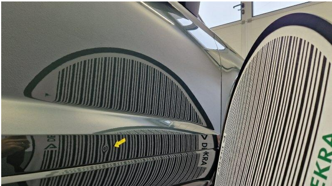
Bild 14 : Tür vorne rechts, eingedellt, drücken
