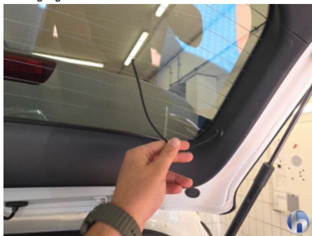
3. Hutablage Befestigung Schadhft - Erneuern
