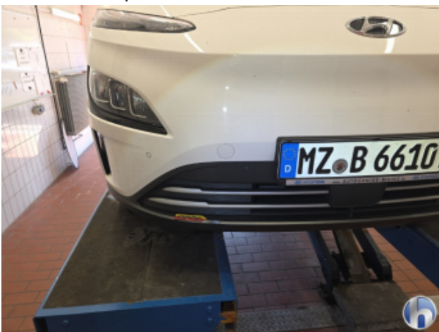
2. Frontspoiler Riss - Erneuern
