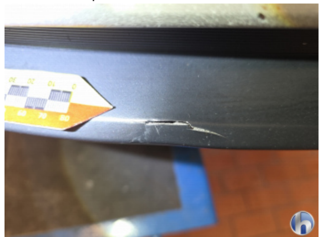
2. Frontspoiler Riss - Erneuern
