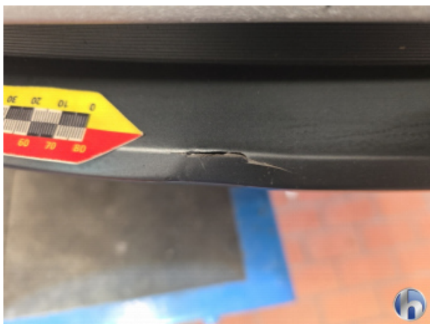
2. Frontspoiler Riss - Erneuern
