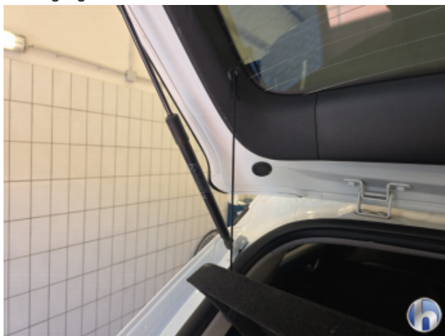
3. Hutablage Befestigung Schadhft - Erneuern
