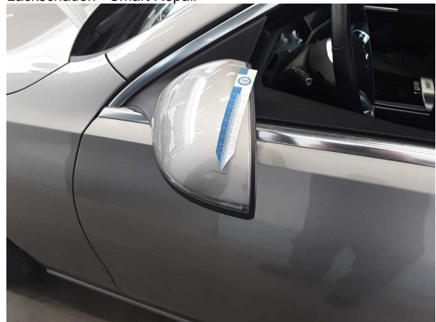
Beschädigung #2: Außenspiegel links: Abdeckkappe - Kratzer - lackieren
