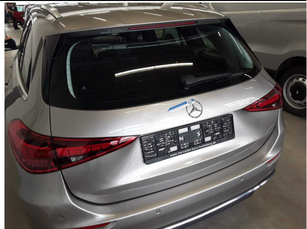
Beschädigung #6: Heckklappe/-tür: Heckklappe - Delle(n) - instandsetzen und lackieren
