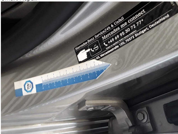
Beschädigung #1: Schweller links: Einstieg - Delle / Lackschade... Smart Repair
