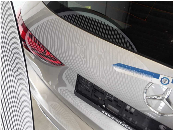
Beschädigung #6: Heckklappe/-tür: Heckklappe - Delle(n) - instandsetzen und lackieren
