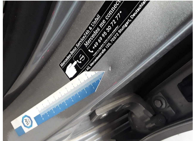
Beschädigung #1: Schweller links: Einstieg - Delle / Lackschaden - Smart Repair
