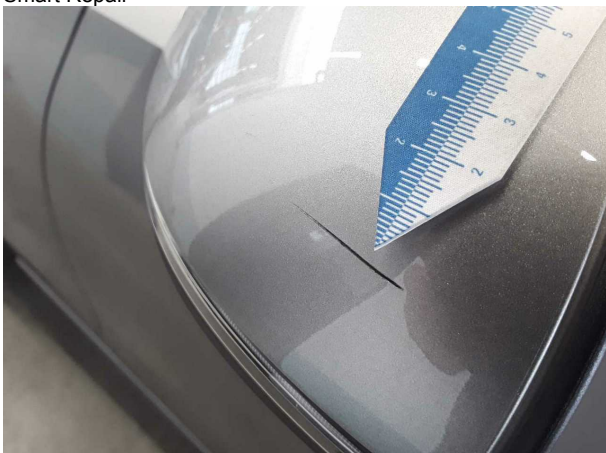
Beschädigung #2: Außenspiegel links: Abdeckkappe - Kratzer - lackieren
