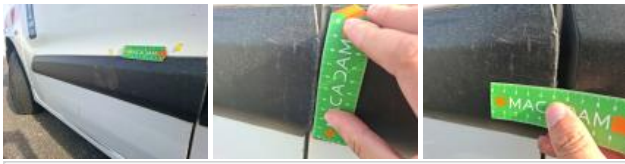
Door trim FL, Broken, Replace
