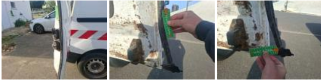
Boot door lining R, Broken, Replace
