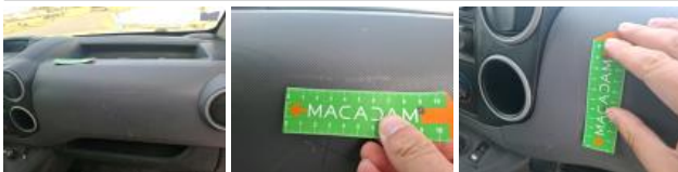
Door panel FR, Scratch(es), Replace
